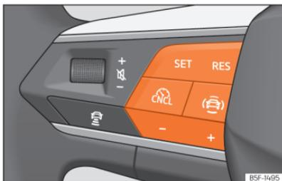
**Fig. 133** No volante multifunções: botões para utilizar o regulador de velocidade.
