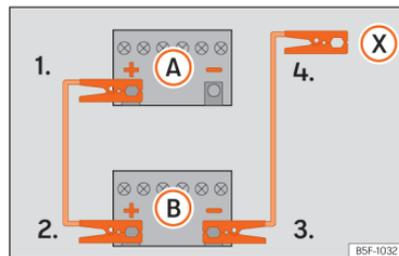
**Fig. 212** Esquema de ligação para veículos sem sistema Start Stop.
