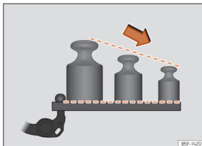
**Fig. 202** Distribuição recomendada do peso no sistema de carga traseiro.
