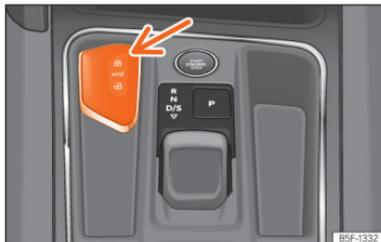
Fig. 69 Consola central (com caixa de velocidades automática): alojamento para a chave do veículo.
