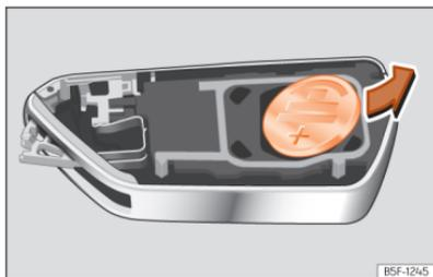
**Fig. 72** Chave do veículo: remoção da pilha.
