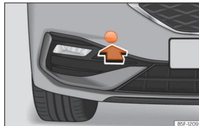
**Fig. 216** No lado direito do para-choques dianteiro: retirar a tampa.
