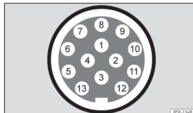
**Fig. 200** Representação esquemática: atribuição dos pinos da tomada de corrente para reboque.
