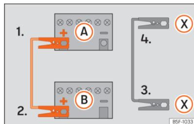
**Fig. 213** Esquema de ligação para veículos com sistema Start Stop.
