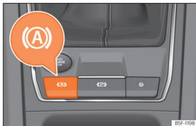
**Fig. 152** Na parte inferior da consola central: botão da função Auto Hold.
