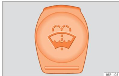
**Fig. 229** No compartimento do motor: tampa de cor azul do depósito do limpa-vidros.
