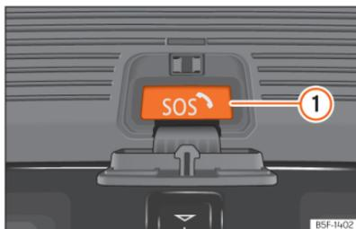
**Fig. 50** Botão para chamada de emergência.
