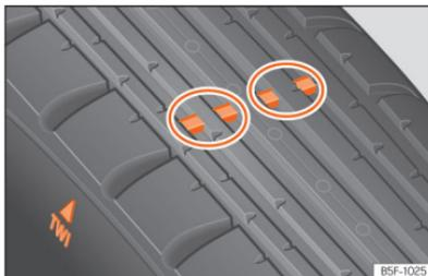
**Fig. 239** Perfil do pneu: indicadores de desgaste.
