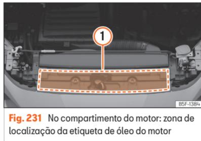
**Fig. 231** No compartimento do motor: zona de localização da etiqueta de óleo do motor
