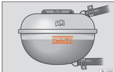
**Fig. 226** No compartimento dianteiro: marca no depósito de expansão do líquido de refrigeração.
