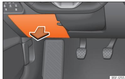
**Fig. 220** No painel de instrumentos do lado do condutor: tampa da caixa de fusíveis.
