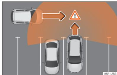
**Fig. 160** Representação esquemática do assistente de saída do estacionamento: zona vigiada ao redor do veículo que está a sair do estacionamento.
