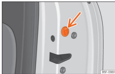
**Fig. 78** Trancagem de emergência da porta.
