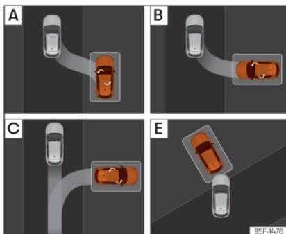
**Fig. 155** No ecrã do sistema infotainment: indicação dos modos de estacionamento.
