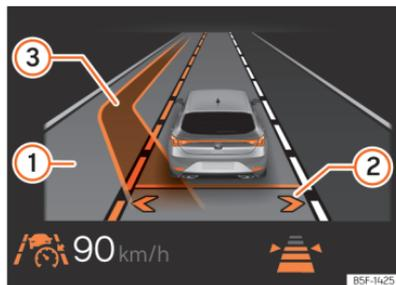
**Fig. 146** No ecrã do painel de instrumentos: visualização da mudança de faixa de rodagem assistida [representação esquemática].
