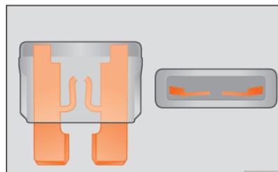
**Fig. 222** Representação de um fusível fundido.
