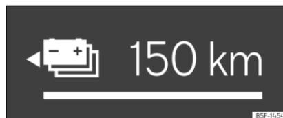
**Fig. 4** Painel de instrumentos digital: indicador do nível de bateria.
