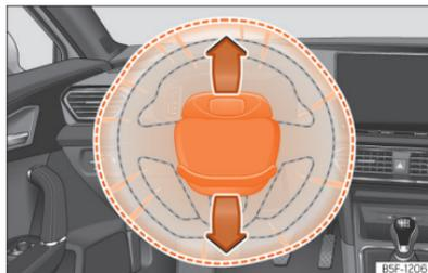
Fig. 26 Airbag do condutor no volante.
