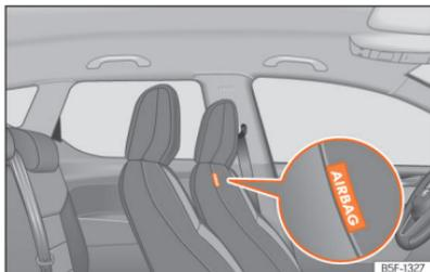
**Fig. 30** No estofo interior do encosto do banco do condutor: airbag central.
