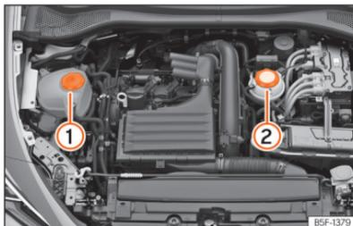
**Fig. 225** Compartimento do motor: Depósitos do líquido de refrigeração
