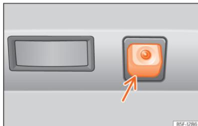
**Fig. 132** No para-choques traseiro: localização da câmara do assistente para marcha-atrás.
