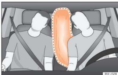
**Fig. 31** Airbag central ativado totalmente (raio de alcance).
