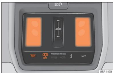
**Fig. 106** Pormenor do revestimento do tejadilho: iluminação dianteira do habitáculo.
