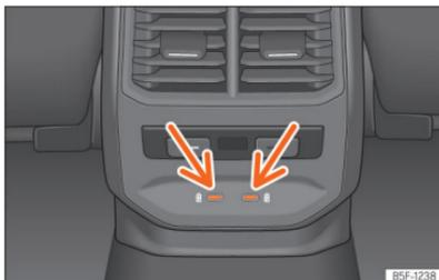
**Fig. 169** Parte posterior consola central: conectores USB com função de tomada de corrente.
