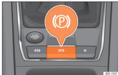
**Fig. 151** Na parte inferior da consola central: botão do travão de estacionamento eletrónico.
