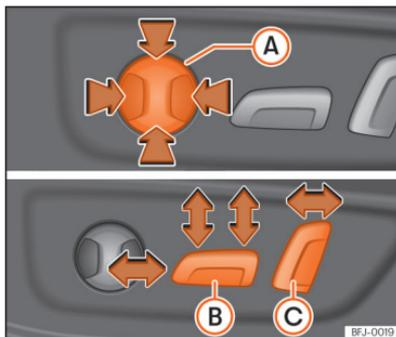
**Fig. 94** Banco do condutor: regular o banco eletricamente
