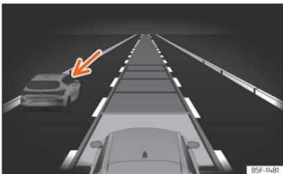
**Fig. 138** No ecrã do painel de instrumentos: ACC ativo, veículo detetado pela esquerda.
