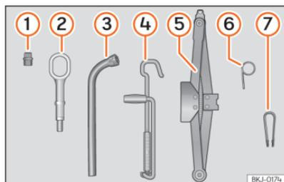
**Fig. 209** Na bagageira, debaixo da cobertura da superfície de carga: ferramentas de bordo.
