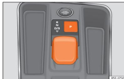
Fig. 124 Na consola central: comando seletor.
