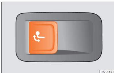
**Fig. 201** No lado esquerdo da bagageira: botão para desbloquear o gancho de reboque.
