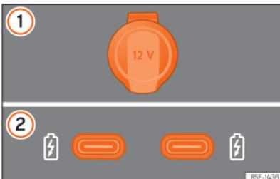
**Fig. 166** Tomadas de corrente de 12 Volts do veículo
