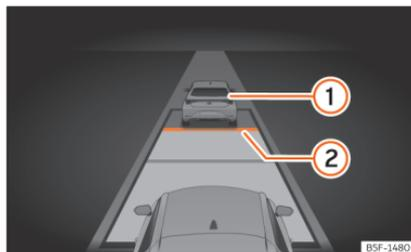
**Fig. 136** No ecrã do painel de instrumentos: ACC ativo.
