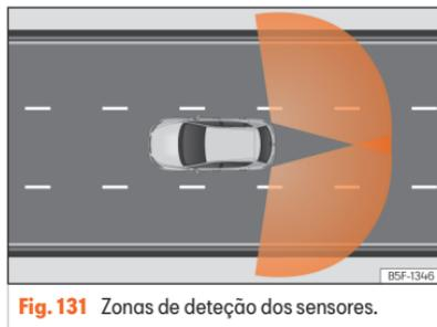
**Fig. 131** Zonas de deteção dos sensores.
