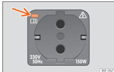
**Fig. 167** Na bagageira: tomada de corrente de 230 volts.
