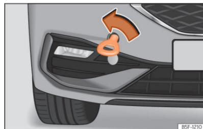
**Fig. 217** Parte direita do para-choques dianteiro: argola de reboque enroscada.
