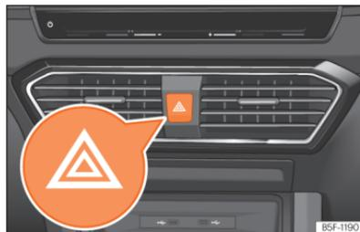
**Fig. 48** Painel de instrumentos: interruptor das luzes de emergência.
