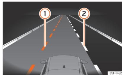
**Fig. 143** No ecrã do painel de instrumentos: indicações do sistema de aviso de saída da faixa de rodagem.
