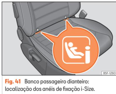
**Fig. 41** Banco passageiro dianteiro: localização dos anéis de fixação i-Size.
