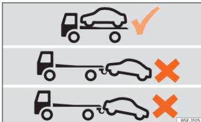
**Fig. 215** Transporte com grua: veículos com caixa de velocidades automática e tração total (4Drive).
