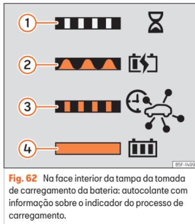
**Fig. 62** Na face interior da tampa da tomada de carregamento da bateria: autocolante com informação sobre o indicador do processo de carregamento.
