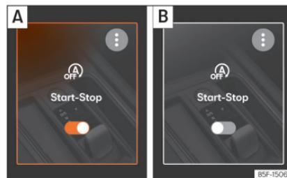
**Fig. 122** No sistema de infotainment: sistema Start-Stop (acessível a partir de diferentes menus do infotainment).
