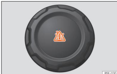
**Fig. 227** Compartimento dianteiro: tampão do depósito de expansão do líquido de refrigeração.
