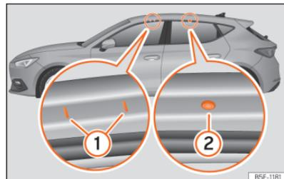
**Fig. 199** Pontos de fixação das barras transversais para o porta-bagagens no tejadilho (Leon).
