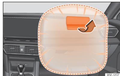
Fig. 27 Airbag do passageiro no painel de instrumentos.
