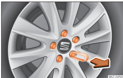
**Fig. 244** Roda: parafusos de roda com protetores.
