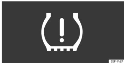
**Fig. 250** Painel de instrumentos: aviso de perda de pressão dos pneus.
