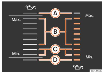
**Fig. 233** No ecrã do sistema de infotainment: possíveis visualizações do indicador do nível do óleo do motor.
