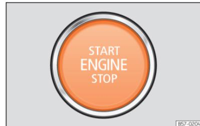
**Fig. 119** Na parte inferior da consola central: botão de arranque.
