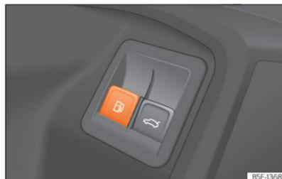
**Fig. 206** Porta do condutor: desbloqueio da tampa do depósito.
