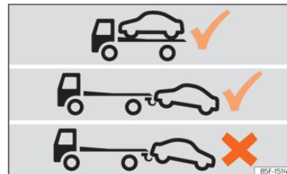
**Fig. 214** Transporte com grua: veículos com caixa de velocidades automática e tração dianteira.
