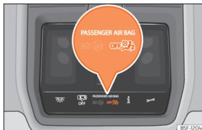
**Fig. 29** Na consola do tejadilho: luz de controlo da desativação do airbag do passageiro.
