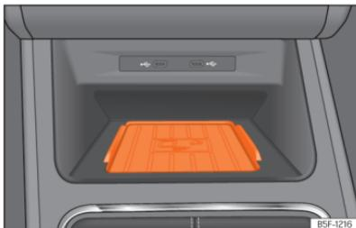
**Fig. 176** Na consola central: alojamento para a ligação do telemóvel.
