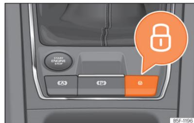
**Fig. 76** Na consola central: botão do fecho centralizado.
