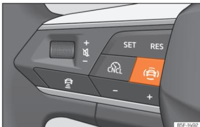
**Fig. 126** Lado esquerdo do volante multifunções: botão para os sistemas de assistência à condução (conforme versões).
