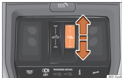
**Fig. 89** No revestimento interior do teto: manusear a cortina de proteção contra o sol.
