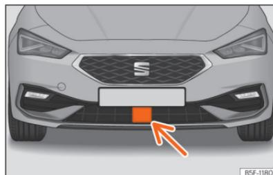
**Fig. 127** No para-choques dianteiro: sensor de radar.
