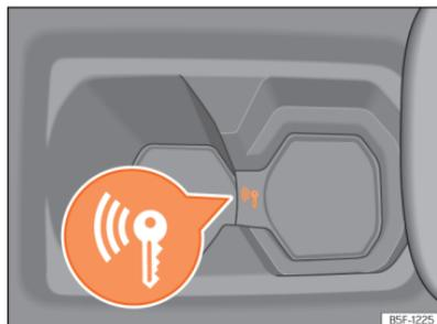
**Fig. 120** Na consola central: arranque de emergência.
