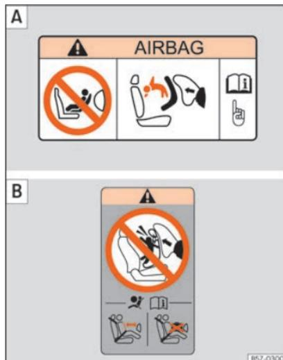
**Fig. 35** Autocolantes do airbag: na pala do sol do lado do passageiro [A] e na moldura posterior da porta do passageiro [B].
