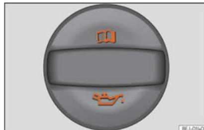
**Fig. 60** Tampão do bocal de enchimento do óleo do motor no compartimento do motor.
