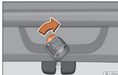
**Fig. 11** Pormenor da bagageira: destrancagem de emergência.
