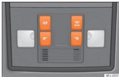
**Fig. 46** Pormenor do revestimento do tejadilho: iluminação dianteira do habitáculo.
