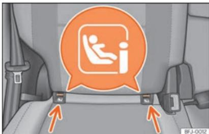
**Fig. 37** Bancos laterais da segunda fila: anéis de fixação ISOFIX/i-Size.
