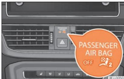
**Fig. 96** Painel de instrumentos: luz de controlo da desativação do airbag do passageiro.
