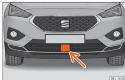
**Fig. 264** No para-choques dianteiro: sensor de radar.
