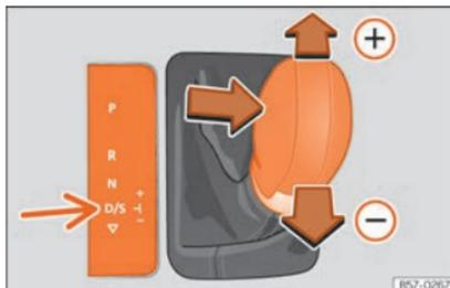
**Fig. 248** Consola central: mudar velocidades com tiptronic.
