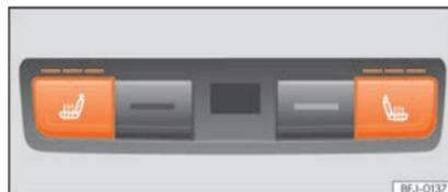
**Fig. 189** Na parte traseira da consola central: comandos para o aquecimento dos bancos traseiros.
