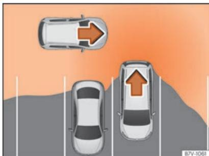
**Fig. 277** Representação esquemática do assistente de saída do estacionamento: zona vigiada ao redor do veículo que está a sair do estacionamento.
