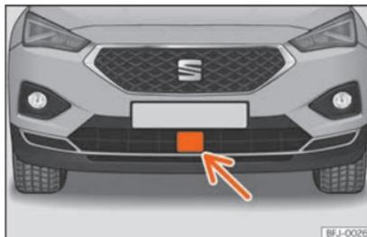
**Fig. 259** No para-choques dianteiro: sensor de radar.
