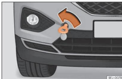
**Fig. 99** No lado direito do para-choques dianteiro: argola de reboque enroscada.
