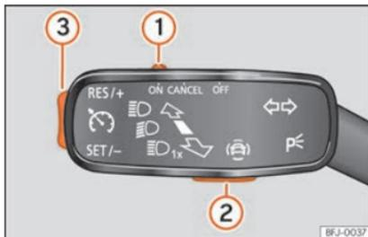
**Fig. 255** À esquerda da coluna da direção: comando e botões para controlar o limitador de velocidade.
