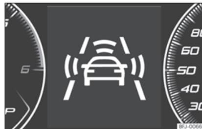
**Fig. 258** No ecrã do painel de instrumentos: indicações de pré-aviso.
