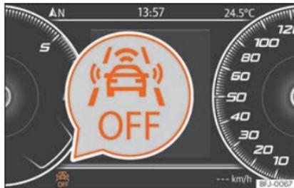
**Fig. 260** No ecrã do painel de instrumentos: indicação de Front Assist desativado.
