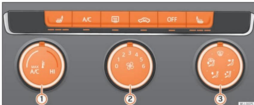
**Fig. 58** Na consola central: comandos do ar condicionado manual.
