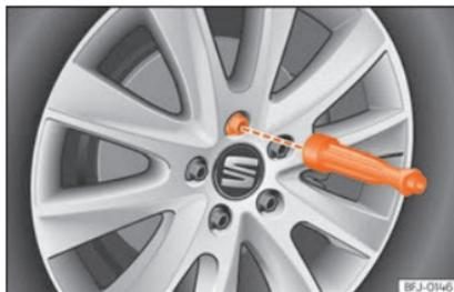
**Fig. 78** Roda: desenrosque os parafusos de roda com o cabo da chave de parafusos.
