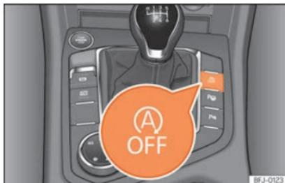
**Fig. 250** Consola central: botão do sistema Start-Stop.
