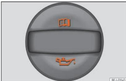
Fig. 305 Tampa do bocal de enchimento do óleo do motor no compartimento do motor.
