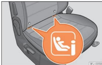
**Fig. 38** Banco passageiro dianteiro: anéis de fixação ISOFIX.
