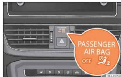
**Fig. 29** Painel de instrumentos: luz de controlo da desativação do airbag do passageiro.
