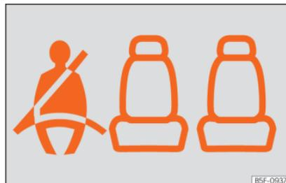
**Fig. 88** Painel de instrumentos: indicação de lugar posterior esquerdo ocupado e cinto de segurança correspondente apertado.
