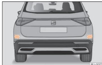
**Fig. 274** Vista traseira do veículo: zonas dos sensores de radar.
