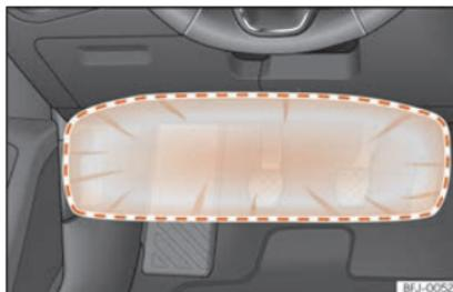
**Fig. 31** No lado do condutor: raio de ação do airbag dos joelhos.
