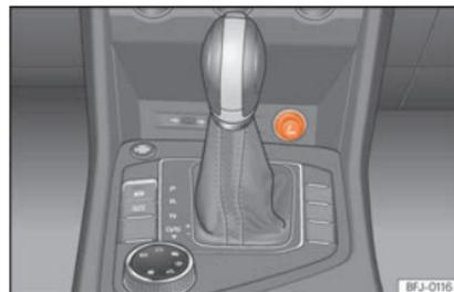
**Fig. 182** Na parte inferior da consola central: isqueiro.
