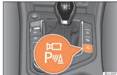
**Fig. 292** Consola central: tecla para ativar/desativar manualmente o sistema de visão periférica quando está em combinação com o sistema de estacionamento assistido ou com o sistema Park Pilot traseiro .
