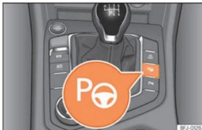
**Fig. 279** Na parte superior da consola central: botão para ligar o sistema de estacionamento assistido.
