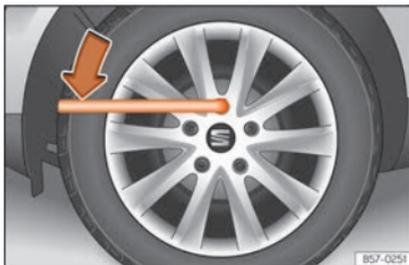
**Fig. 75** Roda: desapertar os parafusos de roda.
