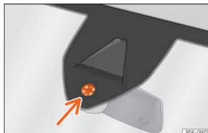
**Fig. 138** Superfície sensível do sensor de chuva.
