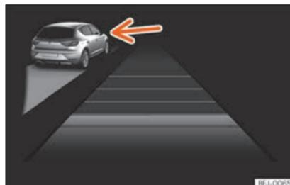
**Fig. 267** No ecrã do painel de instrumentos: ACC ativo, veículo detetado pela esquerda
