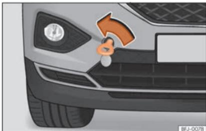
**Fig. 79** Parte direita do para-choques dianteiro: argola de reboque enroscada.
