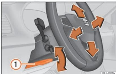
**Fig. 24** Alavanca na parte inferior do lado esquerdo da coluna de direção
