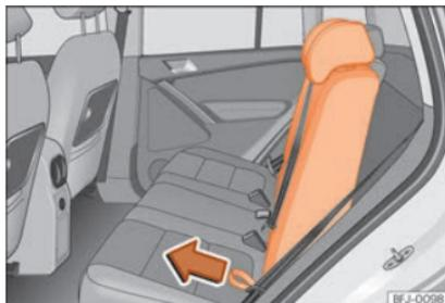
**Fig. 155** Rebater e levantar o encosto do banco traseiro.
