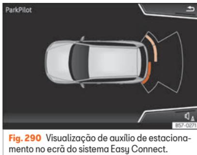
**Fig. 290** Visualização de auxílio de estacionamento no ecrã do sistema Easy Connect.
