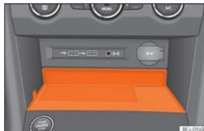
**Fig. 242** Na consola central: alojamento para a ligação do telemóvel.
