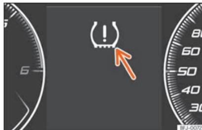
Fig. 309 Painel de instrumentos: aviso de perda de pressão dos pneus.
