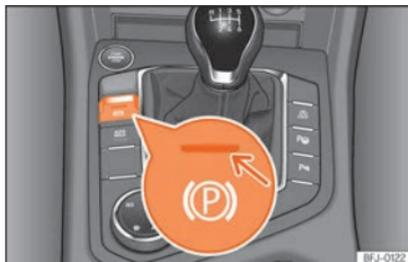
**Fig. 246** Na parte inferior da consola central: botão do travão de estacionamento eletrónico.
