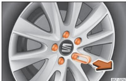
Fig. 73 Roda: parafusos de roda com protetores.
