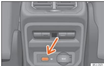
**Fig. 240** Parte posterior consola central: conectores USB.
