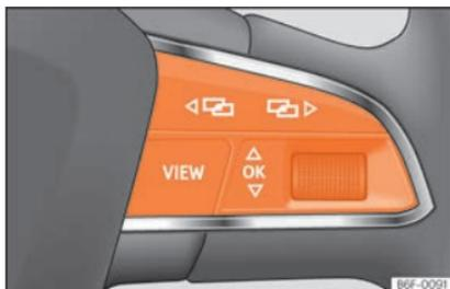
**Fig. 114** Lado direito do volante multifunções: botões para utilizar os menus e as indicações informativas do painel de instrumentos.
