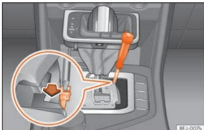
**Fig. 55** Alavanca seletora: desbloqueio de emergência na posição de estacionamento.
