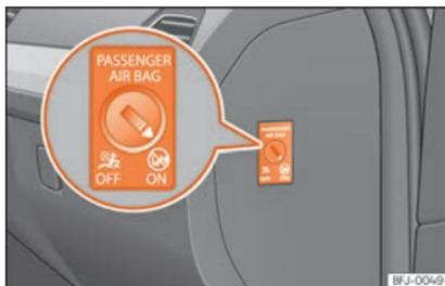
**Fig. 95** Computador com chave para ativar e desativar o airbag do passageiro.
