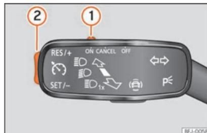
**Fig. 52** À esquerda da coluna da direção: interruptor e comandos de utilização do GRA.
