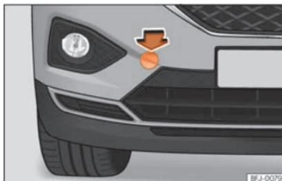
**Fig. 98** No lado direito do para-choques dianteiro: retirar a tampa.
