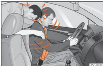
**Fig. 91** O passageiro do banco traseiro que não tiver colocado o cinto de segurança é projetado para a frente, para cima do condutor que tem o cinto colocado.
