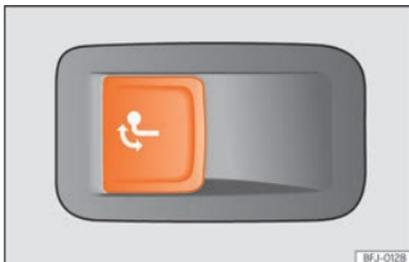
**Fig. 297** No lado esquerdo da bagageira: botão para desbloquear o engate de bola.
