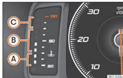
Fig. 113 Indicador de temperatura do líquido de refrigeração do motor.
