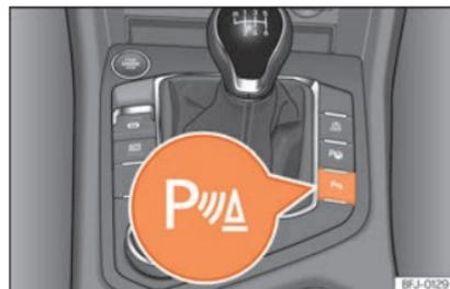
**Fig. 286** Consola central: botão de auxílio de estacionamento.
