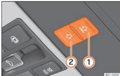
**Fig. 129** No revestimento interior do teto: botões da cortina para o sol.
