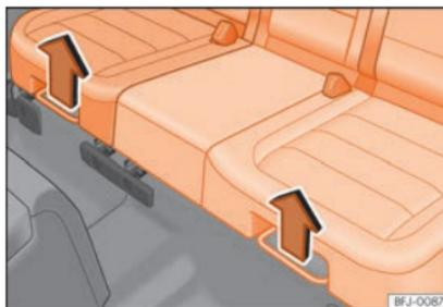
**Fig. 140** Por baixo do assento do banco traseiro: alavancas de ajuste.
