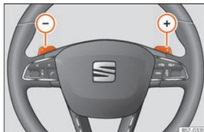
**Fig. 249** Volante: alavancas para mudança automática de velocidades.
