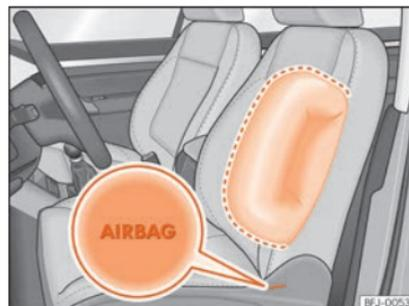
**Fig. 32** Airbag lateral no banco do condutor.
