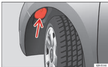
Fig. 149 Substituição da lâmpada dos médios: cava das rodas
