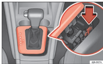
Fig. 108 Desbloqueio de emergência da alavanca de selecção
