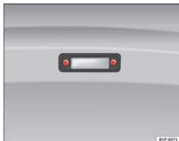
Fig. 165 Desmontagem da iluminação da placa da matrícula
