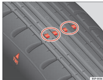
Fig. 124 Perfil dos pneus com indicadores de desgaste
