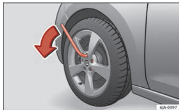
Fig. 131 Mudança de roda: Desapertar os parafusos da roda ▶
