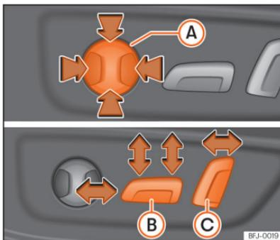
**Fig. 70** Banco do condutor: regular o banco eletricamente
