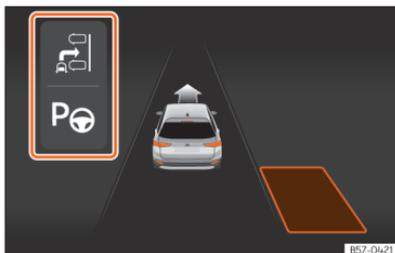
**Fig. 139** No ecrã do painel de instrumentos: visualização do sistema de estacionamento assistido com visualização reduzida.
