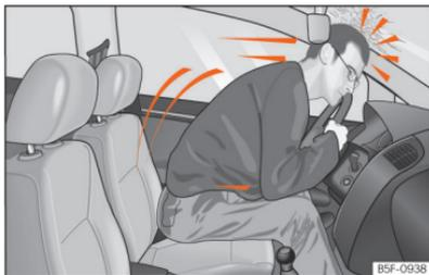
**Fig. 18** O condutor que não tiver colocado o cinto de segurança será projetado para a frente.
