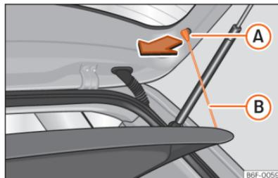
**Fig. 167** Na bagageira: desmontar e montar a chapeleira.
