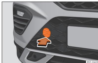
**Fig. 197** No lado direito do para-choques dianteiro: retirar a tampa.
