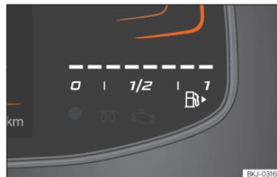
**Fig. 3** Painel de instrumentos Basic: indicador do nível de combustível.
