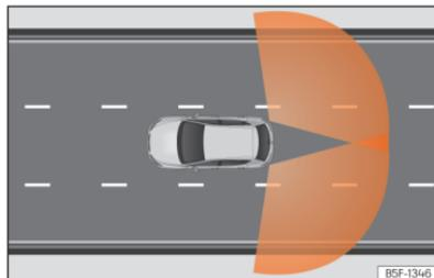
**Fig. 109** Zonas de deteção dos sensores.
