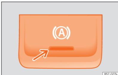
**Fig. 132** Na parte inferior da consola central: botão da função Auto Hold.
