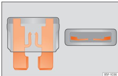
**Fig. 204** Representação de um fusível fundido.
