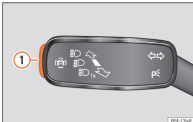
**Fig. 103** Na alavanca das luzes indicadoras de mudança de direção e dos máximos: botão dos sistemas de assistência ao condutor [conforme versões].
