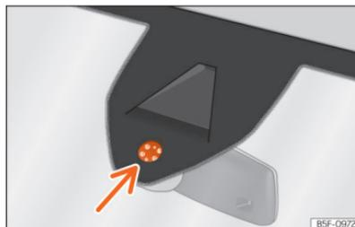
**Fig. 91** Sensor de humidade e temperatura do para-brisas.
