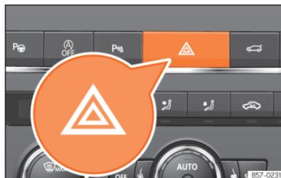
**Fig. 41** Painel de instrumentos: interruptor das luzes de emergência.
