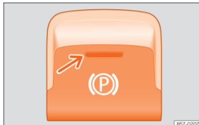
**Fig. 131** Na parte inferior da consola central: botão do travão de estacionamento eletrónico.
