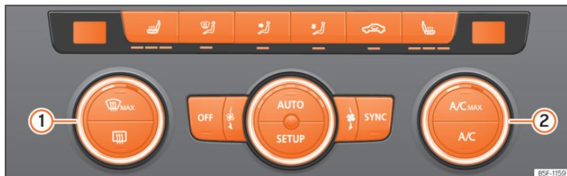
**Fig. 89** Na consola central: comandos do Climatronic.
