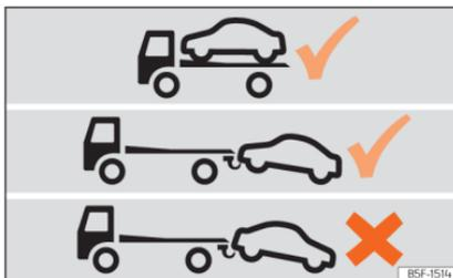
**Fig. 195** Transporte com grua: veículos com caixa de velocidades automática e tração dianteira.
