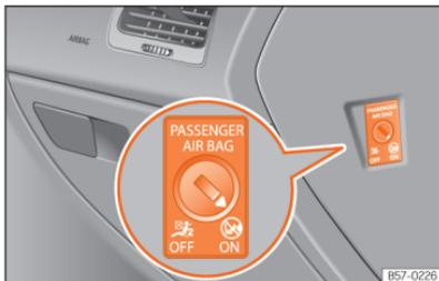
**Fig. 26** Computador com chave para ativar e desativar o airbag do passageiro.
