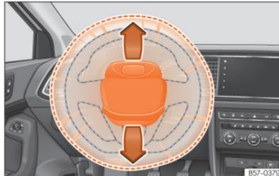
**Fig. 24** Airbag do condutor no volante.
