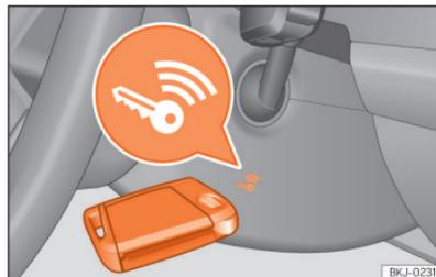
**Fig. 95** À direita da coluna de direção: arranque de emergência.
