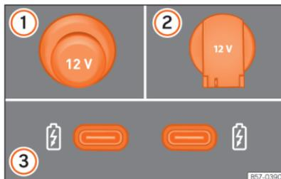
**Fig. 156** Tomadas de corrente de 12 Volts do veículo
