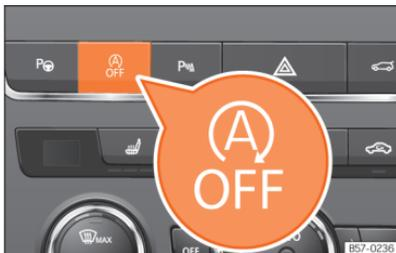
**Fig. 96** Consola central: botão do sistema Start-Stop.
