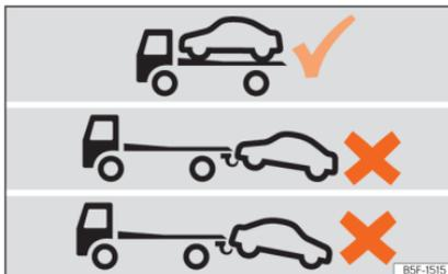
**Fig. 196** Transporte com grua: veículos com caixa de velocidades automática e tração total (4Drive).
