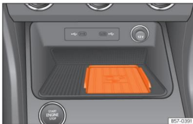
**Fig. 166** Na consola central: alojamento para a ligação do telemóvel.
