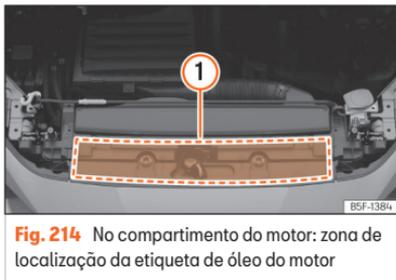
**Fig. 214** No compartimento do motor: zona de localização da etiqueta de óleo do motor
