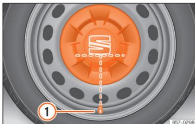
**Fig. 223** Colocação correta do tampão central da roda para jantes de aço.
