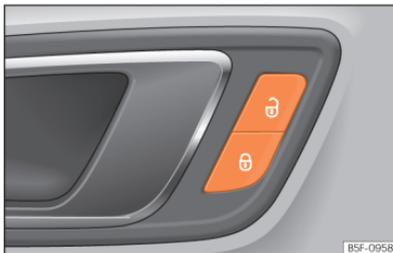
**Fig. 51** Na porta do condutor: botão do fecho centralizado.
