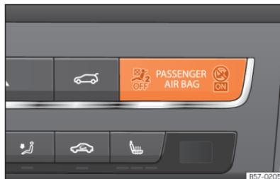
**Fig. 27** Painel de instrumentos: luz de controlo da desativação do airbag do passageiro.
