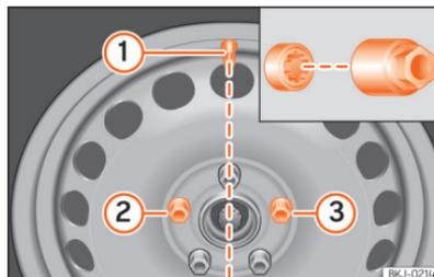
**Fig. 227** Troca de roda: válvula do pneu (1) e local de montagem do parafuso da roda antirroubo (2) ou (3).
