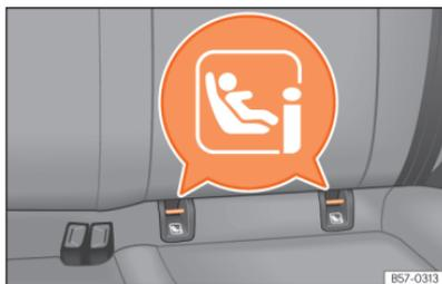
**Fig. 36** Banco traseiro: localização dos anéis de fixação ISOFIX ou i-Size.
