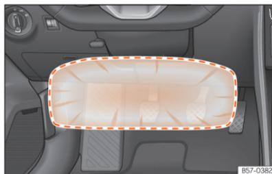
**Fig. 32** No lado do condutor: raio de ação do airbag dos joelhos.
