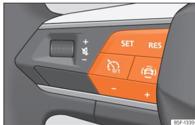
**Fig. 112** No volante multifunções: botões para utilizar o limitador de velocidade.
