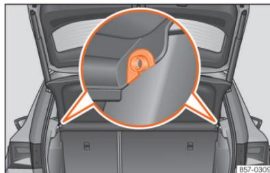
**Fig. 168** Na bagageira: desmontar e montar a chapeleira.
