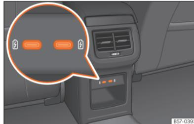
**Fig. 159** Parte posterior consola central: conectores USB com função de tomada de corrente.
