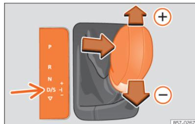
Fig. 99 Alavanca seletora na posição Tiptronic
