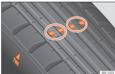
**Fig. 219** Perfil do pneu: indicadores de desgaste.
