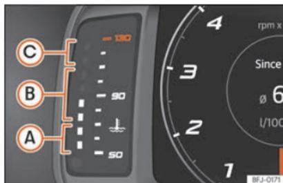
**Fig. 63** Painel de instrumentos digital: indicador da temperatura do líquido de refrigeração do motor
