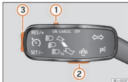
**Fig. 254** No manípulo dos indicadores de mudança de direção: botões para utilizar o limitador de velocidade.
