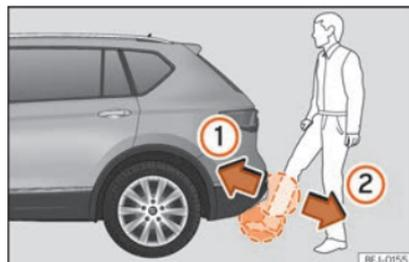
**Fig. 87** Porta da bagageira com abertura controlada por sensor (Easy Open)
