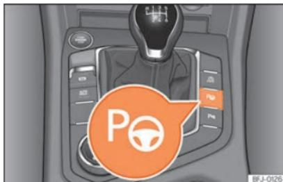
**Fig. 281** Na parte inferior da consola central: botão para ligar o sistema de estacionamento assistido.
