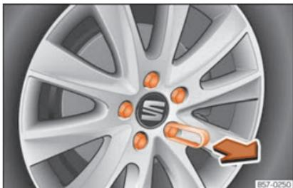
**Fig. 36** Roda: parafusos da roda com protetores.
