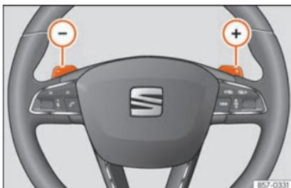
**Fig. 247** Volante: alavancas de mudança automática de velocidade.
