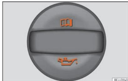
**Fig. 314** Tampão do bocal de enchimento do óleo do motor no compartimento do motor.
