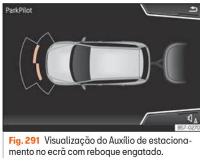
**Fig. 291** Visualização do Auxílio de estacionamento no ecrã com reboque engatado.
