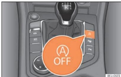
**Fig. 243** Consola central: botão do sistema Start/Stop.
