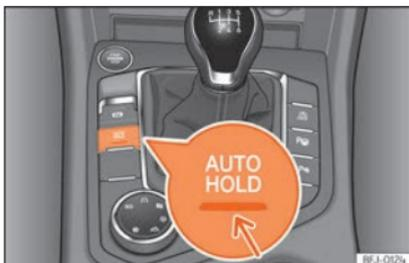
**Fig. 280** Na parte inferior da consola central: tecla da função Auto Hold.
