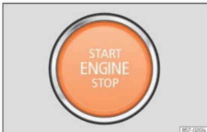
**Fig. 240** Na parte inferior da consola central: botão de arranque.
