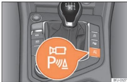
**Fig. 296** Consola central: botão para ativar/desativar manualmente o sistema de visão periférica quando está em combinação com o sistema de estacionamento assistido.
