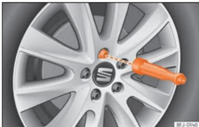
**Fig. 42** Substituição da roda: desenroskar os parafusos de roda com o cabo da chave de parafusos.
