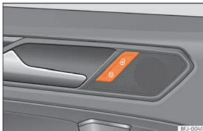
**Fig. 76** Porta do condutor: interruptor do fecho centralizado.
