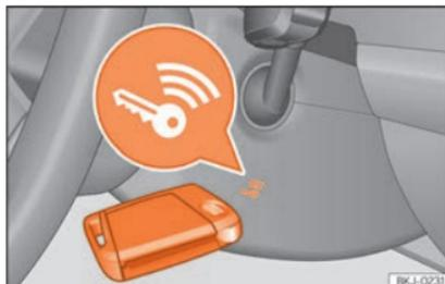
**Fig. 241** À direita da coluna de direção: arranque de emergência.
