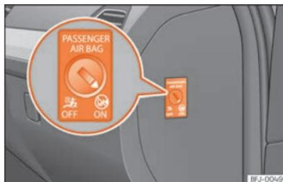
Fig. 18 Comutador com chave para ativar e desativar o airbag do passageiro.
