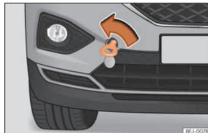
**Fig. 49** No lado direito do para-choques dianteiro: argola de reboque enroscada.
