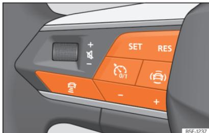
**Fig. 6** No volante multifunções: botões para utilizar o ACC
