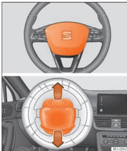
**Fig. 16** Airbag do condutor no volante.
