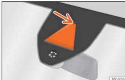
**Fig. 270** No para-brisas: área de campo visual do sistema de aviso de saída da faixa de rodagem.
