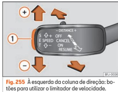
Fig. 255 À esquerda da coluna de direção: botões para utilizar o limitador de velocidade.
