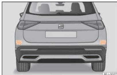
O assistente de ângulo morto vigia a zona situada atrás do veículo através de sensores de radar »» Fig. 274. Para isso, o sistema mede a distância e a diferença de velocidade relativamente aos outros veículos. O assistente de ângulo morto não funciona a velocidades inferiores a aprox. 15 km/h [9 mph]. O sistema informa o condutor através de sinais óticos nos espelhos dos retrovisores exteriores.
