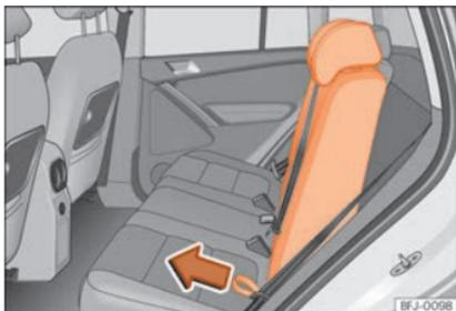
**Fig. 119** Rebater e levantar o encosto do banco traseiro.
