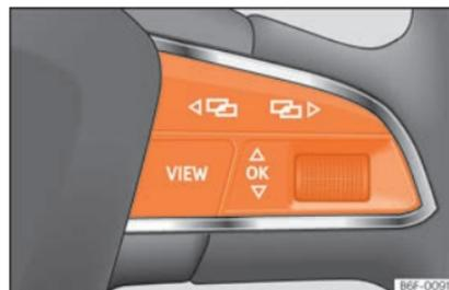
**Fig. 64** Lado direito do volante multifunções: botões para utilizar os menus e as indicações informativas do painel de instrumentos. »
