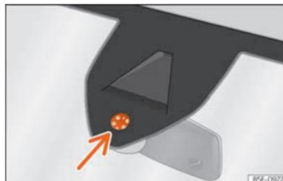
Fig. 103 Superfície sensível do sensor de chuva.
