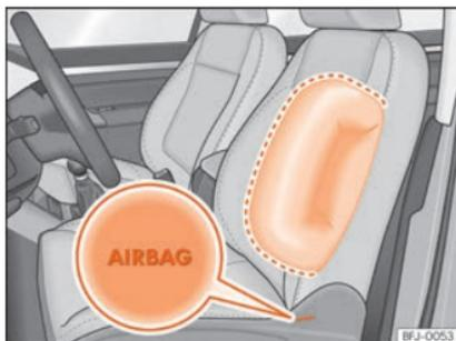
Fig. 22 Airbag lateral no banco do condutor.
