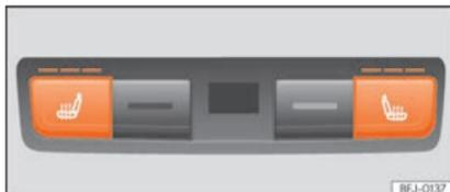
**Fig. 158** Na parte traseira da consola central: comandos para o aquecimento dos bancos traseiros.
