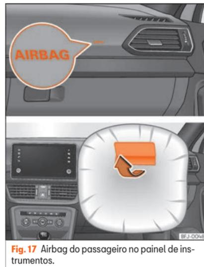
**Fig. 17** Airbag do passageiro no painel de instrumentos.
