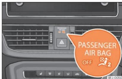
Fig. 19 Painel de instrumentos: luz de controlo da desativação do airbag do passageiro.
