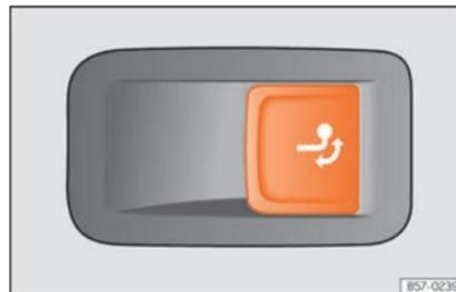
**Fig. 303** No lado direito da bagageira: botão para desbloquear o gancho de reboque.
