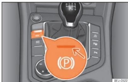
**Fig. 278** Na parte inferior da consola central: tecla do travão de estacionamento eletrónico.
