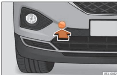
**Fig. 48** No lado direito do para-choques dianteiro: retirar a tampa.
