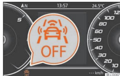
**Fig. 259** No ecrã do painel de instrumentos: indicação de Front Assist desativado.
