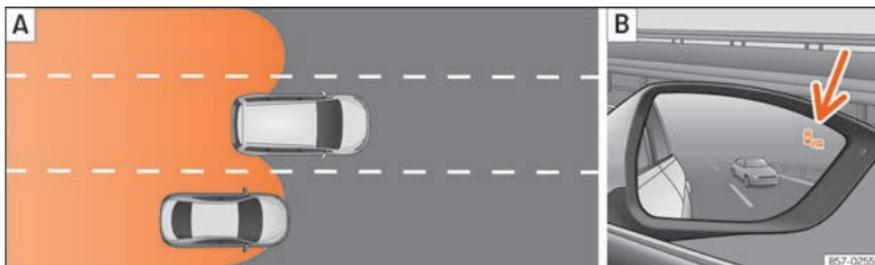
**Fig. 276** Esquema: **A** Situação numa ultrapassagem e incorporação posterior na via de circulação direita. **B** Indicação do assistente de ângulo morto no retrovisor exterior direito.
