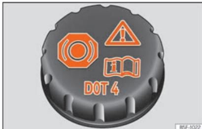
**Fig. 317** Compartimento do motor: tampão do depósito do líquido dos travões.
