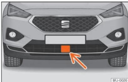
**Fig. 258** No para-choques dianteiro: sensor de radar.
