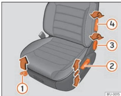
**Fig. 107** Bancos dianteiros: ajuste manual do banco.
