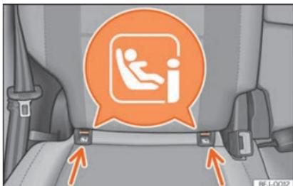
**Fig. 28** Bancos laterais da segunda fila: anéis de fixação ISOFIX/i-Size.
