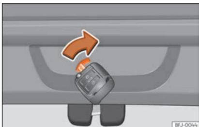
**Fig. 88** Pormenor da bagageira: destrancagem de emergência.
