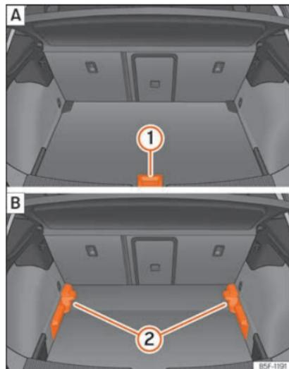
**Fig. 129** Piso variável da bagageira: **(A)** posição alta; **(B)** posição baixa.
