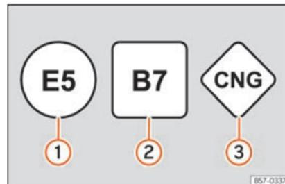
**Fig. 219** Identificação dos combustíveis em conformidade com a Diretiva 2014/94/UE do Parlamento Europeu e do Conselho
