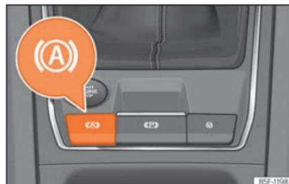
**Fig. 196** Na parte inferior da consola central: tecla da função Auto Hold.
