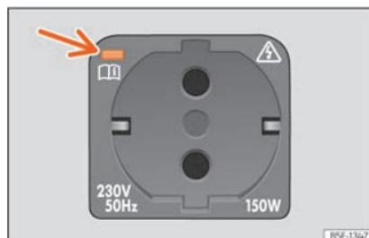
**Fig. 148** Na bagageira: tomada de corrente de 230 Volts.
