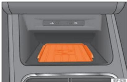
**Fig. 158** Na consola central: alojamento para a ligação do telemóvel.
