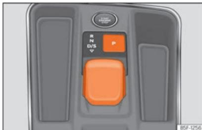
**Fig. 165** Na consola central: comando seletor.
