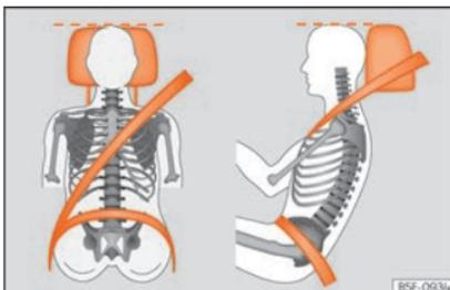
**Fig. 16** Faixa do cinto de segurança e do encosto de cabeça regulados corretamente, vistos de frente e de lado.
