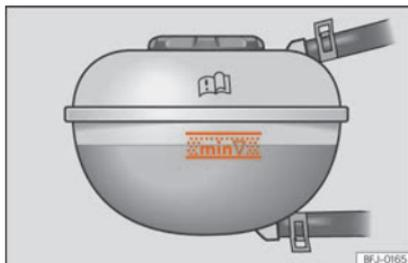
**Fig. 227** No compartimento do motor: marca no depósito de expansão do líquido de refrigeração.
