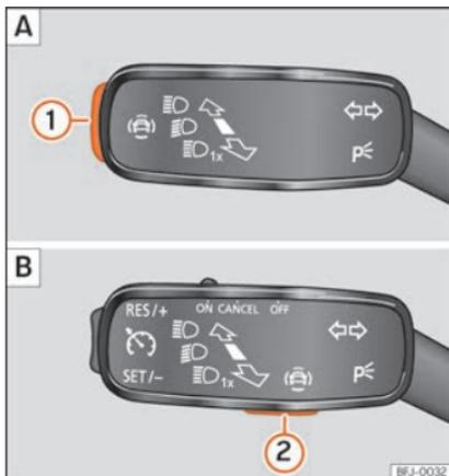
**Fig. 72** No manípulo dos indicadores de mudança de direção e dos máximos; botão para os sistemas de assistência à condução [conforme versão].
