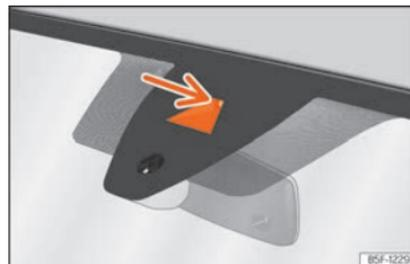
**Fig. 169** No para-brisas: área de campo visual do sistema de aviso de saída da faixa de rodagem.
