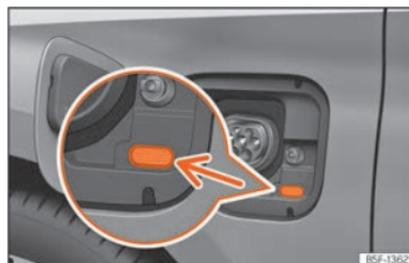
**Fig. 211** Por trás da tampa da tomada de carregamento da bateria: indicador do processo de carregamento. »
