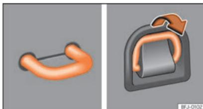
**Fig. 131** Na bagageira: argolas de fixação fixas e desdobráveis.
