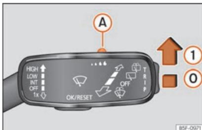
**Fig. 107** Manipulo do limpavidros: ajustar o sensor de chuva (A).
