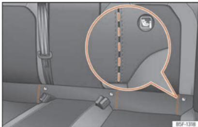
**Fig. 32** Bancos traseiros: ranhuras recortadas para aceder aos anéis de fixação ISOFIX/i-Size.
