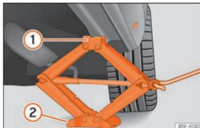
Fig. 46 Longarina: colocação do macaco do veículo.
