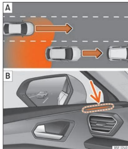
**Fig. 190** Esquema: [A] Situação numa ultrapassagem com trânsito na parte traseira. [B] Indicação do assistente de mudança de faixa na luz de controlo do lado esquerdo.
