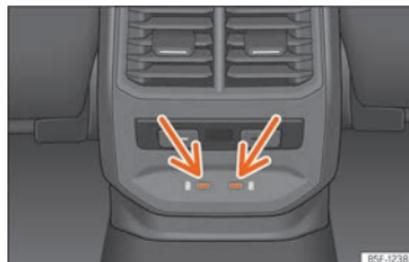
Fig. 160 Parte posterior consola central: Conectores USB com função de tomada de corrente.
