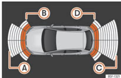
**Fig. 202** Visualização do auxiliar de estacionamento no ecrã do sistema Infotainment.
