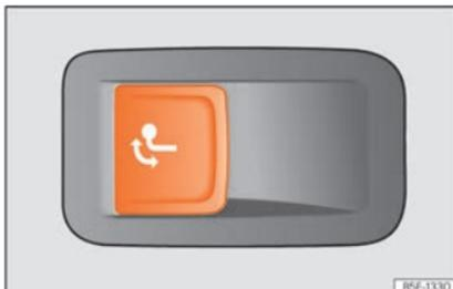
**Fig. 206** No lado esquerdo da bagageira: botão para desbloquear o gancho de reboque.
