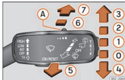
**Fig. 106** Utilização do limpa para-brisas e do limpa-vidros traseiro.
