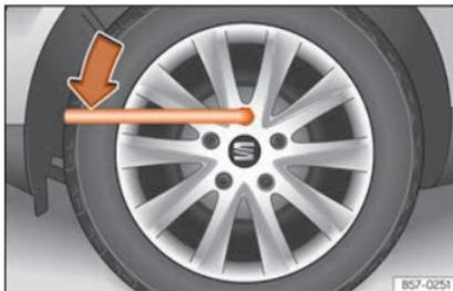
**Fig. 43** Substituição da roda: desapertar os parafusos da roda.
