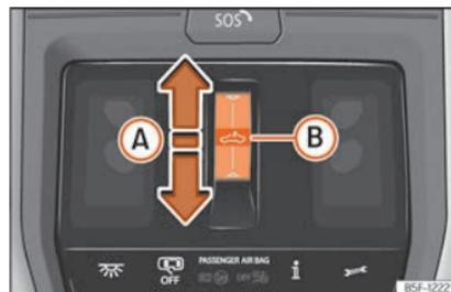
**Fig. 99** No revestimento interior do teto: botão do teto de vidro.
