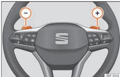
**Fig. 166** Volante: alavancas de mudança automática de velocidade.
