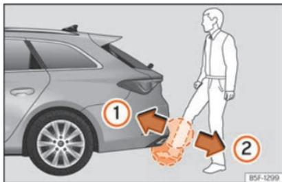
**Fig. 95** Porta da bagageira com abertura controlada por sensor (Easy Open)
