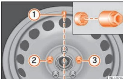
**Fig. 44** Substituição da roda: válvula do pneu (1) e local de montagem do parafuso de roda antirroubo (2) ou (3).
