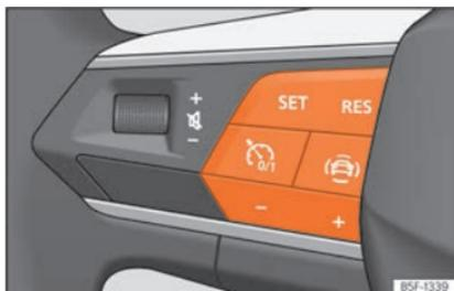
**Fig. 173** No volante multifunções: botões para utilizar o regulador de velocidade
