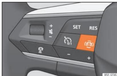
**Fig. 73** Lado esquerdo do volante multifunções: botão para os sistemas de assistência à condução [conforme versão].
