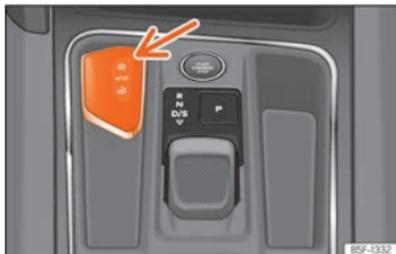
Fig. 81 Consola central: alojamento para a chave do veículo.
