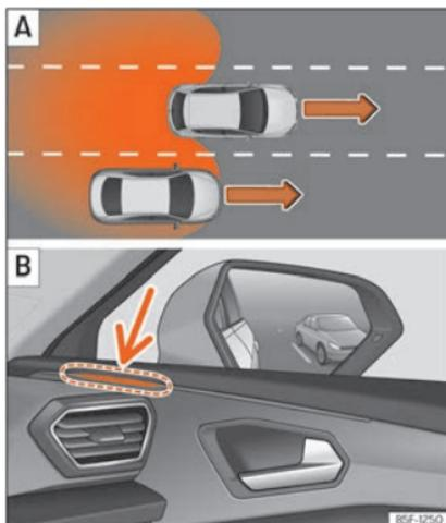
**Fig. 191** Esquema: **A** Situação numa ultrapassagem na faixa de rodagem central e incorporação posterior na faixa de rodagem direita. **B** Indicação do assistente de mudança de faixa na luz de controlo do lado direito.
