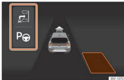
**Fig. 197** No ecrã do painel de instrumentos: visualização do sistema de estacionamento assistido com visualização reduzida.
