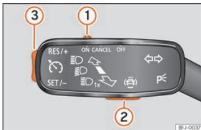
**Fig. 175** No manípulo dos indicadores de mudança de direção: botões para utilizar o limitador de velocidade.
