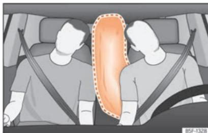
Fig. 25 Airbag central ativado totalmente (raio de alcance).
