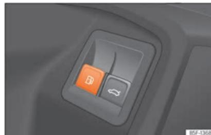
**Fig. 217** Porta do condutor: desbloqueio da tampa do depósito
