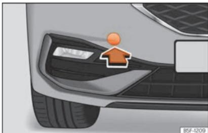
**Fig. 51** No lado direito do para-choques dianteiro: retirar a tampa.
