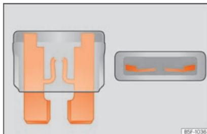
**Fig. 57** Representação de um fusível fundido.
