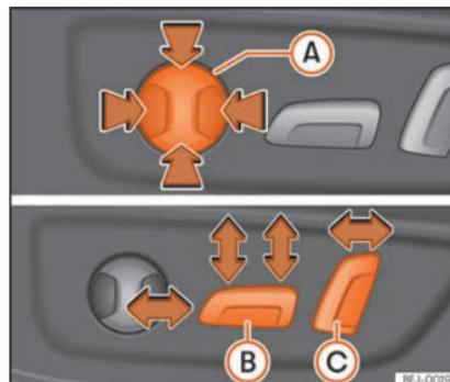
Fig. 112 Banco do condutor: ajuste elétrico do banco.
