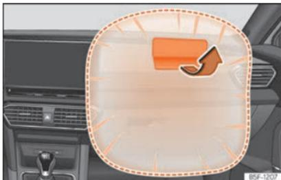
Fig. 19 Airbag do passageiro no painel de instrumentos.
