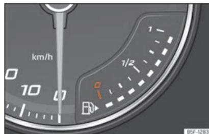
**Fig. 67** Painel de instrumentos analógico: indicador do nível de combustível
