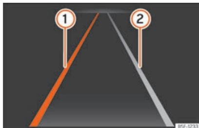
**Fig. 184** No ecrã do painel de instrumentos: indicações do sistema de aviso de saída da faixa de rodagem.
