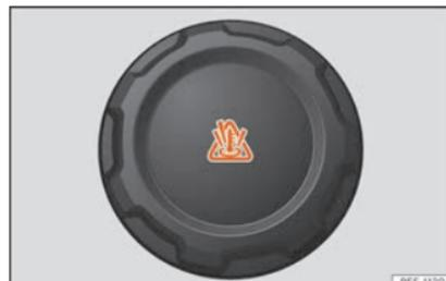
**Fig. 228** Compartimento do motor: tampa do depósito de compensação do líquido de refrigeração.
