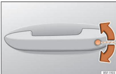
**Fig. 89** Manipulo da porta do condutor: canhão da fechadura.
