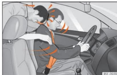
**Fig. 13** O passageiro do banco traseiro que não tiver colocado o cinto de segurança é projetado para a frente, para cima do condutor que tem o cinto colocado.
