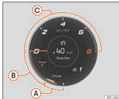
**Fig. 65** Painel de instrumentos digital: Powermeter
