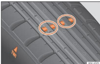
**Fig. 235** Perfil do pneu: indicadores de desgaste.
