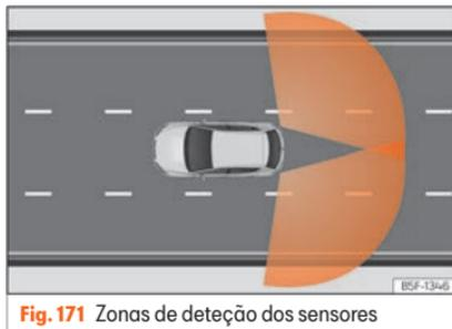
Fig. 171 Zonas de deteção dos sensores
