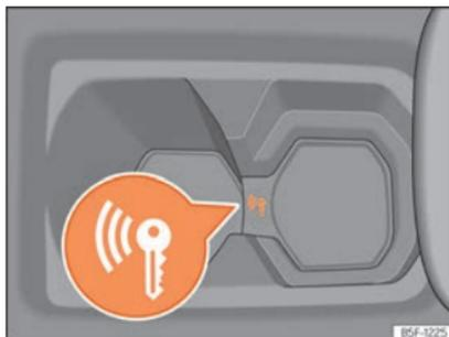
**Fig. 162** Na consola central: arranque de emergência.
