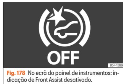
Fig. 178 No ecrã do painel de instrumentos: indicação de Front Assist desativado.
