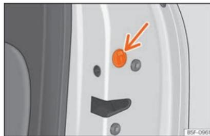
**Fig. 90** Trancagem de emergência da porta.
