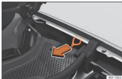
**Fig. 213** Entre a lateral esquerda e a dobradiça do capô do motor: Puxador para o desbloqueio manual de emergência do conector de carregamento.
