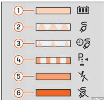
**Fig. 212** Na parte interior da tampa da tomada de carregamento da bateria: autocolante com informação sobre o indicador do processo de carregamento.
