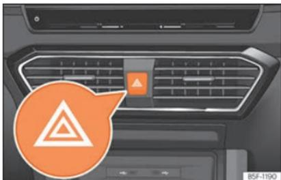
**Fig. 103** Painel de instrumentos: interruptor das luzes de emergência
