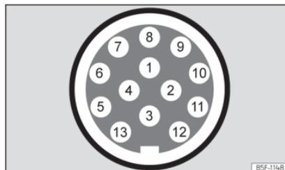
**Fig. 205** Esquema: atribuição dos pinos da tomada de corrente para reboque.
