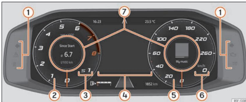
**Fig. 60** Veículos com propulsão convencional: SEAT Digital Cockpit no painel de instrumentos (vista clássica).
