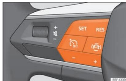
**Fig. 174** No volante multifunções: botões para utilizar o limitador de velocidade
