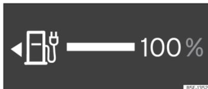
**Fig. 66** Painel de instrumentos digital: indicador do nível de bateria.
