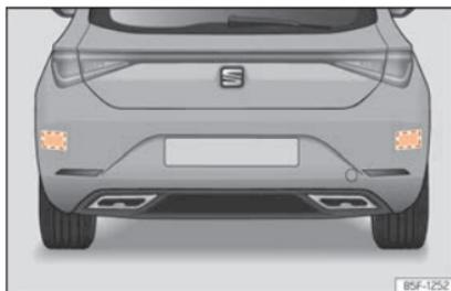
Fig. 170 Vista traseira do veículo: zonas dos sensores de radar.
