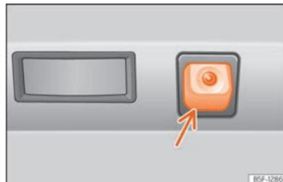
**Fig. 172** No para-choques traseiro: localização da câmara do assistente de marcha-atrás.
