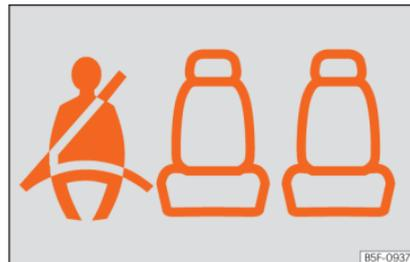
**Fig. 10** Painel de instrumentos: indicação de lugar posterior esquerdo ocupado e cinto de segurança correspondente apertado.
