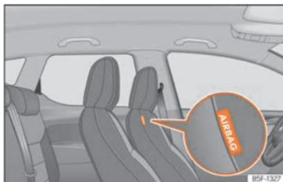
Fig. 24 No estofa interior do encosto do banco do condutor:: airbag central.
