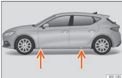
Fig. 45 Pontos de apoio do macaco.
