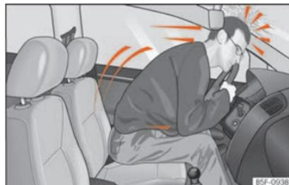
**Fig. 12** O condutor que não tiver colocado o cinto de segurança será projetado para a frente.
