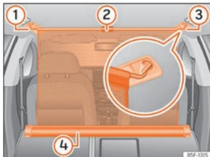
Fig. 141 Na bagageira: rede de separação fixa com os encostos do banco traseiro rebatidos.
