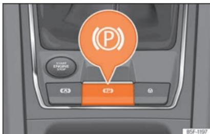
**Fig. 195** Na parte inferior da consola central: tecla do travão de estacionamento eletrónico.
