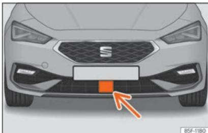
**Fig. 167** No para-choques dianteiro: sensor de radar.
