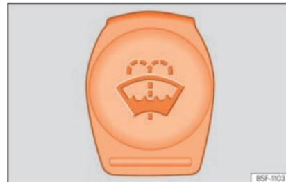
**Fig. 230** No compartimento do motor: tampão do reservatório do limpa-vidros.
