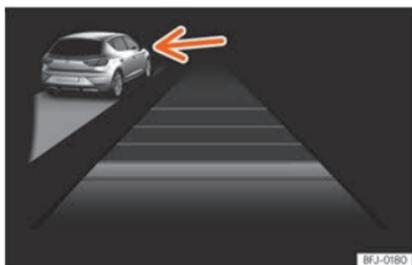
**Fig. 181** No ecrã do painel de instrumentos: ACC ativo, veículo detetado pela esquerda
