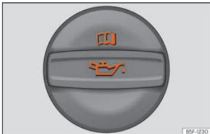
**Fig. 225** Tampão do bocal de enchimento do óleo do motor no compartimento do motor.
