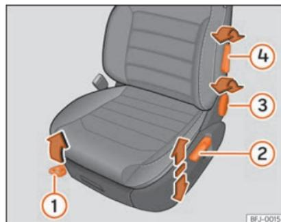
**Fig. 111** Bancos dianteiros: ajuste manual do banco.
