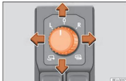
Fig. 109 Pormenor da porta do condutor: comando do retrovisor exterior.
