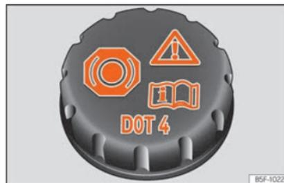
**Fig. 229** Compartimento do motor: tampão do depósito do líquido dos travões.
