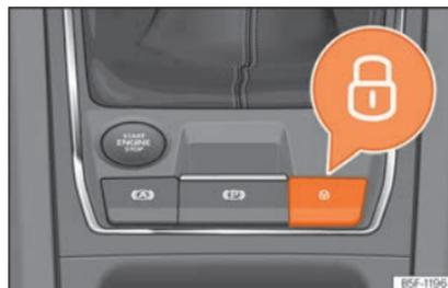
**Fig. 86** Na consola central: interruptor do fecho centralizado
