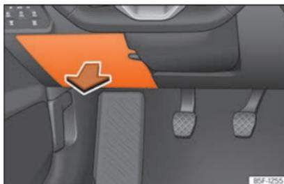
**Fig. 55** No painel de instrumentos do lado do condutor: tampa da caixa de fusíveis.
