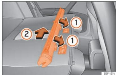
Fig. 140 Montar a rede de separação nos encostos do banco traseiro.
