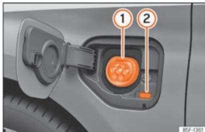
**Fig. 210** Por trás da tampa de carregamento da bateria na parte dianteira esquerda: Tomada de carregamento
