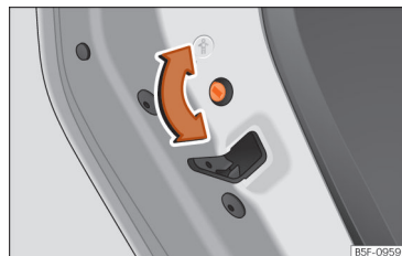
Fig. 57 Sistema de segurança para crianças da porta esquerda.
