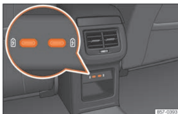
Fig. 147 Parte posterior consola central: Conectores USB com função de tomada de corrente.
