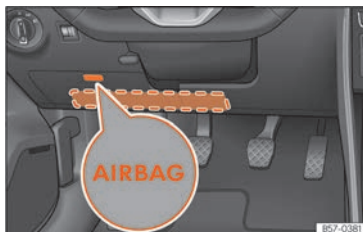
Fig. 18 No lado do condutor: localização do airbag de joelhos.
