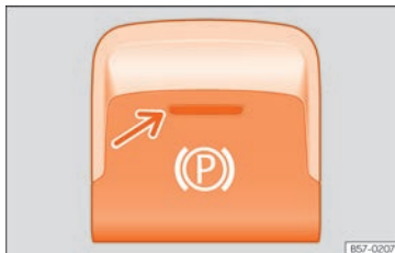
Fig. 182 Na parte inferior da consola central: tecla do travão de estacionamento eletrónico.
