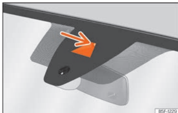
Fig. 159 No para-brisas: área de campo visual do sistema de aviso de saída da faixa de rodagem.
