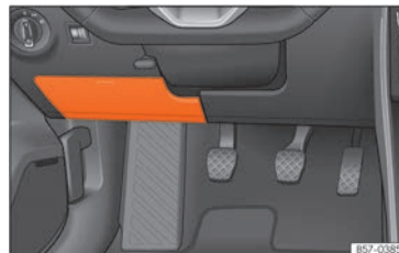
Fig. 49 Veículos com volante à esquerda: tampa da caixa de fusíveis debaixo do painel de instrumentos do lado do condutor
