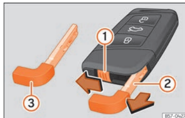
Fig. 75 Chave do veículo: retirar a chave de emergência.
