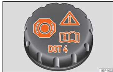
Fig. 216 Compartimento do motor: tampão do depósito do líquido dos travões.
