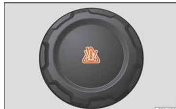
Fig. 215 Compartimento do motor: tampão do depósito de compensação do líquido de refrigeração.
