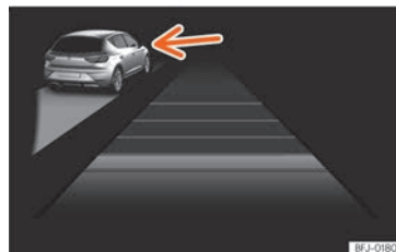
Fig. 170 No ecrã do painel de instrumentos: ACC ativo, veículo detetado pela esquerda
