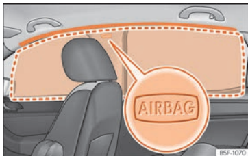
Fig. 22 Localização dos airbags da cabeça.
