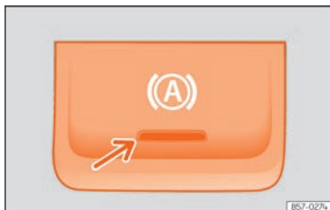
Fig. 183 Na parte inferior da consola central: tecla da função Auto Hold.
