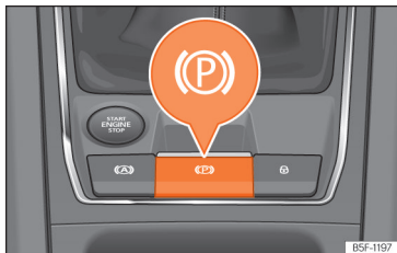
Fig. 149 Na parte inferior da consola central: botão do travão de estacionamento eletrônico.
