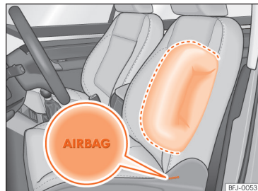
Fig. 31 Airbag lateral no banco do condutor.
