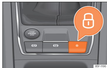
Fig. 75 Na consola central: botão do fecho centralizado.
