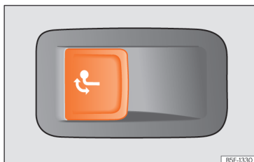
Fig. 199 No lado esquerdo da bagageira: botão para desbloquear o gancho de reboque.
