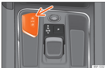
Fig. 68 Consola central (com caixa de velocidades automática): alojamento para a chave do veículo.
