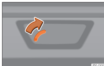
Fig. 84 Pormenor da bagageira: destrancagem de emergência (Leon Sportstourer).
