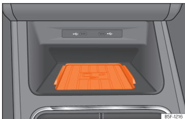
Fig. 174 Na consola central: alojamento para a ligação do telemóvel.
