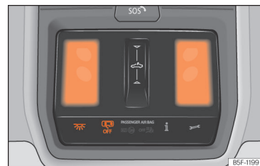
Fig. 105 Pormenor do revestimento do tejadilho: iluminação dianteira do habitáculo.
