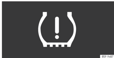
Fig. 246 Painel de instrumentos: aviso de perda de pressão dos pneus.
