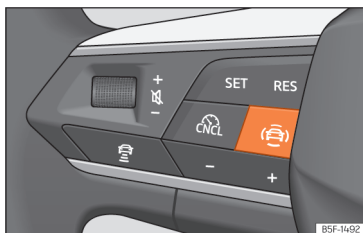
Fig. 124 Lado esquerdo do volante multifunções: botão para os sistemas de assistência à condução (conforme versões).
