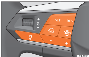
Fig. 135 No volante multifunções: botões para utilizar o ACC.
