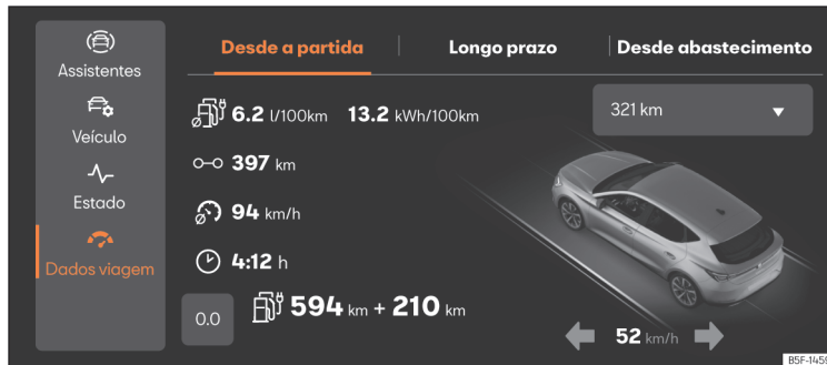
Fig. 12 Representação esquemática: Informação e estado do veículo.
