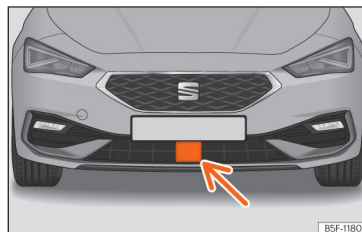
Fig. 125 No para-choques dianteiro: sensor de radar.
