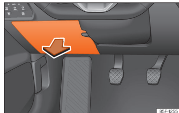
Fig. 216 No painel de instrumentos do lado do condutor: tampa da caixa de fusíveis.
