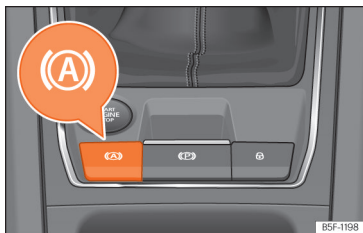
Fig. 150 Na parte inferior da consola central: botão da função Auto Hold.
