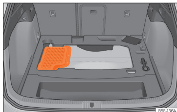
Fig. 231 Veículos híbridos (PHEV): localização da bateria na bagageira
