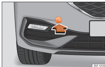
Fig. 212 No lado direito do para-choques dianteiro: retirar a tampa.
