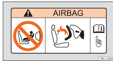
Fig. 37 Autocolante do airbag: na pala do sol do lado do passageiro.
