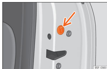
Fig. 77 Trancagem de emergência da porta.
