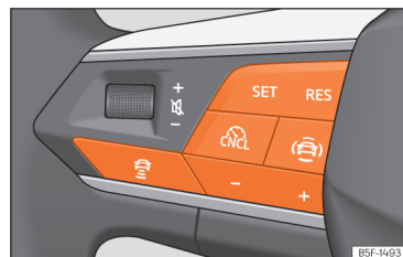
Fig. 143 Lado esquerdo do volante multifunções.
