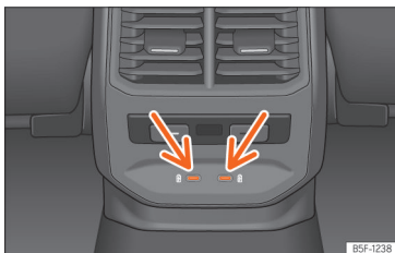
Fig. 167 Parte posterior consola central: conectores USB com função de tomada de corrente.
