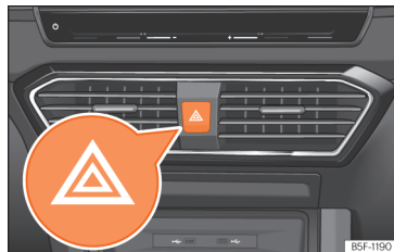
Fig. 47 Painel de instrumentos: interruptor das luzes de emergência.
