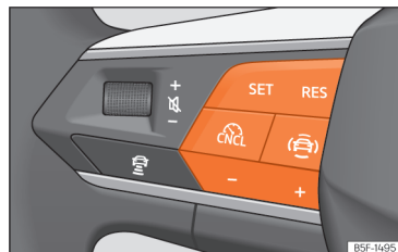
Fig. 131 No volante multifunções: botões para utilizar o regulador de velocidade.
