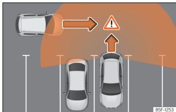
Fig. 158 Representação esquemática do assistente de saída do estacionamento: zona vigiada ao redor do veículo que está a sair do estacionamento.
