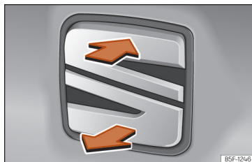
Fig. 79 Porta da bagageira: abertura a partir do exterior.
