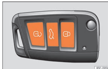
Fig. 89 Chave com comando à distância: botões.
