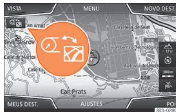
Fig. 70 Sistema de infotainment: tecla de transferência de mapa
