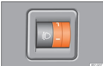
Fig. 110 Ao lado do volante: regulador do alcance das luzes.
