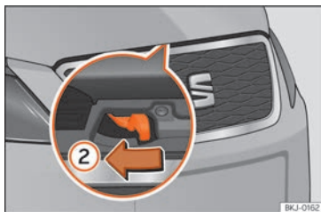
Fig. 268 Alavanca sob o capô.
