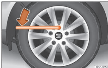
Fig. 38 Substituição da roda: desapertar os parafusos da roda.
