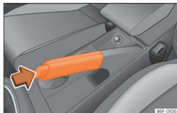
Fig. 241 Travão de mão entre os bancos dianteiros.
