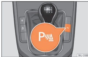
Fig. 244 Consola central: botão da ajuda ao estacionamento (consoante as versões).
