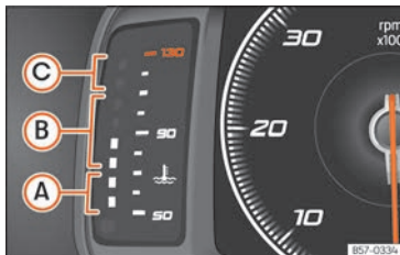
Fig. 76 Painel de instrumentos digital: indicador da temperatura do líquido de refrigeração do motor
