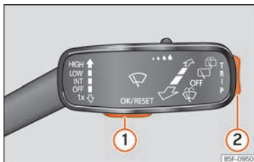
Fig. 77 Manípulo do limpa-para-brisas: botões de controle.
