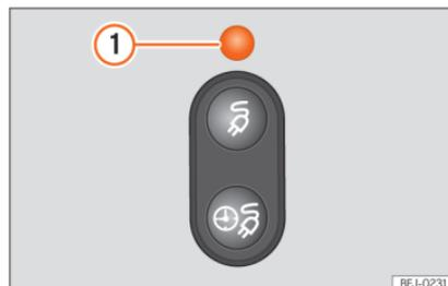
**Fig. 227** Por trás da tampa da tomada de carregamento da bateria: indicador do processo de carregamento.
