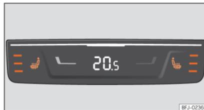
**Fig. 149** Na parte traseira da consola central: comandos para o aquecimento dos bancos traseiros.
