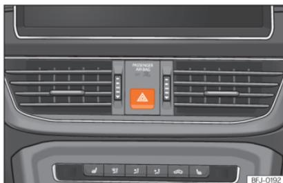
**Fig. 96** Painel de instrumentos: interruptor das luzes de emergência
