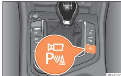
**Fig. 214** Consola central: botão para ativar/desativar manualmente o sistema de visão periférica quando está em combinação com o sistema de estacionamento assistido.
