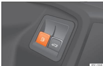
**Fig. 233** Porta do condutor: desbloqueio da tampa do depósito
