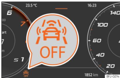
**Fig. 182** No ecrã do painel de instrumentos: indicação de Front Assist desativado.
