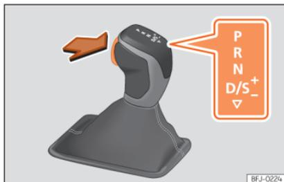
**Fig. 167** Bloqueio da alavanca seletora.
