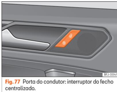
**Fig. 77** Porta do condutor: interruptor do fecho centralizado.
