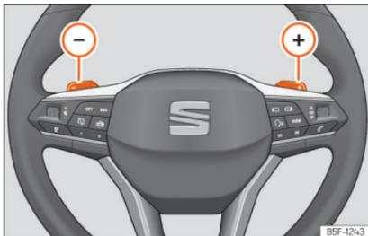
**Fig. 169** Volante: alavancas de mudança automática de velocidade.
