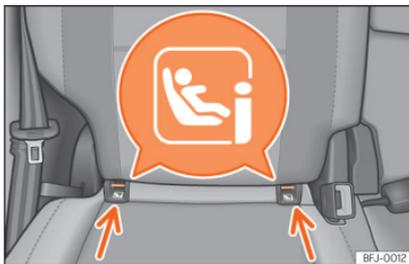
**Fig. 26** Bancos laterais da segunda fila: anéis de fixação ISOFIX/i-Size.
