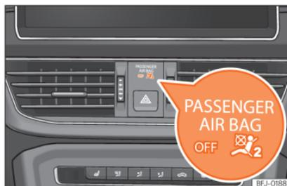
**Fig. 18** Painel de instrumentos: luz de controlo da desativação do airbag do passageiro.
