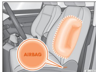
**Fig. 21** Airbag lateral no banco do condutor.
