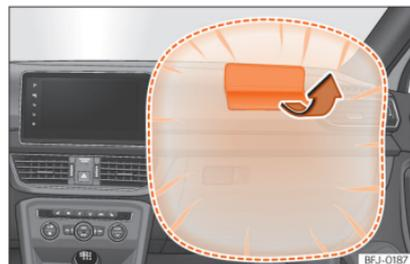
Fig. 16 Airbag do passageiro no painel de instrumentos.
