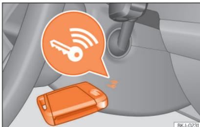
**Fig. 163** À direita da coluna de direção: arranque de emergência.
