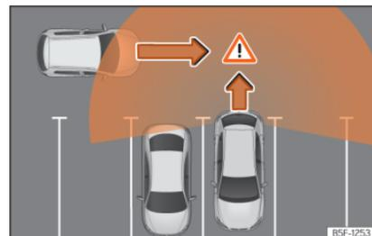
**Fig. 197** Representação esquemática do assistente de saída do estacionamento: zona vigiada ao redor do veículo que está a sair do estacionamento.
