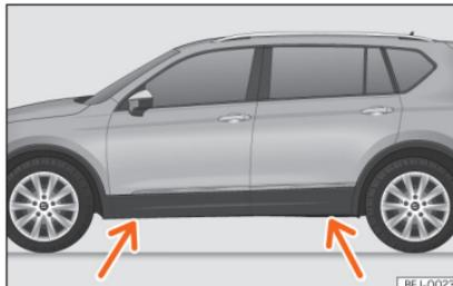
Fig. 37 Pontos de apoio do macaco.
