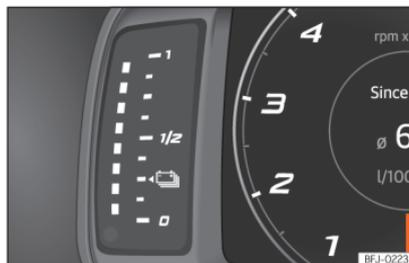
**Fig. 60** Painel de instrumentos: indicador do nível de bateria.
