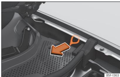
**Fig. 229** Entre a lateral esquerda e a dobradiça do capô do motor: Puxador para o desbloqueio manual de emergência do conector de carregamento.
