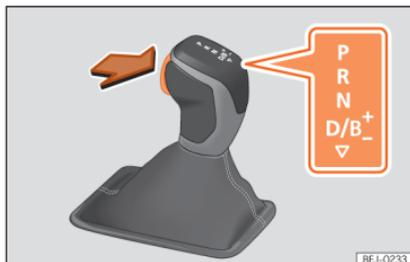
**Fig. 168** Bloqueio da alavanca seletora (veículos híbridos).
