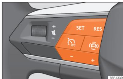
**Fig. 179** No volante multifunções: botões para utilizar o regulador de velocidade
