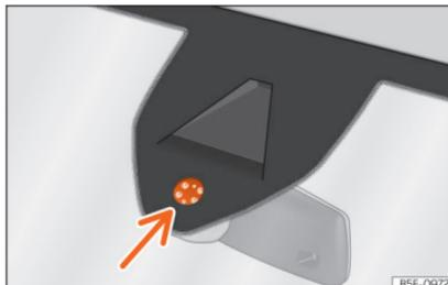
**Fig. 100** Superfície sensível do sensor de chuva.
