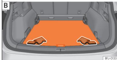
**Fig. 125** Na bagageira: ajustar em altura o piso variável da bagageira.
