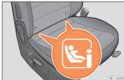
**Fig. 27** Banco passageiro dianteiro: anéis de fixação ISOFIX.
