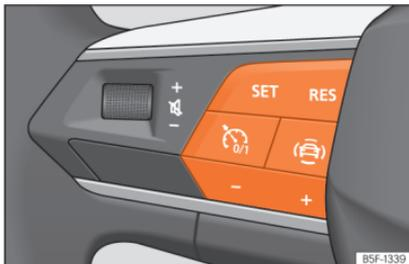
**Fig. 180** No volante multifunções: botões para utilizar o limitador de velocidade
