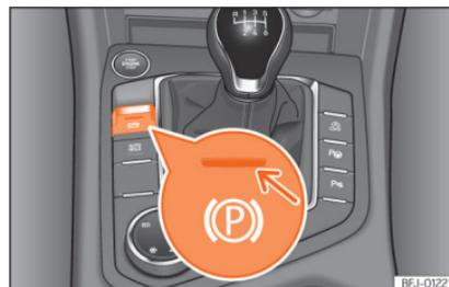
**Fig. 198** Na parte inferior da consola central: tecla do travão de estacionamento eletrónico.
