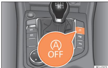
**Fig. 165** Consola central: botão do sistema Start/Stop.
