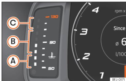
**Fig. 62** Painel de instrumentos digital: indicador da temperatura do líquido de refrigeração do motor
