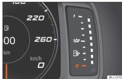
**Fig. 61** Painel de instrumentos digital: indicador do nível de combustível
