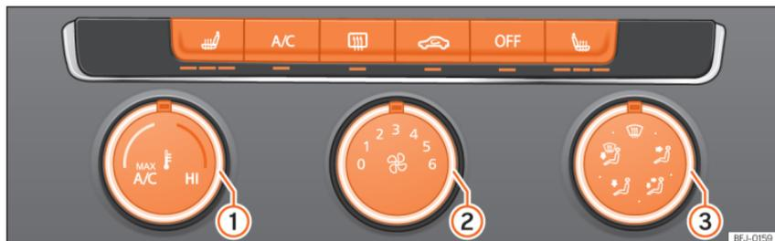
**Fig.146** Na consola central: comandos do ar condicionado manual.
