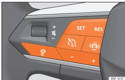
**Fig. 184** No volante multifunções: botões para utilizar o ACC
