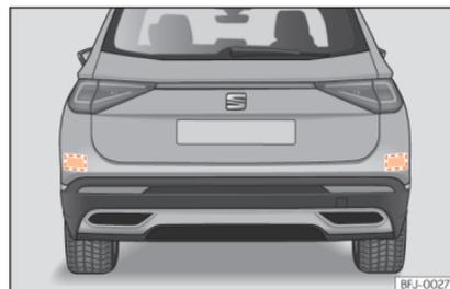
**Fig. 176** Vista traseira do veículo: zonas dos sensores de radar.
