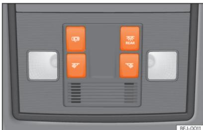
**Fig. 97** Pormenor do foro do tejadilho: iluminação dianteira do habitáculo.
