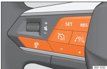
**Fig. 192** Lado esquerdo do volante multifunções: botões para a utilização do Travel Assist.
