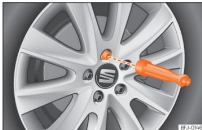
**Fig. 39** Substituição da roda: desenroskar os parafusos de roda com o cabo da chave de parafusos.
