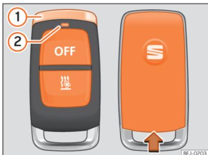
**Fig. 152** Aquecimento estacionário: comando à distância por radiofrequência.
