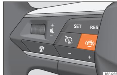
**Fig. 65** Lado esquerdo do volante multifunções: botão para os sistemas de assistência à condução (conforme versão).
