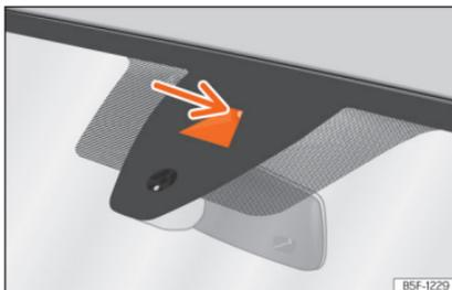
**Fig. 175** No para-brisas: área de campo visual do sistema de aviso de saída da faixa de rodagem.
