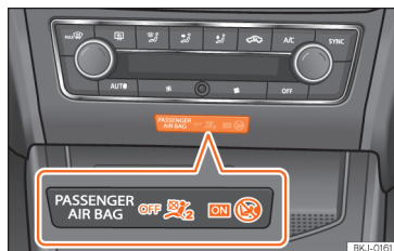
Fig. 28 Parte central do painel de instrumentos: luz de controlo da desativação do airbag do passageiro.
