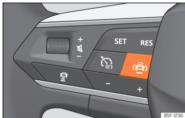
Fig. 93 Lado esquerdo do volante multifunções: botão para os sistemas de assistência à condução (conforme versões).
