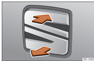
Fig. 55 Porta da bagageira: abertura a partir do exterior.
