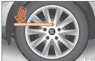
Fig. 189 Troca de roda: desapertar os parafusos de roda.
