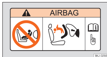
Fig. 33 Autocolante do airbag: na pala do sol do lado do passageiro.
