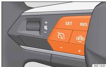
Fig. 101 No volante multifunções: botões para utilizar o limitador de velocidade.
