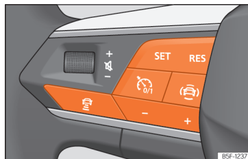
Fig. 104 No volante multifunções: botões para utilizar o ACC.
