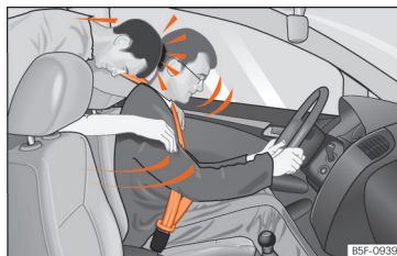
Fig. 20 O passageiro do banco traseiro que não tiver colocado o cinto de segurança é projetado para a frente, para cima do condutor que tem o cinto colocado.
