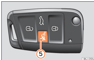
Fig. 44 Chave do veículo com botão de alarme.
