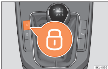
Fig. 50 Consola central: botões do fecho centralizado.
