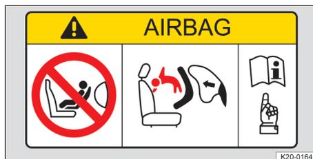
Fig. 1 Autocolante do airbag na pala do sol (representação esquemática).
