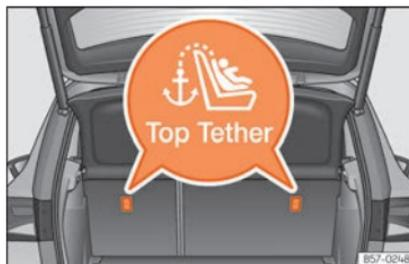
**Fig. 40** Posição dos anéis Top Tether na parte posterior do banco traseiro.
