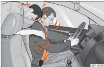
**Fig. 95** O passageiro do banco traseiro que não tiver colocado o cinto de segurança é projetado para a frente, para cima do condutor que tem o cinto colocado.
