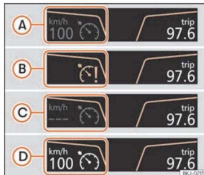
**Fig. 250** Ecrã do painel de instrumentos: indicações de estado do GRA.
