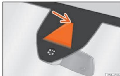
**Fig. 266** No para-brisas: área de campo visual do sistema de aviso de saída da via de circulação.
