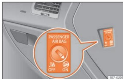
**Fig. 98** Comutador com chave para ativar e desativar o airbag do passageiro.
