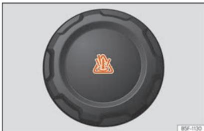
**Fig. 64** Compartimento do motor: tampa do depósito de expansão do líquido de refrigeração.
