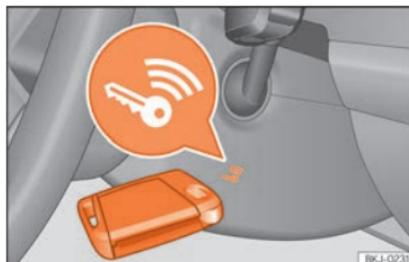
**Fig. 242** À direita da coluna de direção: arranque de emergência.
