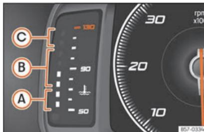
Fig. 131 Painel de instrumentos digital: indicador da temperatura do líquido de refrigeração do motor.
