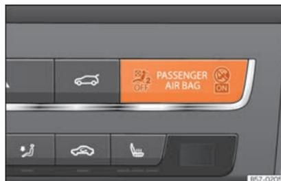
**Fig. 99** Painel de instrumentos: luz de controlo da desativação do airbag do passageiro.
