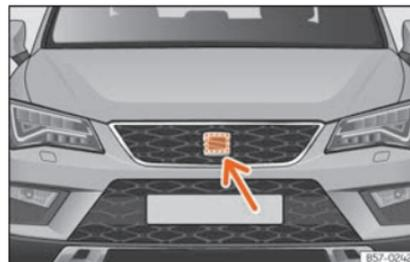
**Fig. 260** Na parte frontal atrás do emblema da SEAT: sensor de radar.
