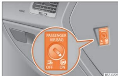
**Fig. 28** Interruptor do airbag frontal do passageiro.
