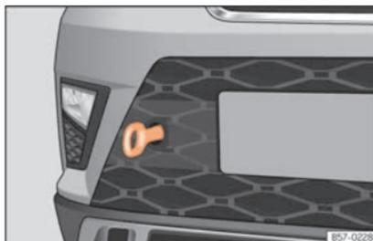
**Fig. 102** No lado direito do para-choques dianteiro: argola de reboque enroscada.
