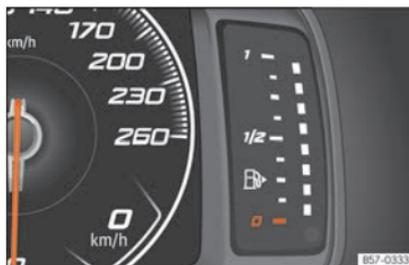
**Fig. 129** Painel de instrumentos digital: indicador do nível de combustível.
