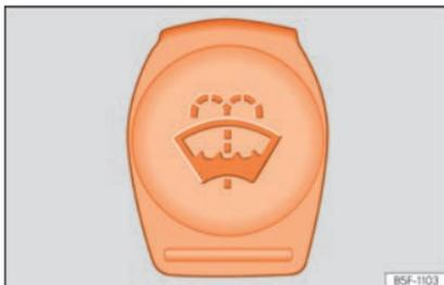
**Fig. 66** No compartimento do motor: tampa do depósito do lava-vidros.
