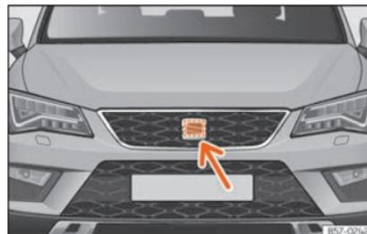
**Fig. 255** Na parte frontal atrás do emblema da SEAT, está montado um sensor de radar para captar a situação do tráfego »» **Fig. 255.**
