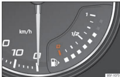
**Fig. 128** Painel de instrumentos analógico: indicador de nível de combustível
