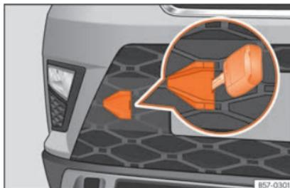
**Fig. 101** No lado direito do para-choques dianteiro: retirar a tampa.
