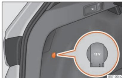
**Fig. 169** Pormenor do revestimento lateral da bagageira: tomada de corrente de 12 volts.
