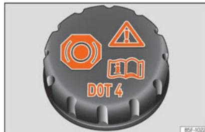
**Fig. 65** Compartimento do motor: tampa do depósito do líquido dos travões.
