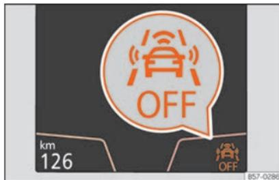
**Fig. 256** No ecrã do painel de instrumentos: indicação de Front Assist desativado.
