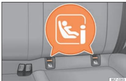
**Fig. 39** Anéis de fixação ISOFIX/i-Size.
