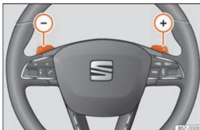
**Fig. 246** Volante: alavancas para mudança automática de velocidades.
