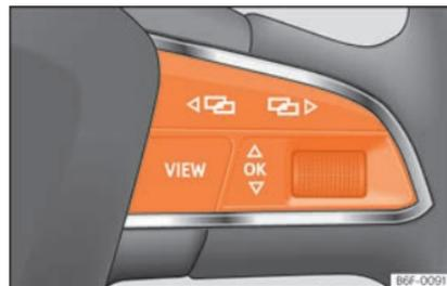
**Fig. 133** Lado direito do volante multifunções: botões para utilizar os menus e as indicações informativas do painel de instrumentos.
