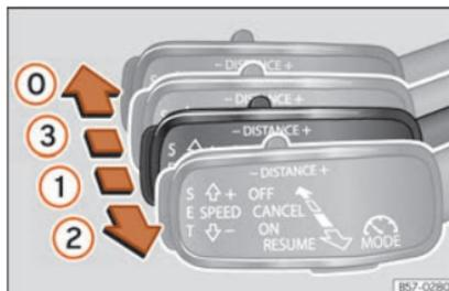
**Fig. 261** À esquerda da coluna da direção: terceiro manipulo para utilizar o controlo adaptativo de velocidade.
