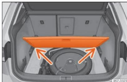
**Fig. 181** Piso variável da bagageira: posição inclinada.
