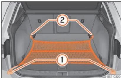
**Fig. 178** Na bagageira: saco de rede fixado rente ao piso.
