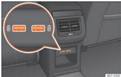
**Fig. 237** Parte posterior consola central: conectores USB.
