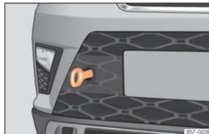
**Fig. 80** Parte direita do para-choques dianteiro: argola de reboque enroscada.
