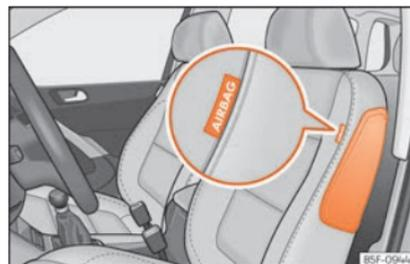
**Fig. 32** Airbag lateral no banco do condutor.
