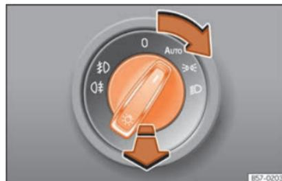
Fig. 45 Painel de instrumentos: comando das luzes.
