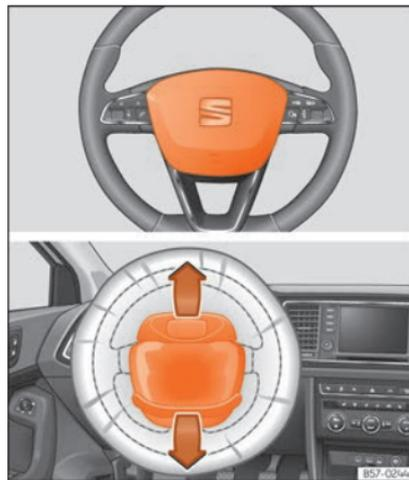
**Fig. 26** Airbag do condutor no volante. »
