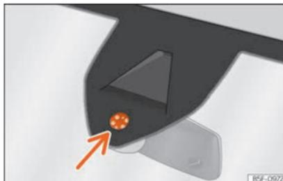
**Fig. 186** Sensor de humidade e temperatura do para-brisas.
