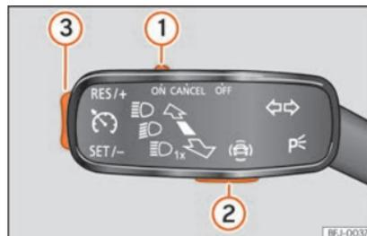
**Fig. 54** À esquerda da coluna da direção: interruptor e comandos de utilização do GRA.
