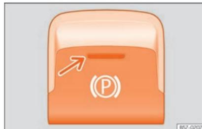
**Fig. 243** Na parte inferior da consola central: botão do travão de estacionamento eletrónico.
