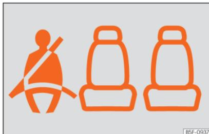
**Fig. 92** Painel de instrumentos: indicação de lugar posterior direito ocupado e cinto de segurança correspondente apertado.
