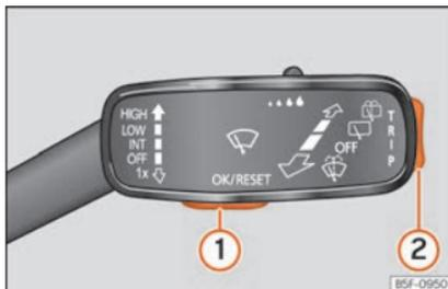
**Fig. 132** Alavanca do limpador para-brisas: botão de controle.
