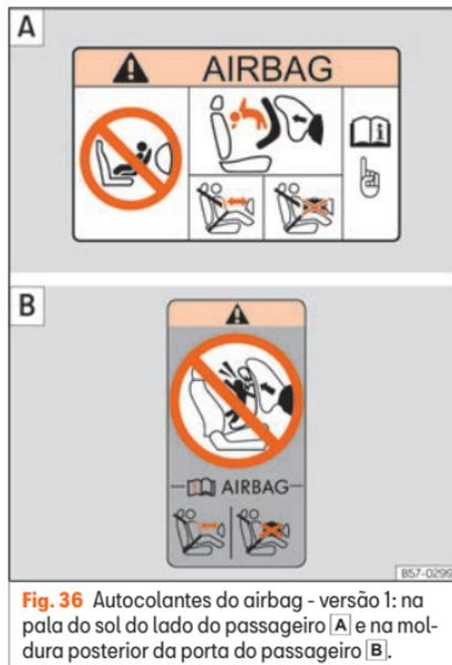
**Fig. 36** Autocolantes do airbag - versão 1: na pala do sol do lado do passageiro [A] e na moldura posterior da porta do passageiro [B].
