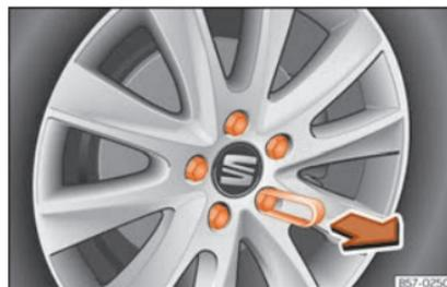
**Fig. 75** Roda: parafusos de roda com protetores.
