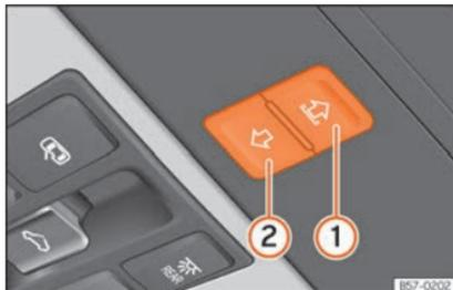
**Fig. 149** No revestimento interior do teto: botões da cortina para o sol.
