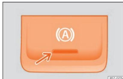
**Fig. 249** Na parte inferior da consola central: botão da função Auto Hold.
