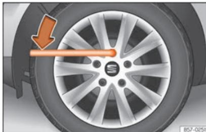
**Fig. 77** Roda: desapertar os parafusos de roda.
