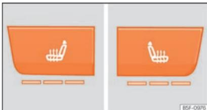
**Fig. 160** Na consola central: comandos para o aquecimento dos bancos dianteiros.
