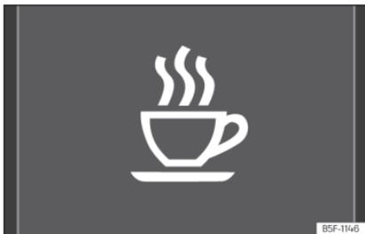
**Fig. 126** No ecrã do painel de instrumentos: símbolo de deteção de fadiga.
