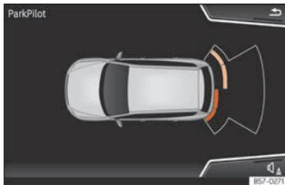
**Fig. 290** Visualização de auxílio de estacionamento no ecrã do sistema Easy Connect.
