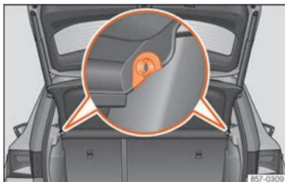
**Fig. 171** Na bagageira: desmontar e montar a chapeleira.
