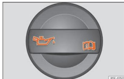
**Fig. 63** Tampão do bocal de enchimento do óleo do motor no compartimento do motor.
