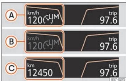
**Fig. 251** No ecrã do painel de instrumentos: indicações do estado do limitador de velocidade.
