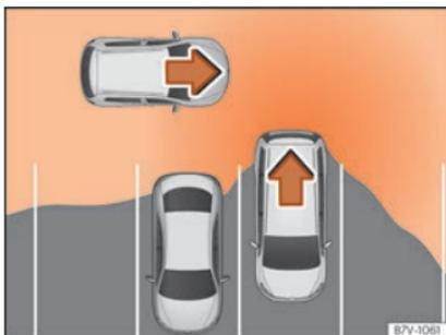
**Fig. 275** Representação esquemática do assistente de saída do estacionamento: zona vigiada ao redor do veículo que está a sair do estacionamento.
