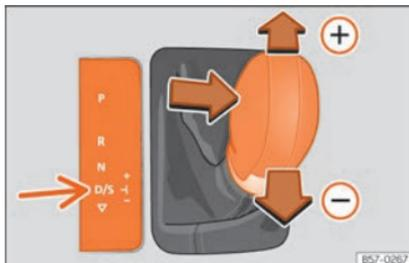
**Fig. 245** Consola central: mudar velocidades com tiptronic.
