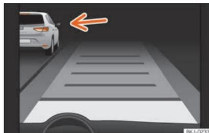
**Fig. 263** No ecrã do painel de instrumentos: ACC ativo, veículo detetado pela esquerda
