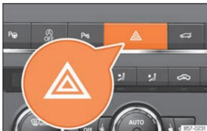
**Fig. 153** Painel de instrumentos: interruptor das luzes de emergência.
