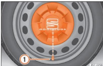
**Fig. 74** Colocação correta do embelezador central da roda para jantes de aço.
