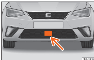
Fig. 142 No para-choques dianteiro: sensor de radar.
