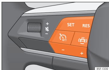
Fig. 148 No volante multifunções: botões para utilizar o regulador de velocidade
