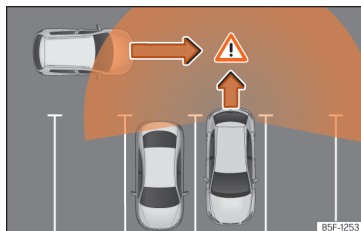
Fig. 164 Representação esquemática do assistente de saída de estacionamento: zona viável ao redor do veículo que está a sair do estacionamento.
