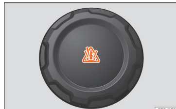
Fig. 192 Compartimento do motor: tampão do depósito de compensação do líquido de refrigeração.
