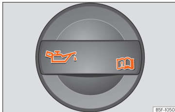
Fig. 190 Tampão do bocal de enchimento do óleo do motor no compartimento do motor.
