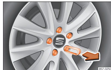
Fig. 34 Roda: parafusos da roda com protetores.
