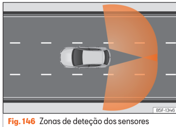
Fig. 146 Zonas de deteção dos sensores
