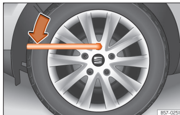
Fig. 36 Substituição da roda: desapertar os parafusos da roda.
