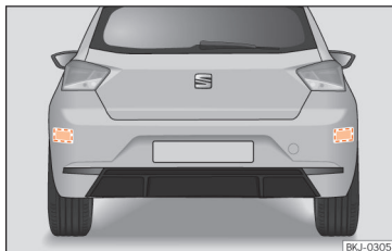
Fig. 145 Vista traseira do veículo: zonas dos sensores de radar.
