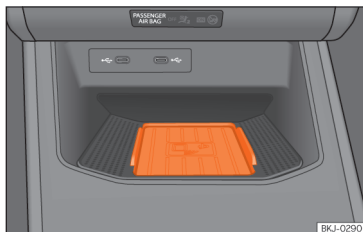
Fig. 130 Na consola central: alojamento para a ligação do telemóvel.
