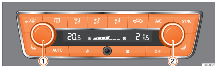
Fig. 122 Na consola central: comandos do Climatronic.
