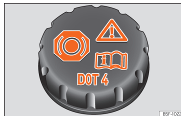
Fig. 193 Compartimento do motor: tampão do depósito do líquido dos travões.
