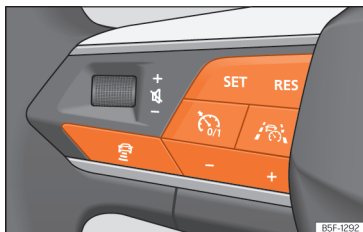
Fig. 160 Lado esquerdo do volante multifunções: botões para a utilização do Travel Assist.
