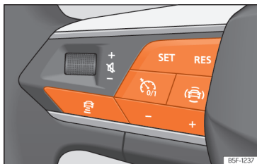
Fig. 152 No volante multifunções: botões para utilizar o ACC
