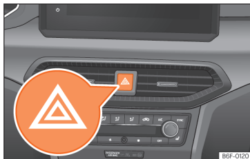
Fig. 98 Painel de instrumentos: interruptor das luzes de emergência
