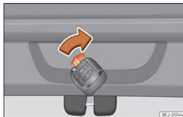
Fig. 88 Pormenor da bagageira: destrancagem de emergência.
