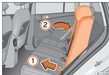
Fig. 106 Ajuste do encosto do banco traseiro. »
