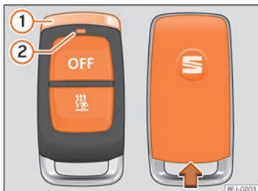
Fig. 154 Aquecimento estacionário: comando à distância por radiofrequência.
