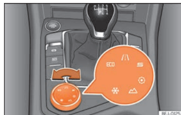
Fig. 173 Consola central: Comando rotativo (Driving Experience button).
