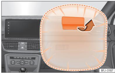
**Fig. 32** Airbag do passageiro no painel de instrumentos.
