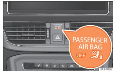
**Fig. 34** Painel de instrumentos: luz de controlo da desativação do airbag do passageiro.
