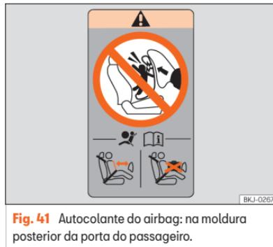
**Fig. 41** Autocolante do airbag: na moldura posterior da porta do passageiro.
