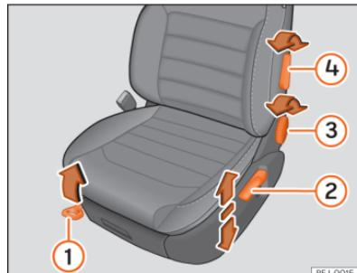
**Fig. 88** Bancos dianteiros: ajuste manual do banco.
