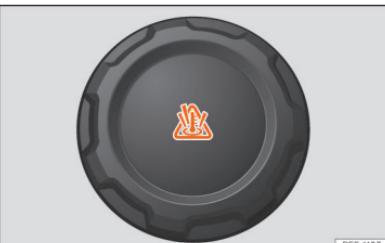
**Fig. 237** Compartimento dianteiro: tampão do depósito de expansão do líquido de refrigeração.
