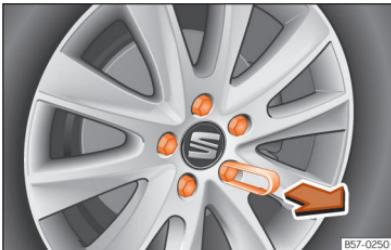
**Fig. 251** Roda: parafusos de roda com protetores.
