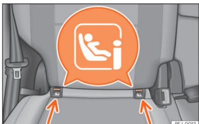
**Fig. 42** Banco traseiro: localização dos anéis de fixação ISOFIX ou i-Size.
