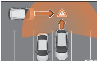
**Fig. 175** Representação esquemática do assistente de saída do estacionamento: zona vigiada ao redor do veículo que está a sair do estacionamento.
