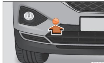
Fig. 225 No lado direito do para-choques dianteiro: retirar a tampa.
