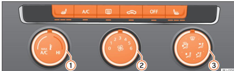
**Fig. 114** Na consola central: comandos do ar condicionado manual.
