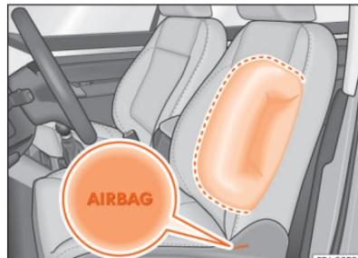
**Fig. 35** Airbag lateral no banco do condutor.
