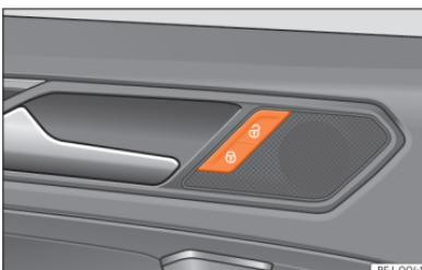
**Fig. 71** Na porta do condutor: interruptor do fecho centralizado.
