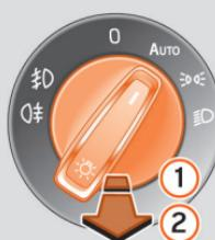
**Fig. 105** Painel de instrumentos: comando das luzes.
