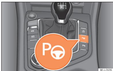
**Fig. 162** Na consola central: botão para ligar o sistema de estacionamento assistido.
