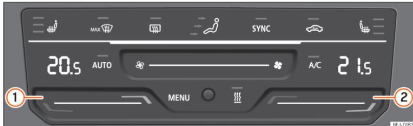
**Fig. 113** Na consola central: comandos do Climatronic.
