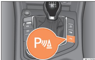
**Fig. 159** Consola central: botão do auxílio de estacionamento (consoante as versões).
