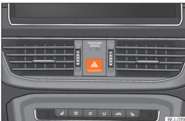
**Fig. 50** Painel de instrumentos: interruptor das luzes de emergência.
