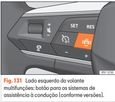
**Fig. 131** Lado esquerdo do volante multifunções: botão para os sistemas de assistência à condução (conforme versões).
