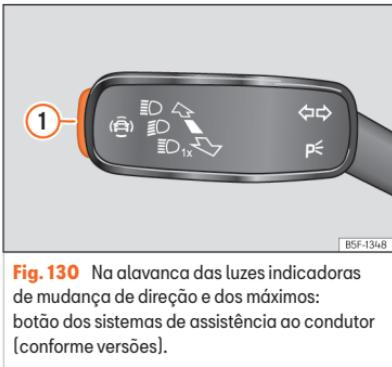
**Fig. 130** Na alavanca das luzes indicadoras de mudança de direção e dos máximos: botão dos sistemas de assistência ao condutor (conforme versões).
