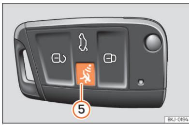
**Fig. 65** Chave do veículo com botão de alarme.
