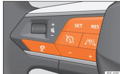
**Fig. 150** Lado esquerdo do volante multifunções.
