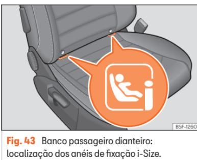
**Fig. 43** Banco passageiro dianteiro: localização dos anéis de fixação i-Size.
