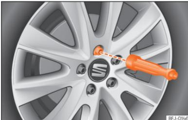
**Fig. 257** Substituição da roda: desapertar os parafusos da roda com o punho da chave de parafusos.
