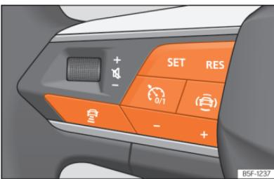
**Fig. 141** No volante multifunções: botões para utilizar o ACC.
