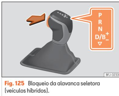
**Fig. 125** Bloqueio da alavanca seletora [veículos híbridos].
