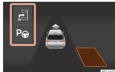
**Fig. 163** No ecrã do painel de instrumentos: visualização do sistema de estacionamento assistido com visualização reduzida.
