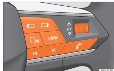
**Fig. 15** Lado direito do volante multifunções: botões para utilizar os menus e as indicações informativas do painel de instrumentos (segundo versões).
