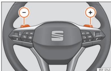
**Fig. 126** Volante: alavancas para mudança automática de velocidades.
