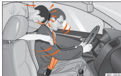
**Fig. 25** O passageiro do banco traseiro que não tiver colocado o cinto de segurança é projetado para a frente, para cima do condutor que tem o cinto colocado.
