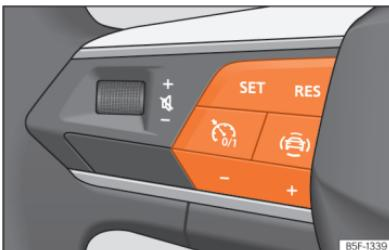
**Fig. 138** No volante multifunções: botões para utilizar o regulador de velocidade.
