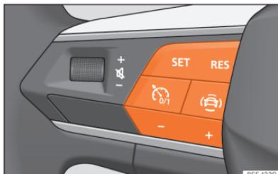
Fig. 139 No volante multifunções: botões para utilizar o limitador de velocidade.
