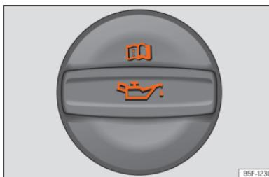
**Fig. 243** Tampa do bocal de enchimento do óleo do motor no compartimento do motor.
