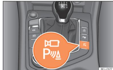
**Fig. 171** Consola central: botão para ativar/desativar manualmente o sistema de visão periférica quando está em combinação com o sistema de estacionamento assistido.
