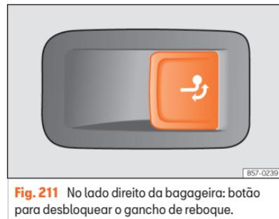
**Fig. 211** No lado direito da bagageira: botão para desbloquear o gancho de reboque.
