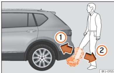
Fig. 79 Porta da bagageira com abertura controlada por sensor (Easy Open)
