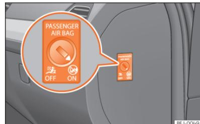
**Fig. 33** Comutador com chave para ativar e desativar o airbag do passageiro.
