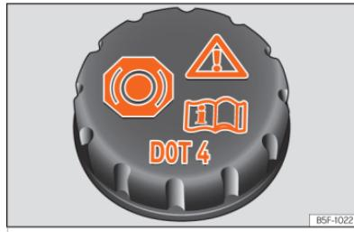
**Fig. 238** Compartimento do motor: tampa do depósito do líquido dos travões.
