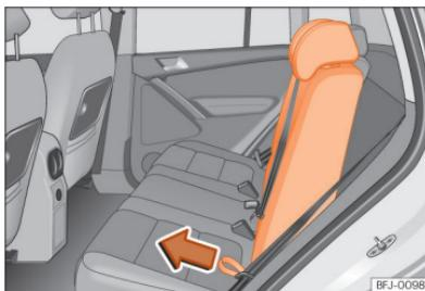
**Fig. 94** Rebater e levantar o encosto do banco traseiro.
