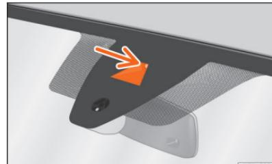
**Fig. 134** No para-brisas: área de campo visual do sistema de aviso de saída da faixa de rodagem.
