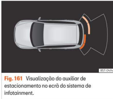
**Fig. 161** Visualização do auxiliar de estacionamento no ecrã do sistema de infotainment.
