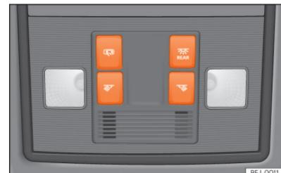
**Fig. 107** Pormenor do revestimento do tejadilho: iluminação dianteira do habitáculo.
