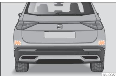
**Fig. 135** Vista traseira do veículo: zonas dos sensores de radar.
