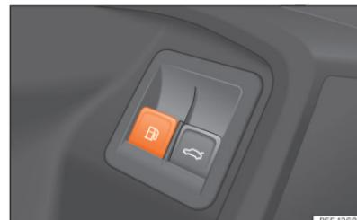
**Fig. 216** Porta do condutor: desbloqueio da tampa do depósito.
