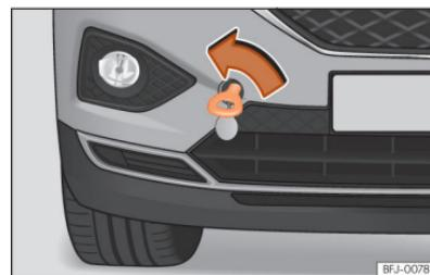
Fig. 226 Parte direita do para-choques dianteiro: argola de reboque enroscada.
