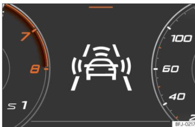
**Fig. 145** No ecrã do painel de instrumentos: indicações de pré-aviso.
