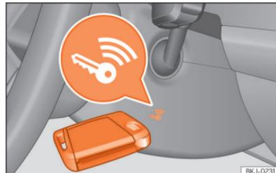
**Fig. 120** À direita da coluna de direção: arranque de emergência.
