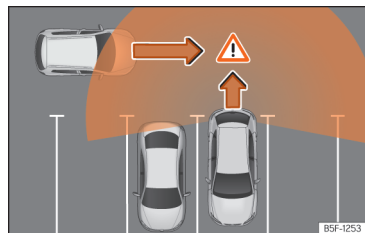
Fig. 130 Representação esquemática do assistente de saída do estacionamento: zona vigiada ao redor do veículo que está a sair do estacionamento.
