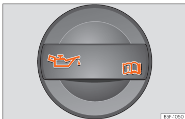
Fig. 186 Tampa do bocal de enchimento do óleo do motor no compartimento do motor.
