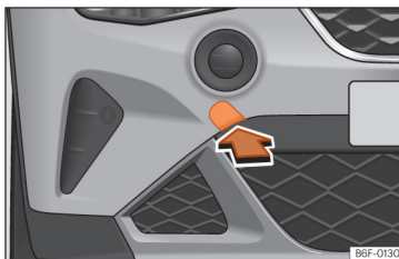
Fig. 163 No lado direito do para-choques dianteiro: retirar a tampa.
