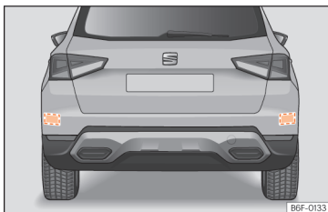
Fig. 95 Vista traseira do veículo: zonas dos sensores de radar.
