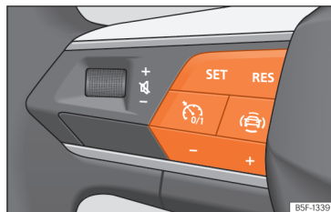
Fig. 99 No volante multifunções: botões para utilizar o limitador de velocidade.
