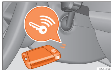
Fig. 82 À direita da coluna de direção: arranque de emergência.
