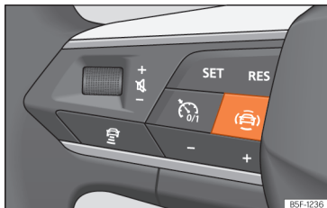
Fig. 91 Lado esquerdo do volante multifunções: botão para os sistemas de assistência à condução (conforme versões).
