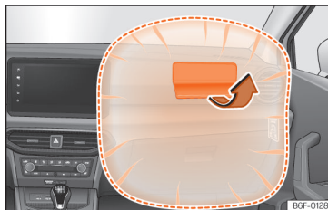
Fig. 26 Airbag do passageiro no painel de instrumentos.
