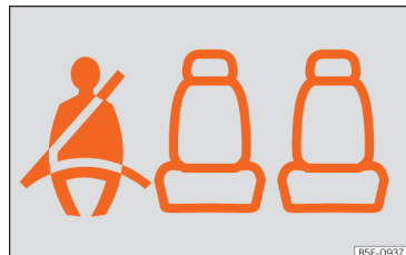
Fig. 18 Painel de instrumentos: indicação do estado dos cintos de segurança dos lugares traseiros.
