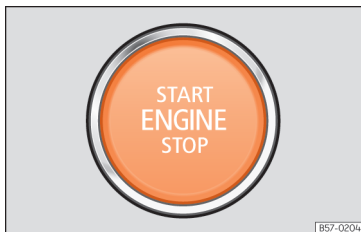
Fig. 81 Na parte inferior da consola central: botão de arranque.
