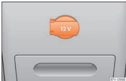
**Fig. 171** Parte posterior da consola central: tomada de corrente de 12 Volts.
