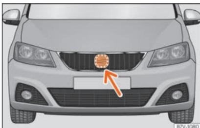
**Fig. 247** Na parte frontal após o emblema da SEAT: sensor de radar.
