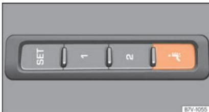
**Fig. 135** Na lateral do banco dianteiro: botão para a função de massagem lombar.
