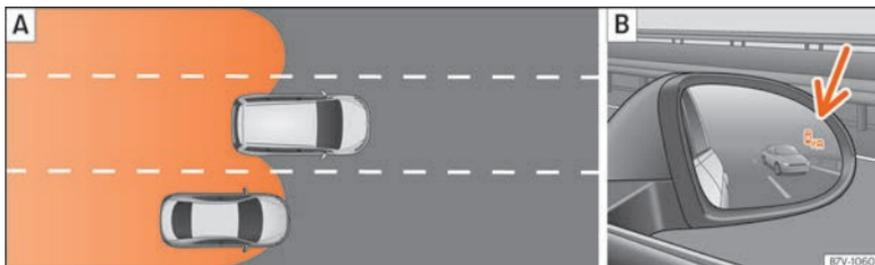
**Fig. 263** Esquema: **A** Situação numa ultrapassagem e incorporação posterior na via de circulação direita. **B** Indicação do assistente de ângulo morto no retrovisor exterior direito.
