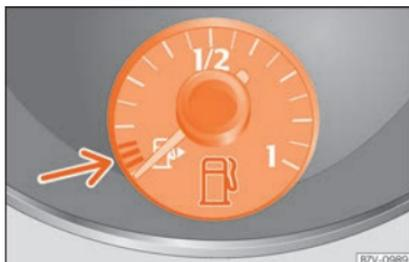
**Fig. 78** No painel de instrumentos: indicador do nível de combustível para gasolina e diesel.
