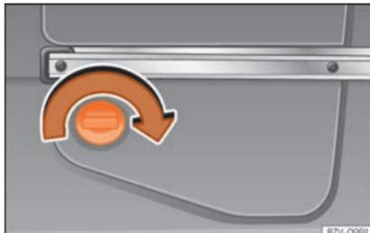
**Fig. 284** Na parte traseira esquerda da bagageira: depósito de AdBlue, atrás de uma cobertura.
