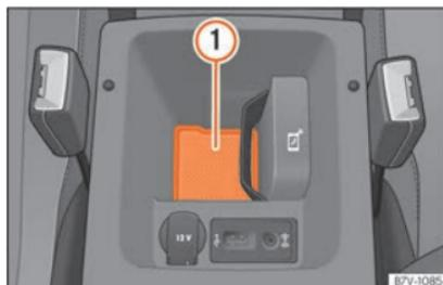
**Fig. 232** Alojamento para a ligação do telemóvel à antena exterior do veículo situado dentro do apoio dos braços central dianteiro.
