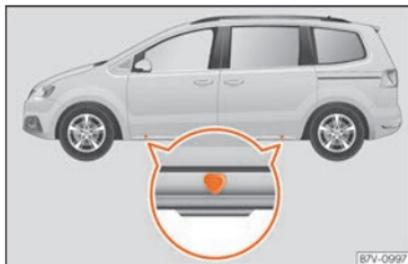
Fig. 47 Pontos de apoio do macaco.
