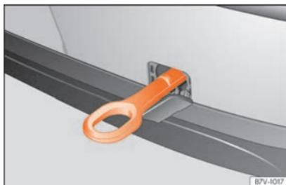
**Fig. 57** No lado direito do para-choques traseiro: argola de reboque enroscada.
