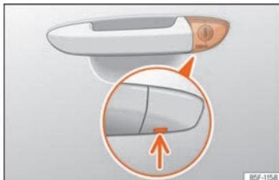
**Fig. 94** Manípulo da porta do condutor: canhão da fechadura oculto.
