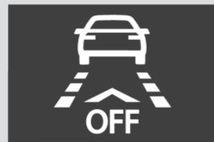
**Fig. 248** No ecrã do painel de instrumentos: indicação de Front Assist desativado.
