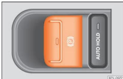
**Fig. 265** Na consola central: tecla do travão de estacionamento eletrónico.
