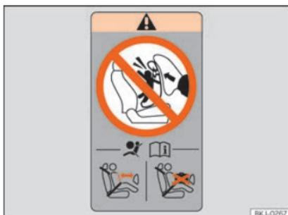
Fig. 28 Autocolante do airbag: na moldura posterior da porta do passageiro
