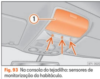
**Fig. 93** Na consola do tejadilho: sensores de monitorização do habitáculo.
