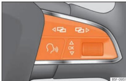
**Fig. 82** Volante multifunções: botões para utilizar os menus do painel de instrumentos.
