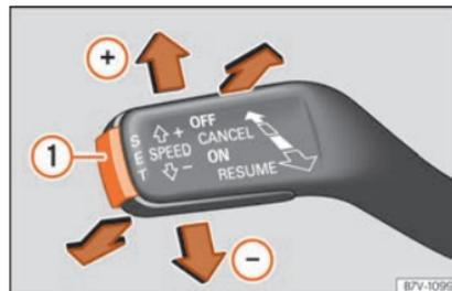
Fig. 245 À esquerda da coluna de direção: terceira alavanca para utilizar o GRA.
