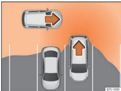
**Fig. 264** Representação esquemática do assistente de saída de estacionamento: zona vigiada ao redor do veículo que está a sair do estacionamento.
