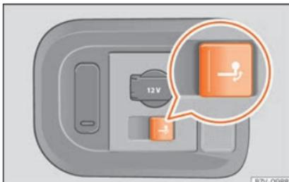
**Fig. 280** No lado direito da bagageira: botão para desbloquear o gancho de reboque.
