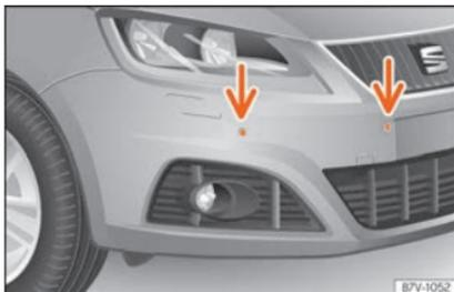
**Fig. 272** Sensores do controlo de estacionamento no para-choques dianteiro.
