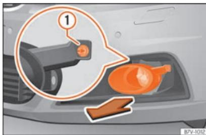
**Fig. 66** Na parte direita do para-choques dianteiro: desmontagem dos faróis.
