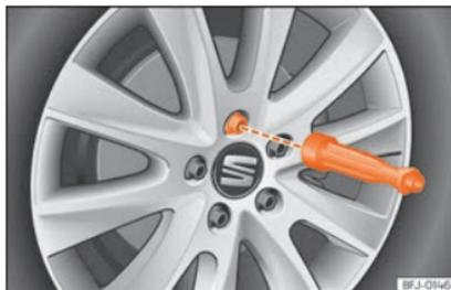
**Fig. 49** Substituição da roda: desenrosque os parafusos de roda com o cabo da chave de parafusos.
