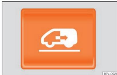
**Fig. 99** No painel de instrumentos, na chave do veículo e no revestimento interior da porta de correr: botão para abrir e fechar uma porta de correr elétrica.
