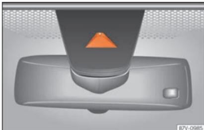
**Fig. 256** No para-brisas: área de campo visual da câmara do sistema de aviso de saída da faixa de rodagem.
