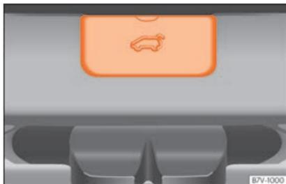
**Fig. 107** Pormenor da bagageira: acesso à destrancagem de emergência.
