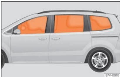
**Fig. 25** Airbags da cabeça insuflados.
