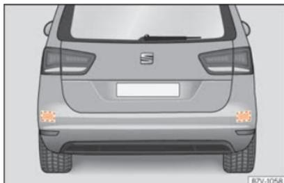
**Fig. 261** Vista traseira do veículo: zonas dos sensores de radar.
