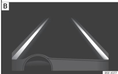
**Fig. 257** No ecrã do painel de instrumentos: Indicação no ecrã do sistema de aviso de saída da faixa de rodagem (exemplo 1).
