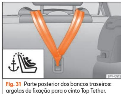
**Fig. 31** Parte posterior dos bancos traseiros: argolas de fixação para o cinto Top Tether.
