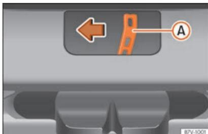
**Fig. 108** Pormenor da bagageira: destrancagem de emergência.
