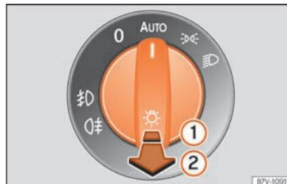
**Fig. 115** Painel de instrumentos: comando das luzes.
