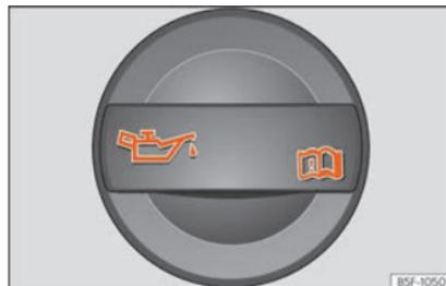
**Fig. 290** Tampão do bocal de enchimento do óleo do motor no compartimento do motor.
