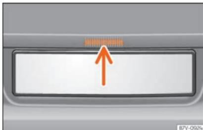
**Fig. 101** Abertura da porta da bagageira a partir do exterior.
