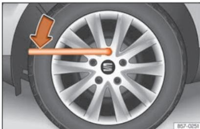
**Fig. 45** Substituição da roda: desapertar os parafusos da roda.
