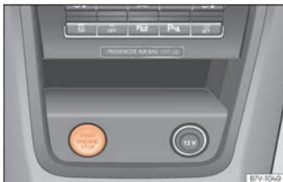
**Fig. 234** Na consola central: botão de arranque do sistema de fecho e arranque sem chave Keyless Access. Nos veículos com direção à direita, a disposição é simétrica.
