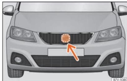
**Fig. 251** Na parte frontal após o emblema da SEAT: sensor de radar.
