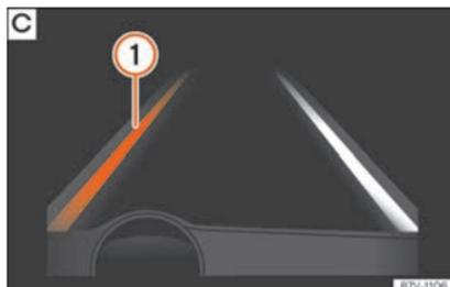
**Fig. 258** No ecrã do painel de instrumentos: Indicação no ecrã do sistema de aviso de saída da faixa de rodagem (exemplo 2).
