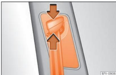
**Fig. 15** Junto aos bancos dianteiros: regulador da altura do cinto.
