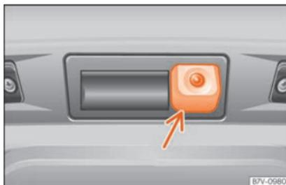
**Fig. 275** Na porta da bagageira: localização da câmara do assistente de marcha-atrás.
