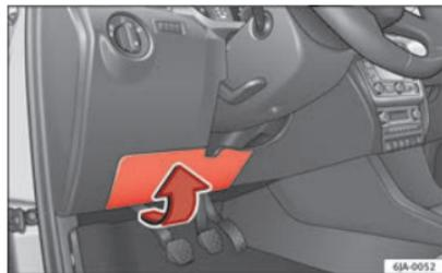
Fig. 147 Parte inferior do painel de instrumentos, tampa de fusíveis
