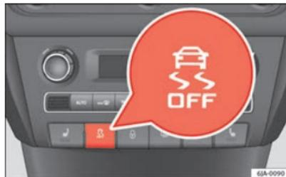
Fig. 103 Sistema ESC: Interruptor do ASR
