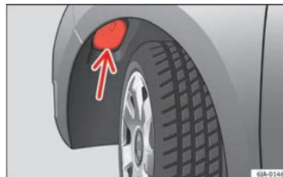
Fig. 155 Substituição da lâmpada dos médios: cava das rodas
