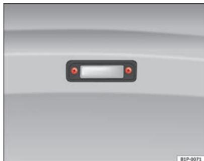
Fig. 171 Desmontagem da iluminação da placa da matrícula
