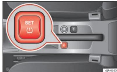
Fig. 135 Interruptor de ajuste do nível de ar dos pneus
