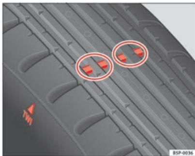
Fig. 131 Perfil dos pneus com indicadores de desgaste
