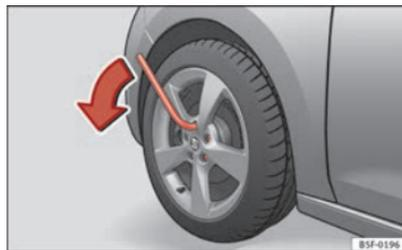
Fig. 138 Substituição de roda: Desapertar os parafusos da roda ▶
