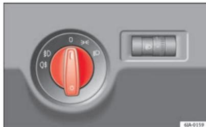
Fig. 54 Painel de instrumentos: Comando das luzes ▶
