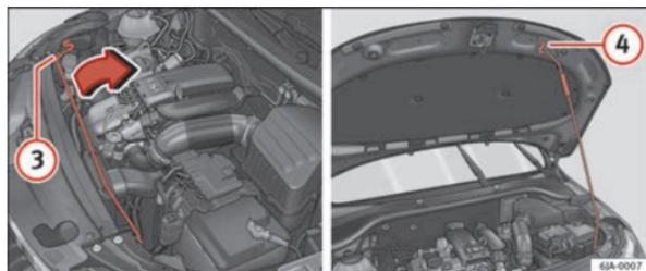
Fig. 124 Bloqueio do capot do compartimento do motor
