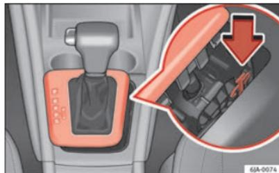
Fig. 107 Desbloqueio de emergência da alavanca de selecção
