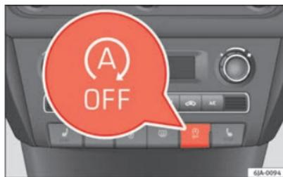
Fig. 110 Painel de instrumentos: botão do sistema START-STOP
