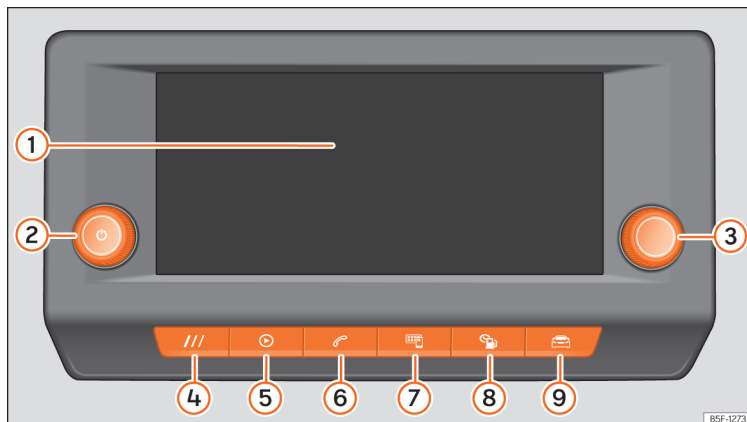
Fig. 168 Quadro geral: unidade de comandos e indicação na versão de 8,25 polegadas
