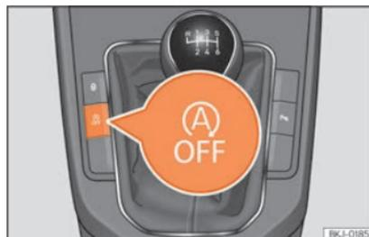
**Fig. 139** Consola central: botão do sistema Start/Stop.
