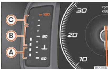
**Fig. 72** Painel de instrumentos digital: indicador da temperatura do líquido de refrigeração do motor
