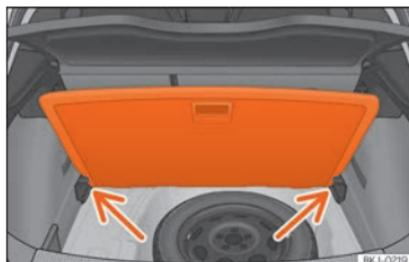
**Fig. 119** Piso variável da bagageira: posição inclinada.
