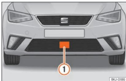
**Fig. 146** No para-choques dianteiro: sensor de radar.
