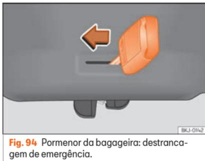
**Fig. 94** Pormenor da bagageira: destrancagem de emergência.
