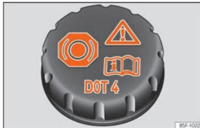
**Fig. 190** Compartimento do motor: tampão do depósito do líquido dos travões.
