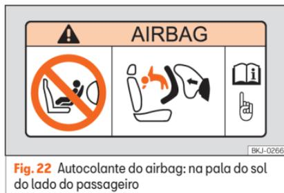
**Fig. 22** Autocolante do airbag: na pala do sol do lado do passageiro
