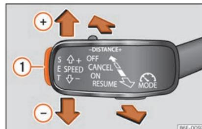
**Fig. 151** À esquerda da coluna de direção: terceira alavanca para utilizar o GRA.
