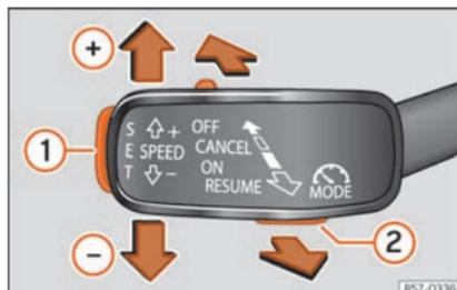
**Fig. 154** À esquerda da coluna de direção: botões para utilizar o limitador de velocidade.
