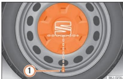
**Fig. 32** Colocação correta do embelezador central da roda para jantes de aço.
