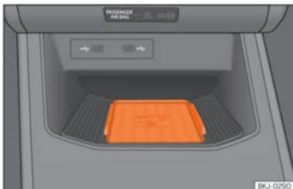
**Fig. 134** Na consola central: alojamento para a ligação do telemóvel.
