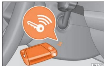
**Fig. 138** À direita da coluna de direção: arranque de emergência.
