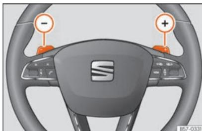
**Fig. 143** Volante: alavancas de mudança automática de velocidade.
