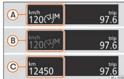
Fig. 152 No ecrã do painel de instrumentos: indicações do estado do limitador de velocidade. »
