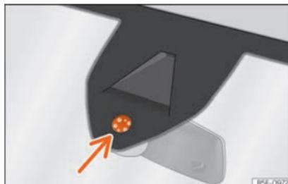
**Fig. 106** Superfície sensível do sensor de chuva.
