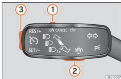
**Fig. 153** No manípulo dos indicadores de mudança de direção: botões para utilizar o limitador de velocidade.
