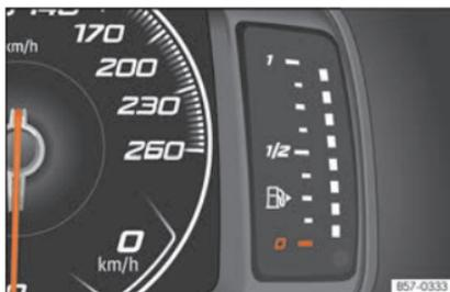
Fig. 69 Painel de instrumentos digital: indicador do nível de combustível
