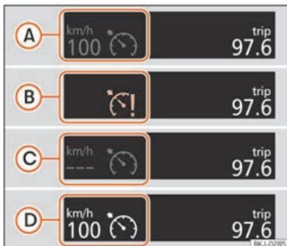
**Fig. 149** Ecrã do painel de instrumentos: indicações do estado do GRA.
