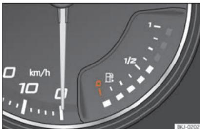
Fig. 68 Painel de instrumentos analógico: indicador do nível de combustível
