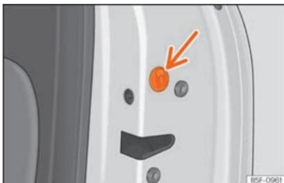
**Fig. 91** Trancagem de emergência da porta.
