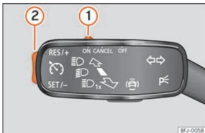
**Fig. 150** No manípulo dos indicadores de direção: comandos para a utilização do GRA.
