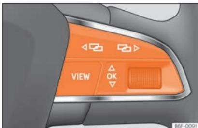
**Fig. 73** Lado direito do volante multifunções: botões para utilizar os menus e as indicações informativas do painel de instrumentos.
