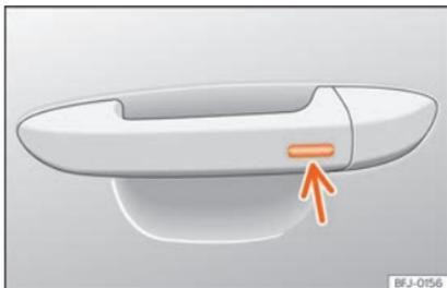
Fig. 97 Manípulo da porta: superfície sensora.
