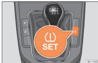
Fig. 196 Consola central: botão do sistema de controlo dos pneus.
