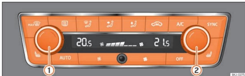
**Fig. 127** Na consola central: comandos do Climatronic.
