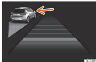
**Fig. 160** No ecrã do painel de instrumentos: ACC ativo, veículo detetado pela esquerda
