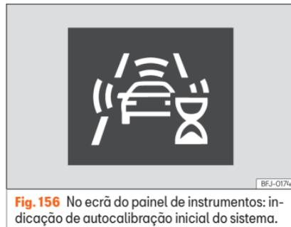
**Fig. 156** No ecrã do painel de instrumentos: indicação de autocalibração inicial do sistema.
