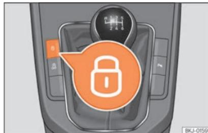
**Fig. 86** Consola central: botão do fecho centralizado.
