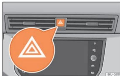
**Fig. 101** Painel de instrumentos: interruptor das luzes de emergência
