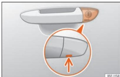
**Fig. 89** Manipulo da porta do condutor: canhão da fechadura oculto.
