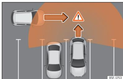
**Fig. 154** Representação esquemática do assistente de saída do estacionamento: zona vigiada ao redor do veículo que está a sair do estacionamento.
