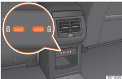
**Fig. 161** Parte posterior consola central: conectores USB com função de tomada de corrente.
