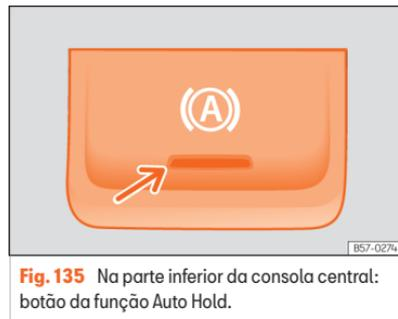
**Fig. 135** Na parte inferior da consola central: botão da função Auto Hold.
