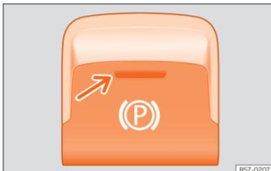
**Fig. 134** Na parte inferior da consola central: botão do travão de estacionamento eletrônico.
