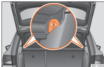
**Fig. 170** Na bagageira: desmontar e montar a chapeleira.
