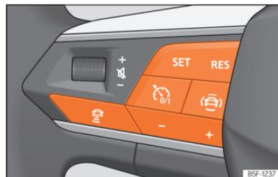
**Fig. 118** No volante multifunções: botões para utilizar o ACC.
