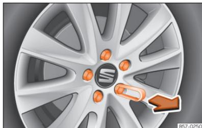
**Fig. 224** Roda: parafusos de roda com protetores.
