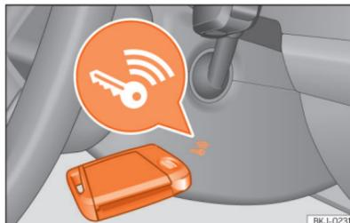
**Fig. 98** À direita da coluna de direção: arranque de emergência.
