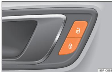
**Fig. 54** Na porta do condutor: botão do fecho centralizado.
