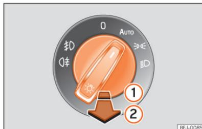
**Fig. 83** Painel de instrumentos: comando das luzes.
