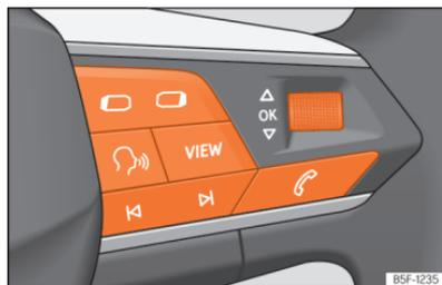
**Fig. 12** Lado direito do volante multifunções: botões para utilizar os menus e as indicações informativas do painel de instrumentos (segunda versões).
