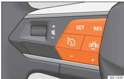
**Fig. 114** No volante multifunções: botões para utilizar o regulador de velocidade.
