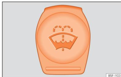
**Fig. 212** No compartimento do motor: tampa de cor azul do depósito do limpa-vidros.
