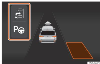
**Fig. 142** No ecrã do painel de instrumentos: visualização do sistema de estacionamento assistido com visualização reduzida.
