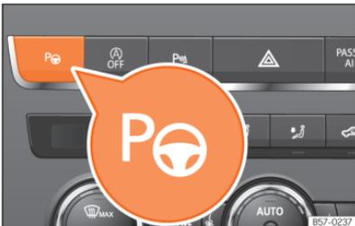
**Fig. 141** Na parte superior da consola central: botão para ligar o sistema de estacionamento assistido.
