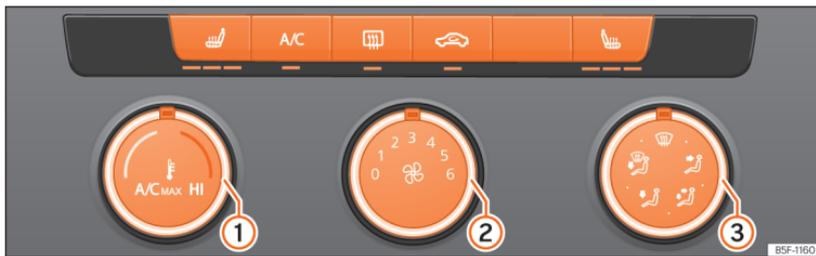
**Fig. 93** Na consola central: comandos do ar condicionado manual.
