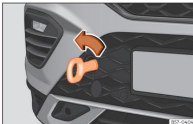
**Fig. 198** Parte direita do para-choques dianteiro: argola de reboque enroscada.
