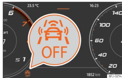
**Fig. 126** No ecrã do painel de instrumentos: indicação de Front Assist desativado.
