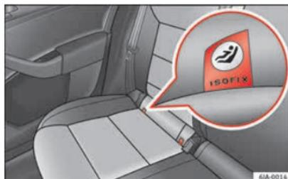
Fig. 24 Anéis de fixação ISOFIX.
