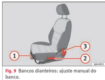
Fig. 9 Bancos dianteiros: ajuste manual do banco.
