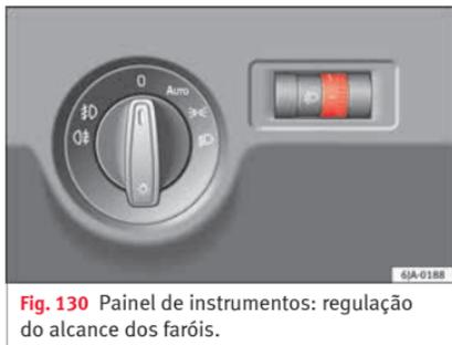
**Fig. 130** Painel de instrumentos: regulação do alcance dos faróis.
