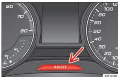
**Fig. 111** Painel de instrumentos: conta-quilómetros e botão de retrocesso.
