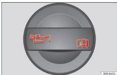
Fig. 50 Tampão do bocal de enchimento do óleo do motor no compartimento do motor.
