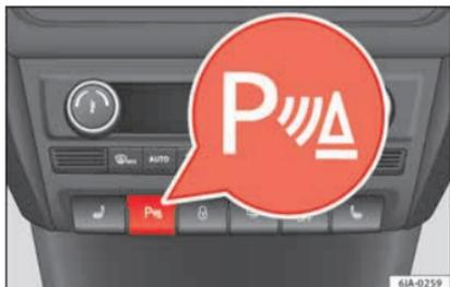
**Fig. 182** Consola central: botão de auxílio de estacionamento.
