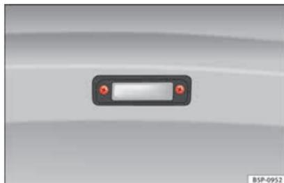
**Fig. 107** Desmontagem da iluminação da placa da matrícula.
