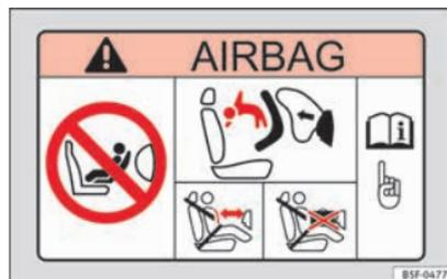
Fig. 22 Pala do sol do lado do passageiro: autocolante do airbag.
