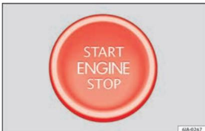
**Fig. 173** Na coluna da direção: botão de arranque do sistema de fecho e arranque sem chave Keyless Access. Nos veículos com direção à direita, a disposição é simétrica.
