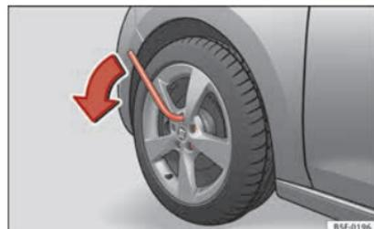
Fig. 62 Substituição de roda: desapertar os parafusos da roda.
