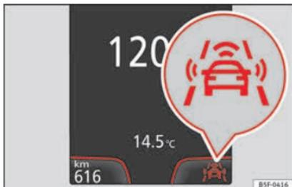
**Fig. 190** No ecrã do painel de instrumentos: indicação de Front Assist desativado.
