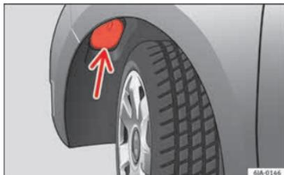
**Fig. 91** Substituição da lâmpada dos médios: cava das rodas.
