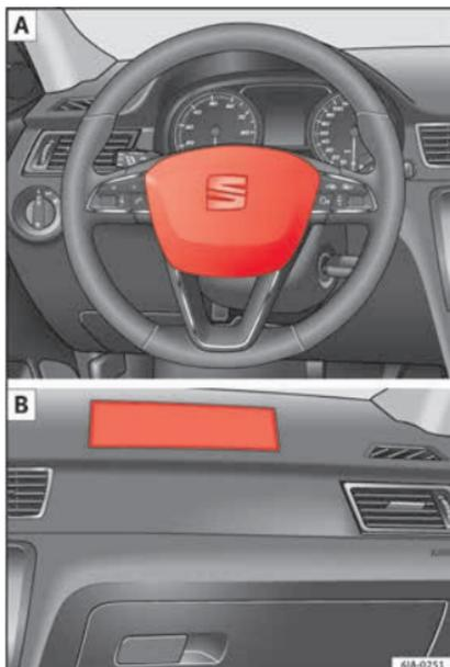
**Fig. 15** Airbag do condutor no volante e airbag do passageiro no painel de instrumentos.
