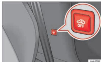
**Fig. 125** Botão para a vigilância do habitáculo e o controlo do sistema antirreboque.
