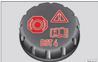
Fig. 52 Compartimento do motor: tampão do depósito do líquido dos travões.
