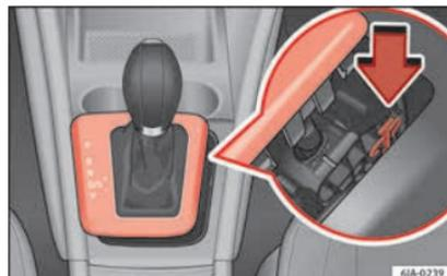
**Fig. 44** Desbloqueio de emergência da alavanca de seleção.
