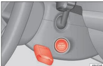
**Fig. 174** Arranque de emergência em veículos com Keyless Access.
