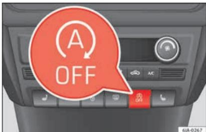
**Fig. 193** Painel de instrumentos: botão do sistema Start/Stop.
