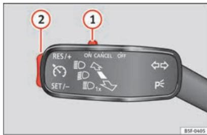
Fig. 187 Manípulo das luzes indicadoras de mudança de direção e dos máximos: botões do regulador de velocidade.
