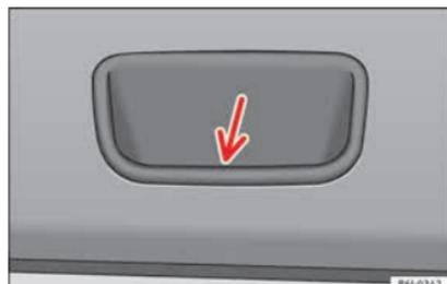
**Fig. 127** Pormenor do revestimento interior da porta da mala: cavidade para puxar.
