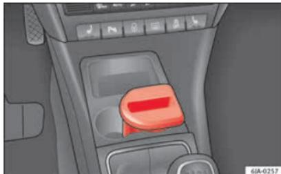
Fig. 155 Consola central à frente: compartimento multimédia.
