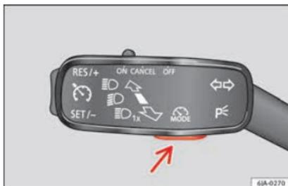
**Fig. 191** Na alavanca das luzes indicadoras de mudança de direção e dos máximos: botão para os sistemas de assistência à condução.
