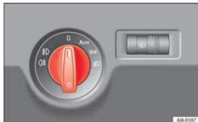
**Fig. 129** Painel de instrumentos: comando das luzes.
