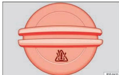
Fig. 51 Compartimento do motor: tampão do depósito de compensação do líquido de refrigeração.
