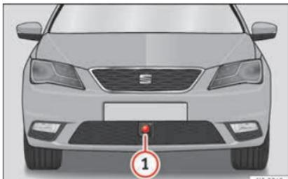
**Fig. 189** No para-choques à frente: sensor de radar.
