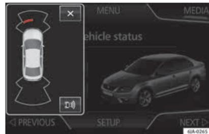
**Fig. 183** Indicação em miniatura da ativação automática
