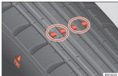
Fig. 213 Perfil dos pneus com indicadores de desgaste.
