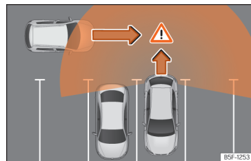
Fig. 124 Representação esquemática do assistente de saída do estacionamento: zona vigiada ao redor do veículo que está a sair do estacionamento.
