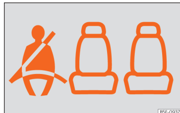
Fig. 21 Painel de instrumentos: indicação do estado dos cintos de segurança dos lugares traseiros.
