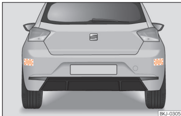
Fig. 100 Vista traseira do veículo: zonas dos sensores de radar.
