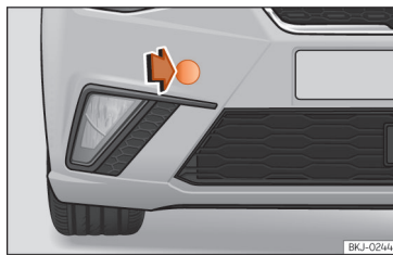
Fig. 156 No lado direito do para-choques dianteiro: retirar a tampa.
