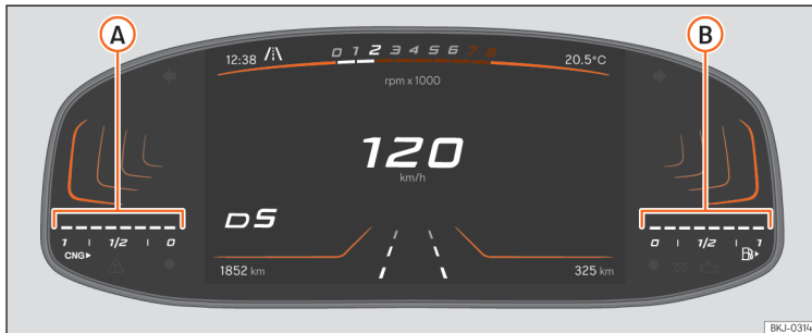
Fig.7 Painel de instrumentos: indicador de nível de gás natural
