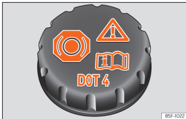
Fig. 174 Compartimento do motor: tampa do depósito do líquido dos travões.
