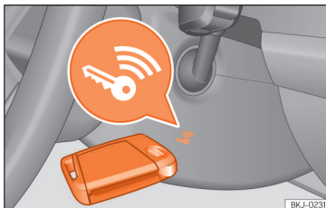
Fig. 87 À direita da coluna de direção: arranque de emergência.
