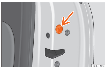
Fig. 87 Trancagem de emergência da porta.
