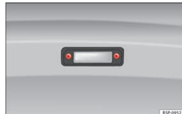
Fig. 162 Desmontagem da iluminação da placa da matrícula.
