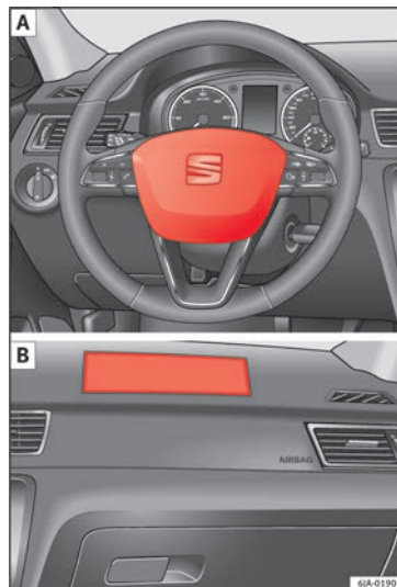
Fig. 12 Airbag do condutor no volante e airbag do passageiro no painel de instrumentos.
