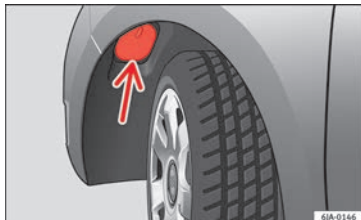
Fig. 146 Substituição da lâmpada dos médios: cava das rodas.
