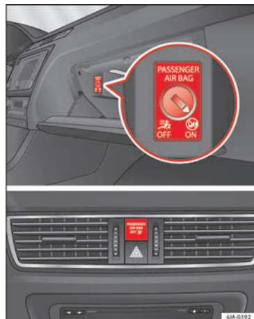
Fig. 18 Interruptor do airbag frontal do passageiro/luz de controlo de desativação de airbag do passageiro.
