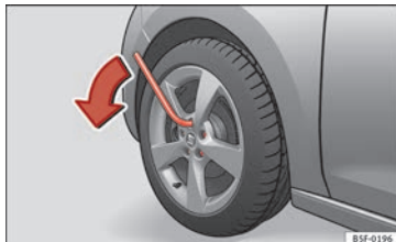
Fig. 124 Substituição de roda: desapertar os parafusos da roda.
