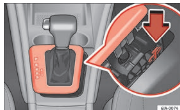
Fig. 135 Desbloqueio de emergência da alavanca de seleção.
