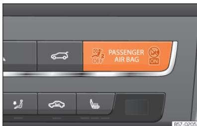
**Fig. 30** Painel de instrumentos: luz de controle da desativação do airbag do passageiro.
