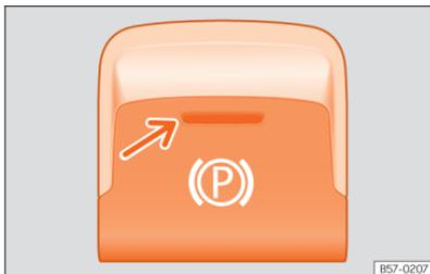
**Fig. 131** Na parte inferior da consola central: botão do travão de estacionamento eletrônico.
