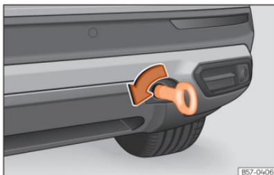
**Fig. 197** No lado direito do para-choques traseiro: argola de reboque enroscada.
