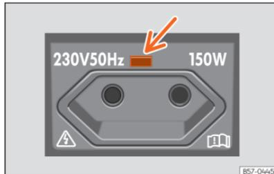
**Fig. 156** No lado esquerdo da bagageira: tomada de corrente de 230 volts.
