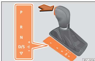
**Fig. 101** Bloqueio da alavanca seletora.
