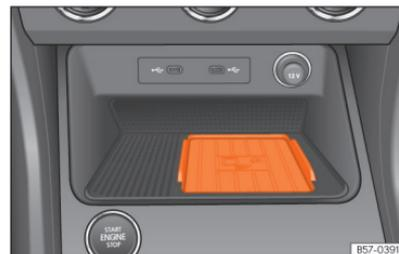
**Fig. 165** Na consola central: alojamento para a ligação do telemóvel.
