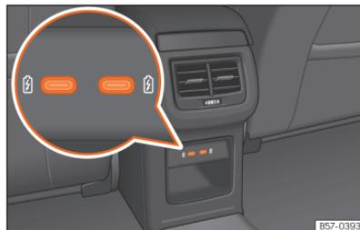
**Fig. 158** Parte posterior consola central: conectores USB com função de tomada de corrente.
