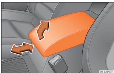
**Fig. 80** Apoio de braços central dianteiro.
