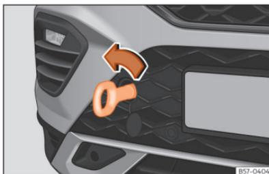
**Fig. 195** Parte direita do para-choques dianteiro: argola de reboque enroscada.
