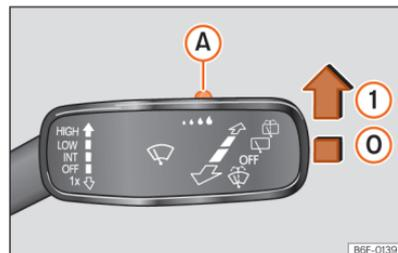
**Fig. 87** Manípulo do limpavidros: ajustar o sensor de chuva (A).
