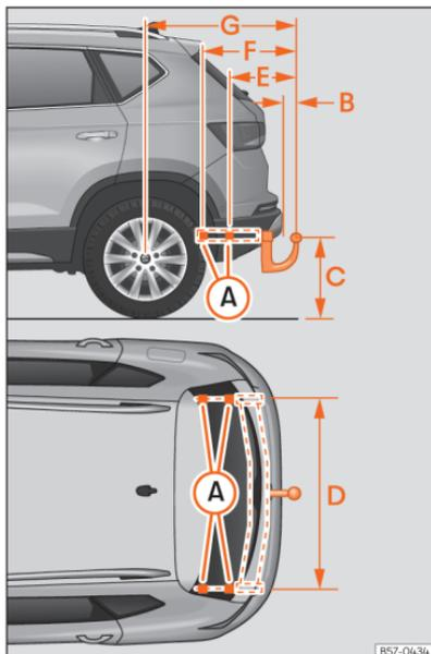
**Fig. 184** Quotas e pontos de fixação para a montagem posterior de um dispositivo de reboque.
