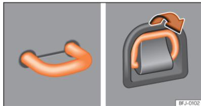
**Fig. 173** Na bagageira: argola de fixação.
