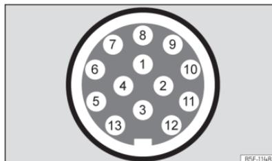
**Fig. 180** Representação esquemática: atribuição dos pinos da tomada de corrente para reboque.
