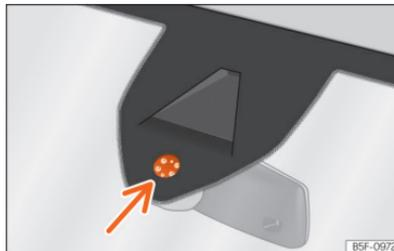
**Fig. 94** Sensor de humidade e temperatura do para-brisas.
