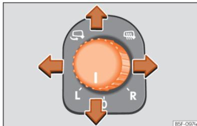
**Fig. 90** Pormenor da porta do condutor: comando do espelho retrovisor exterior.
