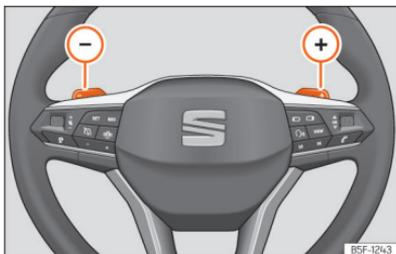
**Fig. 103** Volante: alavancas para mudança automática de velocidades.
