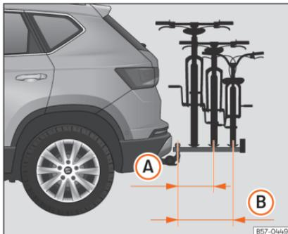
**Fig. 183** Representação esquemática da saliência máxima da carga num porta-bicicletas para duas ou três bicicletas.
