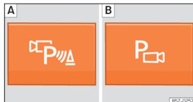
**Fig. 147** Consola central: botão para ativar/desativar manualmente o sistema de visão periférica quando está em combinação com o sistema de estacionamento assistido [A] ou com o sistema Park Pilot traseiro [B].
