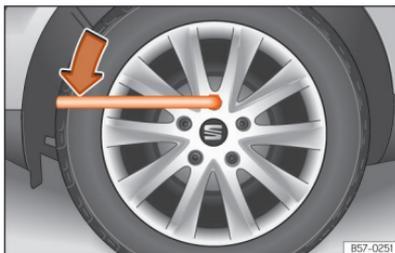
**Fig. 223** Troca de roda: desapertar os parafusos de roda.
