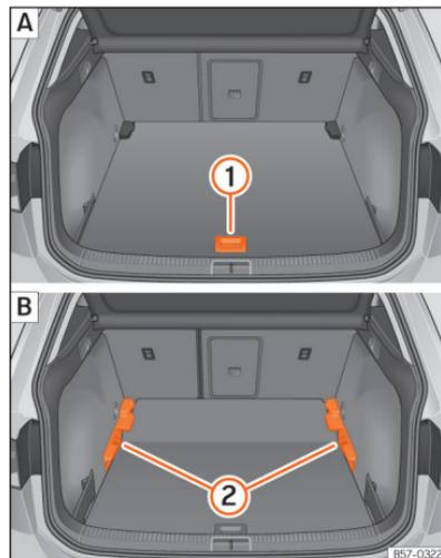
**Fig. 170** Piso variável da bagageira: **A** posição alta; **B** posição baixa.
