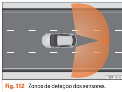
**Fig. 112** Zonas de deteção dos sensores.
