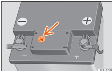
**Fig. 214** Janela de inspeção na parte superior da bateria de 12 volts (representação esquemática).
