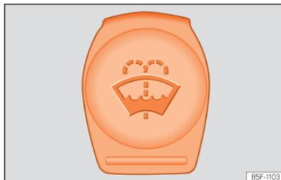
**Fig. 209** No compartimento do motor: tampa de cor azul do depósito do limpa-vidros.
