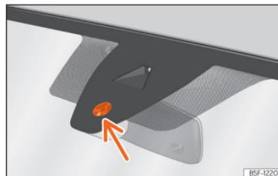
**Fig. 88** Superfície sensível do sensor de chuva.
