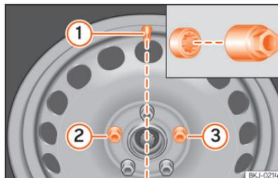
**Fig. 224** Troca de roda: válvula do pneu (1) e local de montagem do parafuso da roda antirroubo (2) ou (3).
