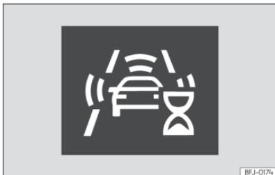
**Fig. 122** No ecrã do painel de instrumentos: indicação de autocalibração inicial do sistema.
