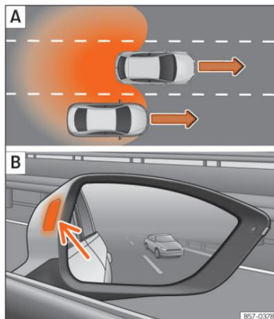
**Fig. 130** Esquema: **A** Ultrapassagem na faixa de rodagem central e incorporação posterior na faixa de rodagem direita. **B** Indicação do assistente de mudança de faixa no lado direito.
