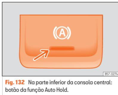
**Fig. 132** Na parte inferior da consola central: botão da função Auto Hold.
