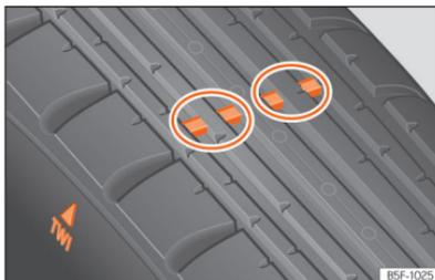
**Fig. 216** Perfil do pneu: indicadores de desgaste.
