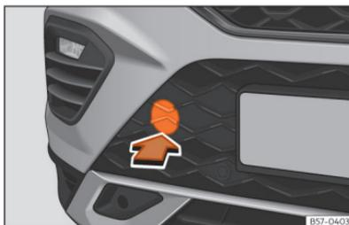
**Fig. 194** No lado direito do para-choques dianteiro: retirar a tampa.
