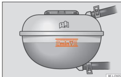
**Fig. 206** No compartimento dianteiro: marca no depósito de expansão do líquido de refrigeração.
