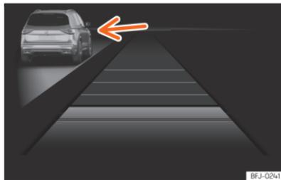
**Fig. 118** No ecrã do painel de instrumentos: ACC ativo, veículo detetado pela esquerda.
