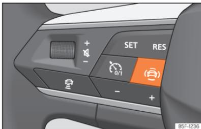
**Fig. 107** Lado esquerdo do volante multifunções: botão para os sistemas de assistência à condução [conforme versões].
