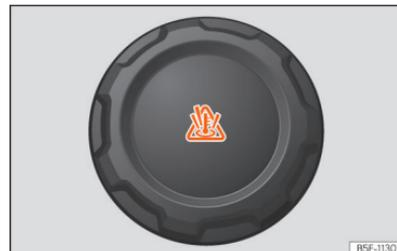
**Fig. 207** Compartimento dianteiro: tampão do depósito de expansão do líquido de refrigeração.
