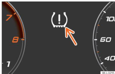
**Fig. 227** Painel de instrumentos: aviso de perda de pressão dos pneus.
