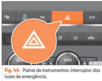
**Fig. 44** Painel de instrumentos: interruptor das luzes de emergência.
