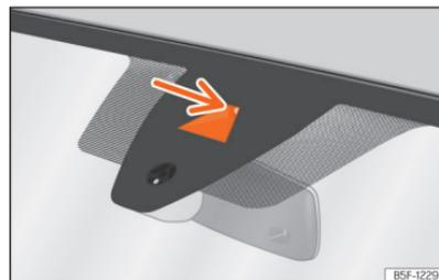
**Fig. 110** No para-brisas: área de campo visual do sistema de aviso de saída da faixa de rodagem.
