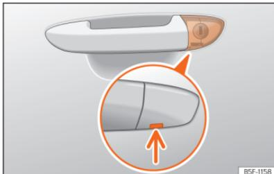
**Fig. 55** Manípulo da porta do condutor: canhão da fechadura oculto.
