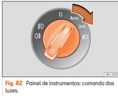
**Fig. 82** Painel de instrumentos: comando das luzes.
