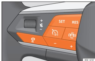
**Fig. 117** No volante multifunções: botões para utilizar o ACC.
