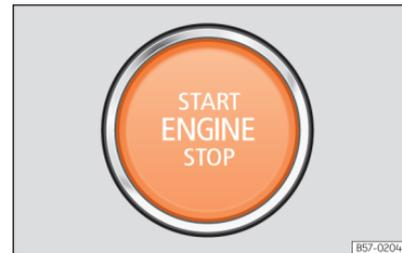
**Fig. 97** Na parte inferior da consola central: botão de arranque.
