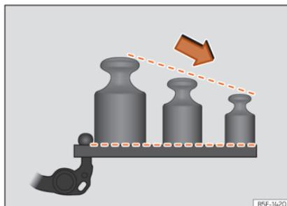
**Fig. 182** Distribuição recomendada do peso no sistema de carga traseiro.
