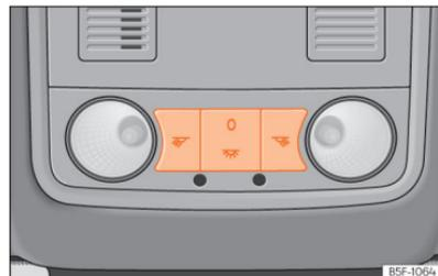
**Fig. 85** Pormenor do revestimento do tejadilho: iluminação dianteira do habitáculo.
