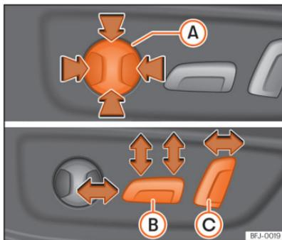
**Fig. 73** Banco do condutor: regular o banco eletricamente
