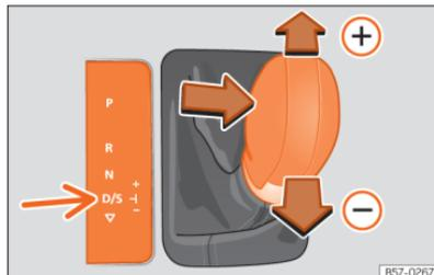
**Fig. 102** Alavanca seletora na posição Tiptronic
