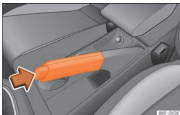
Fig. 162 Travão de mão entre os bancos dianteiros.
