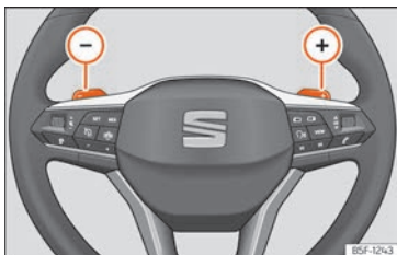
Fig. 136 Volante: alavancas de mudança automática de velocidade.
