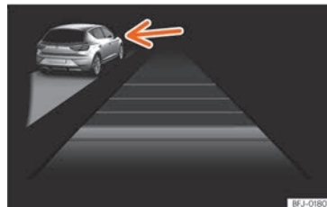
Fig. 151 No ecrã do painel de instrumentos: ACC ativo, veículo detetado pela esquerda
