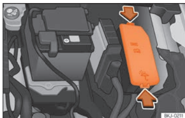
Fig. 49 No compartimento do motor: tampa da caixa de fusíveis.
