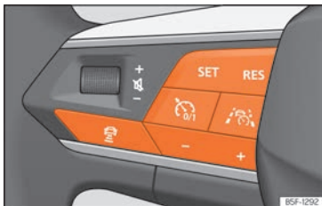
Fig. 157 Lado esquerdo do volante multifunções: botões para a utilização do Travel Assist.
