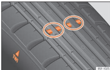
Fig. 203 Perfil do pneu: indicadores de desgaste.
