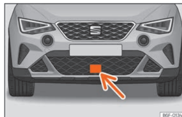
Fig. 139 No para-choques dianteiro: sensor de radar.
