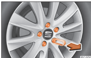
Fig. 33 Roda: parafusos da roda com protetores.
