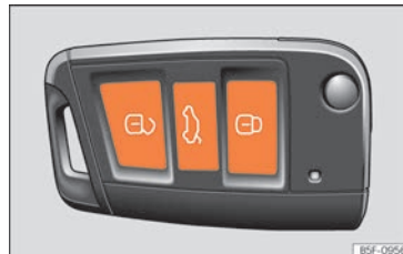
Fig. 81 Chave com comando à distância: botões.
