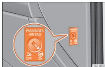
Fig. 16 Comutador com chave para ativar e desativar o airbag do passageiro.
