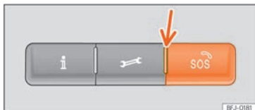
Fig. 29 Na consola do tejadilho: comandos para os serviços de voz
