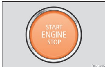
Fig. 130 Na parte inferior da consola central: botão de arranque.
