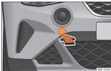
Fig. 44 Parte direita do para-choques dianteiro: retirar a tampa.
