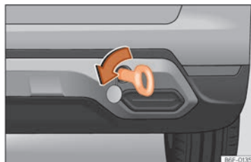
Fig. 47 No lado direito do para-choques traseiro: argola de reboque enroscada.
