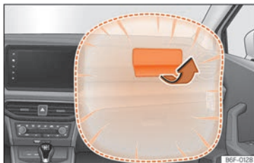
Fig. 15 Airbag do passageiro no painel de instrumentos.
