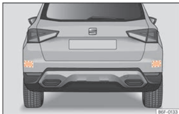
Fig. 142 Vista traseira do veículo: zonas dos sensores de radar.
