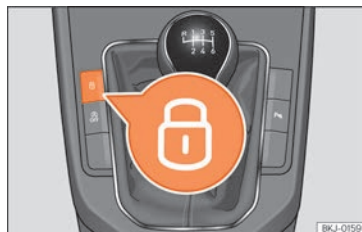
Fig. 82 Consola central: botão do fecho centralizado.
