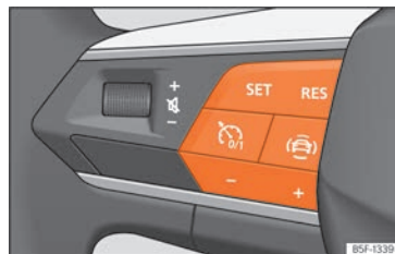
Fig. 145 No volante multifunções: botões para utilizar o regulador de velocidade
