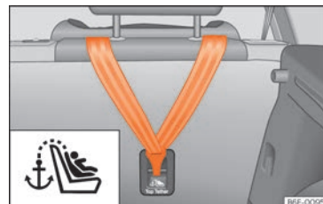
Fig. 27 Parte posterior dos bancos traseiros: argolas de fixação para o cinto Top Tether.
