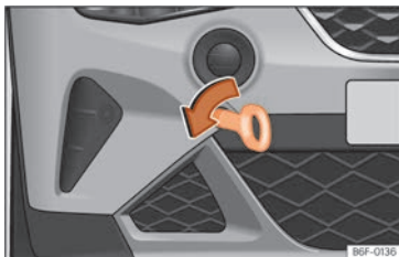
Fig. 45 Parte direita do para-choques dianteiro: argola de reboque enroscada.
