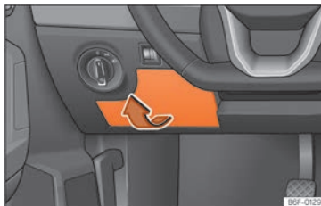
Fig. 48 No painel de instrumentos do lado do condutor: tampa da caixa de fusíveis.
