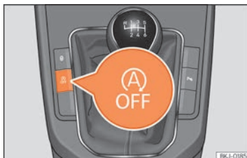
Fig. 132 Consola central: botão do sistema Start/Stop.
