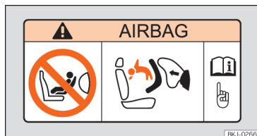
Fig. 22 Autocolante do airbag: na pala do sol do lado do passageiro
