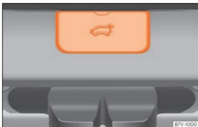
Fig. 107 Pormenor da bagageira: acesso à destrançagem de emergência.
