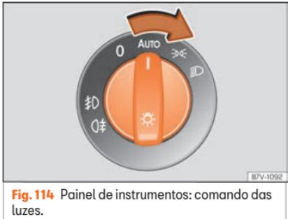
**Fig. 114** Painel de instrumentos: comando das luzes.
