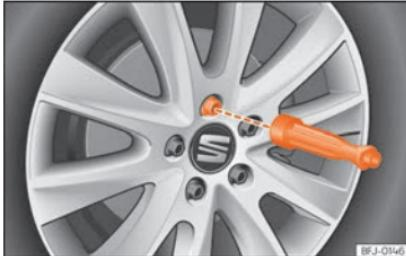
**Fig. 49** Substituição da roda: desenroscar os parafusos de roda com o cabo da chave de parafusos.
