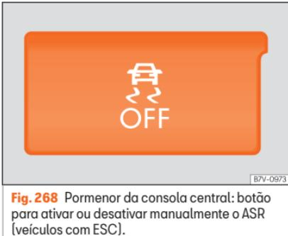
**Fig. 268** Pormenor da consola central: botão para ativar ou desativar manualmente o ASR (veículos com ESC).
