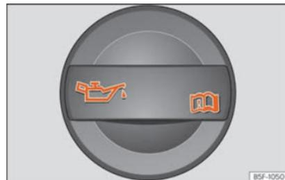
**Fig. 289** Tampão do bocal de enchimento do óleo do motor no compartimento do motor.
