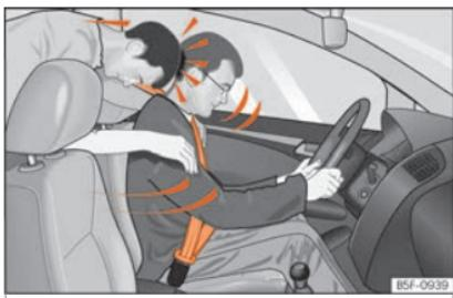
**Fig. 9** O passageiro do banco traseiro que não tiver colocado o cinto de segurança é projetado para cima do condutor que tem o cinto colocado.
