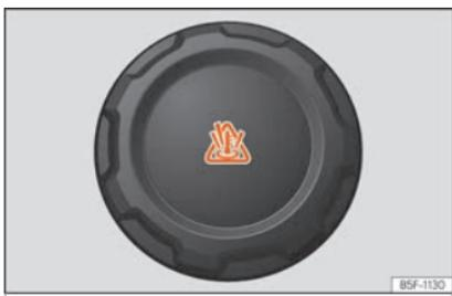
**Fig. 291** Compartimento do motor: tampão do depósito de compensação do líquido de refrigeração.
