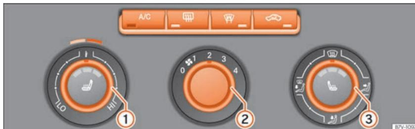
**Fig. 174** Na consola central: comandos do ar condicionado manual.
