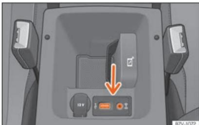
**Fig. 231** Apoio de braços central dianteiro: entrada USB/AUX-IN.
