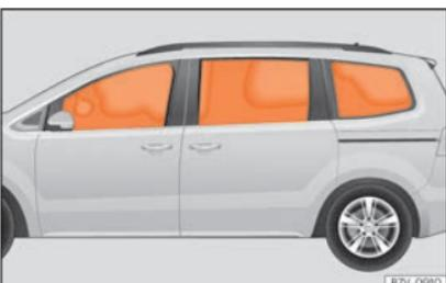
**Fig. 25** Airbags da cabeça insuflados.
