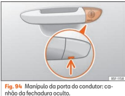
**Fig. 94** Manípulo da porta do condutor: cañhão da fechadura oculto.
