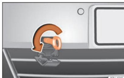
**Fig. 56** Na parte direita do para-choques dianteiro: enroscar a argola de reboque.
