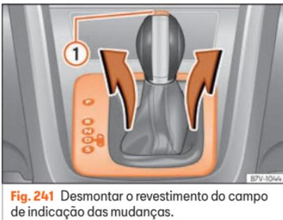
**Fig. 241** Desmontar o revestimento do campo de indicação das mudanças.
