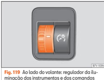
**Fig. 119** Ao lado do volante: regulador da iluminação dos instrumentos e dos comandos
