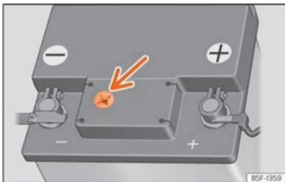
**Fig. 294** Janela de inspeção na parte superior da bateria de 12 volts [representação esquemática].
