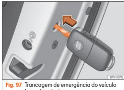
**Fig. 97** Trancagem de emergência do veículo com a chave do veículo.
