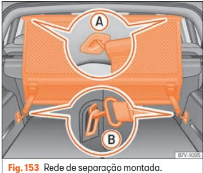
**Fig. 153** Rede de separação montada.
