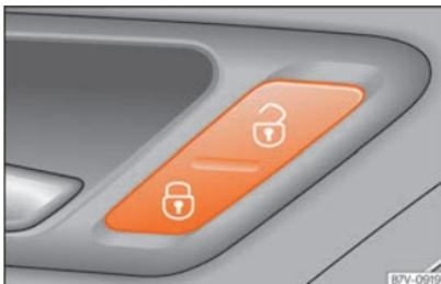
**Fig. 90** Porta do condutor: interruptor do fecho centralizado.
