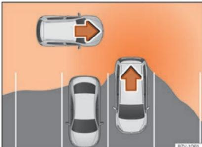
**Fig. 265** Representação esquemática do assistente de saída de estacionamento: zona visada ao redor do veículo que está a sair do estacionamento.
