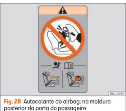
**Fig. 28** Autocolante do airbag: na moldura posterior da porta do passageiro
