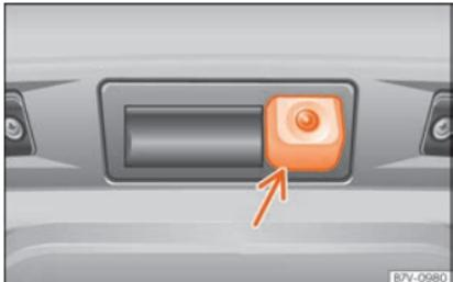
**Fig. 249** No para-choques traseiro: localização da câmara do assistente de marcha-atrás.
