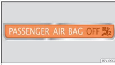
Fig. 19 Luz de controlo, no painel de instrumentos, da desativação do airbag dianteiro do passageiro.
