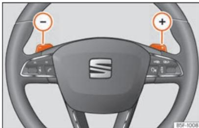
**Fig. 240** Volante com duas patilhas para o Tiptronic.
