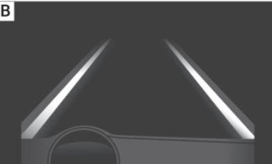
**Fig. 260** No ecrã do painel de instrumentos: Indicação no ecrã do sistema de aviso de saída da faixa de rodagem [exemplo 1].
