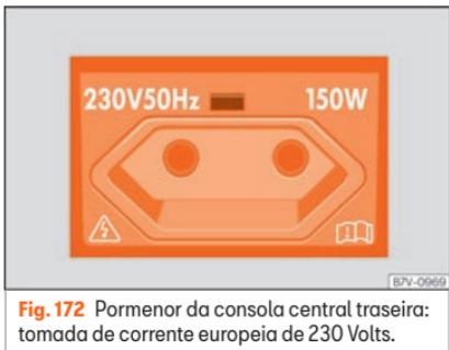
**Fig. 172** Pormenor da consola central traseira: tomada de corrente europeia de 230 Volts.
