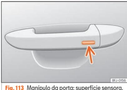
**Fig. 113** Manípulo da porta: superfície sensora.
