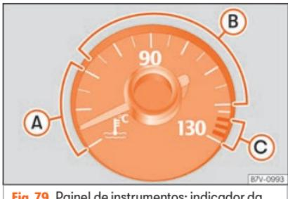
**Fig. 79** Painel de instrumentos: indicador da temperatura do líquido de refrigeração do motor.
