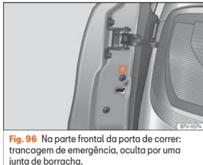
**Fig. 96** Na parte frontal da porta de correr: trancagem de emergência, oculta por uma junta de borracha.
