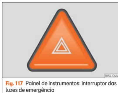
**Fig. 117** Painel de instrumentos: interruptor das luzes de emergência
