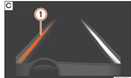
**Fig. 261** No ecrã do painel de instrumentos: Indicação no ecrã do sistema de aviso de saída da faixa de rodagem [exemplo 2].
