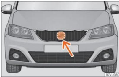
Fig. 244 No para-choques dianteiro: sensor de radar.
