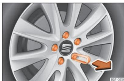
**Fig. 43** Roda: parafusos da roda com protetores.
