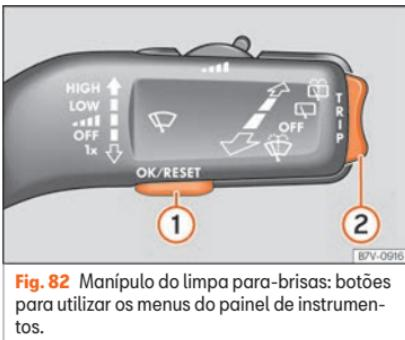
**Fig. 82** Manípulo do limpá-vidros: botões para utilizar os menus do painel de instrumentos.
