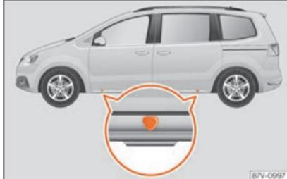
**Fig. 47** Pontos de apoio do macaco.
