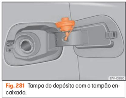
**Fig. 281** Tampa do depósito com o tampão encaixado.
