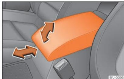
Fig. 140 Apoio de braços central dianteiro.
