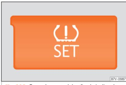
**Fig. 298** Consola central: botão do indicador da pressão dos pneus.
