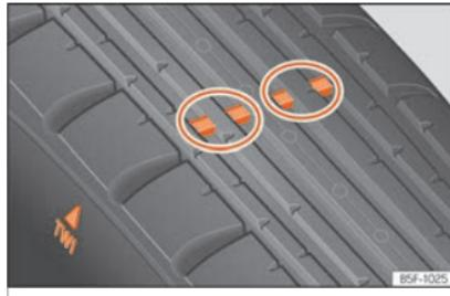
Fig. 296 Perfil do pneu: indicadores de desgaste.
