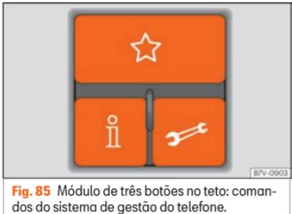
**Fig. 85** Módulo de três botões no teto: comandos do sistema de gestão do telefone.
