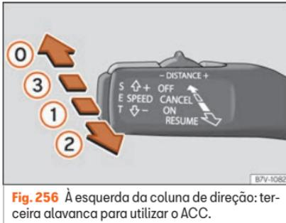
**Fig. 256** À esquerda da coluna de direção: terceira alavanca para utilizar o ACC.
