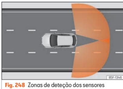
**Fig. 248** Zonas de deteção dos sensores
