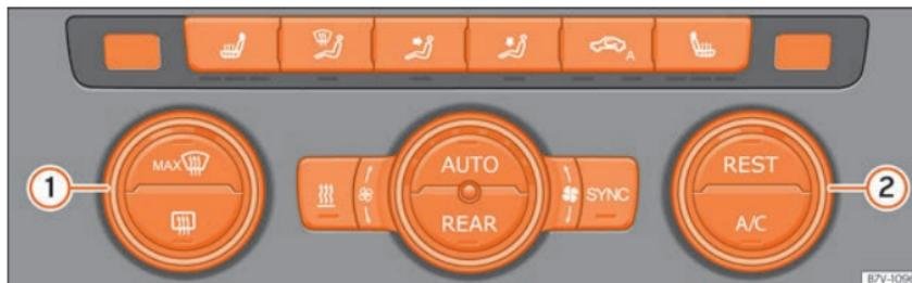
**Fig. 173** Na consola central: comandos do Climatronic.
