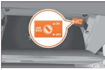
Fig. 18 No porta-luvas, no lado do passageiro: interruptor de chave para ativar e desativar o airbag dianteiro do passageiro.
