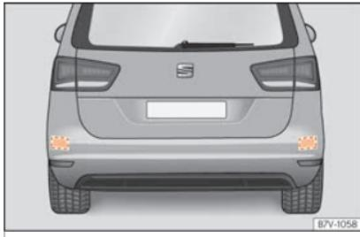
**Fig. 247** Vista traseira do veículo: zonas dos sensores de radar.
