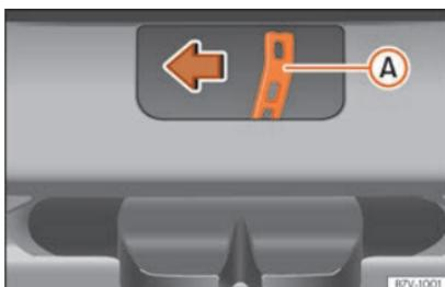
Fig. 108 Pormenor da bagageira: destrançagem de emergência.
