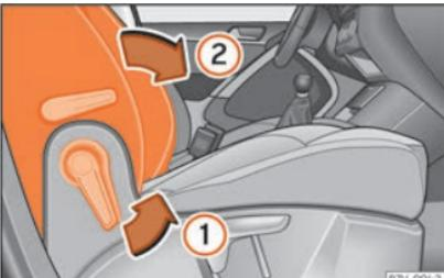
Fig. 138 Banco dianteiro do passageiro: rebater o encosto do banco para a frente.
