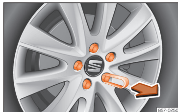
Fig. 244 Roda: parafusos de roda com protetores.
