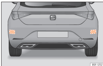
Fig. 129 Vista traseira do veículo: zonas dos sensores de radar.
