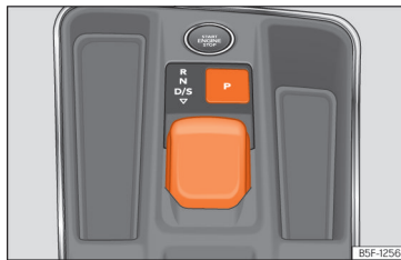
Fig. 122 Na consola central: comando seletor.
