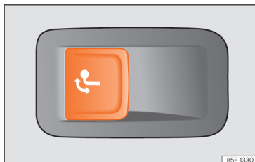
Fig. 204 No lado esquerdo da bagageira: botão para desbloquear o gancho de reboque.
