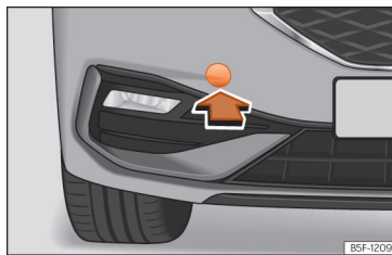
Fig. 217 No lado direito do para-choques dianteiro: retirar a tampa.
