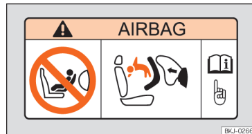
Fig. 41 Autocolante do airbag: na pala do sol do lado do passageiro.
