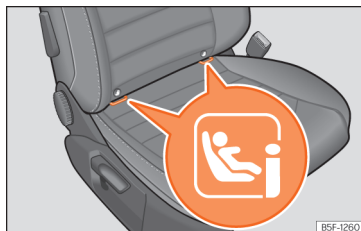
Fig. 44 Banco passageiro dianteiro: localização dos anéis de fixação i-Size.
