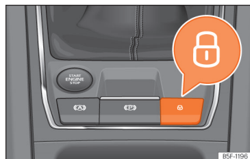
Fig. 76 Na consola central: botão do fecho centralizado.
