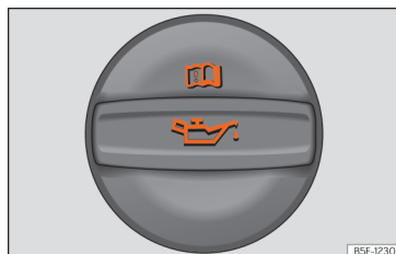
Fig. 234 Tampa do bocal de enchimento do óleo do motor no compartimento do motor.
