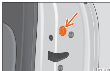
Fig. 78 Trancagem de emergência da porta.
