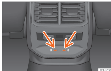
Fig. 172 Parte posterior consola central: conectores USB com função de tomada de corrente.
