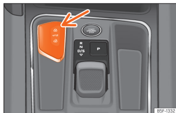
Fig. 69 Consola central: alojamento para a chave do veículo.
