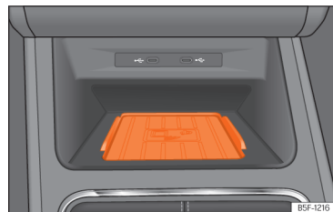
Fig. 179 Na consola central: alojamento para a ligação do telemóvel.
