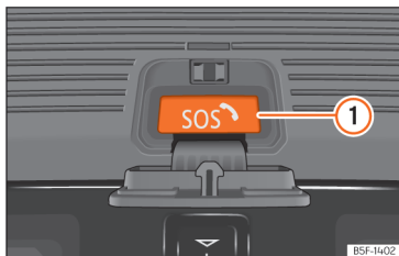
Fig. 53 Botão para chamada de emergência.
