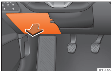
Fig. 221 No painel de instrumentos do lado do condutor: tampa da caixa de fusíveis.
