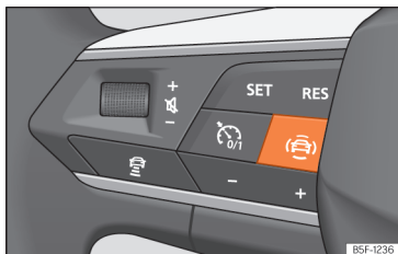
Fig. 125 Lado esquerdo do volante multifunções: botão para os sistemas de assistência à condução (conforme versões).
