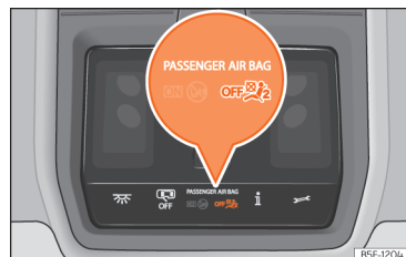
Fig. 32 Na consola do tejadilho: luz de desativação do airbag do passageiro.
