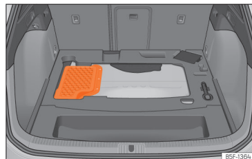
Fig. 235 Veículos híbridos (PHEV): localização da bateria na bagageira
