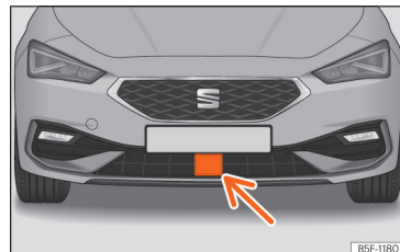
Fig. 126 No para-choques dianteiro: sensor de radar.
