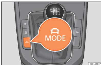
**Fig. 93** Junto à alavanca da caixa de velocidades: tecla MODE.
