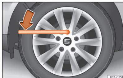
**Fig. 187** Troca de roda: desapertar os parafusos de roda.
