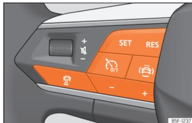
**Fig. 105** No volante multifunções: botões para utilizar o ACC.
