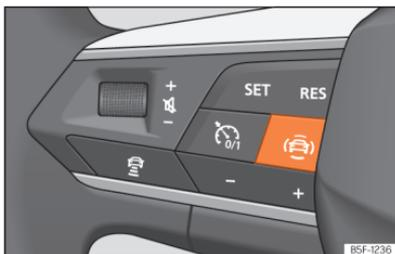
**Fig. 95** Lado esquerdo do volante multifunções: botão para os sistemas de assistência à condução (conforme versões).
