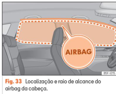
**Fig. 33** Localização e raio de alcance do airbag da cabeça.
