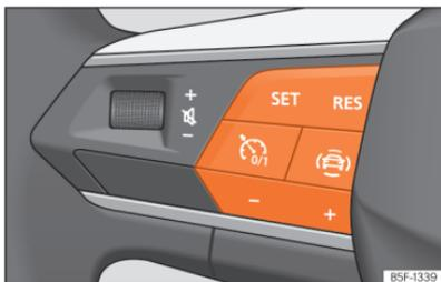
**Fig. 103** No volante multifunções: botões para utilizar o limitador de velocidade.
