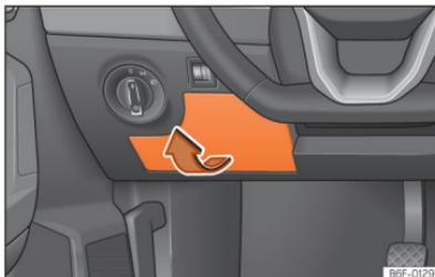
**Fig. 158** No painel de instrumentos do lado do condutor: tampa da caixa de fusíveis.
