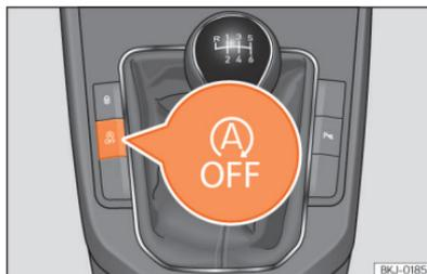
**Fig. 87** Consola central: botão do sistema Start-Stop.
