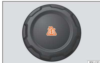
**Fig. 171** Compartimento dianteiro: tampão do depósito de expansão do líquido de refrigeração.
