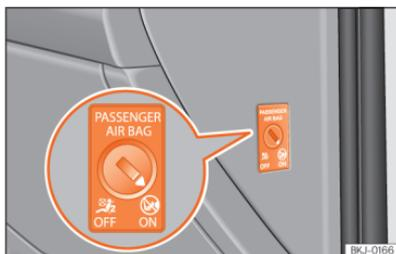
**Fig. 29** Computador com chave para ativar e desativar o airbag do passageiro.
