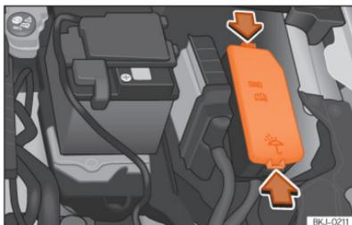
**Fig. 159** No compartimento do motor: tampa da caixa de fusíveis.
