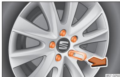
**Fig. 185** Roda: parafusos de roda com protetores.
