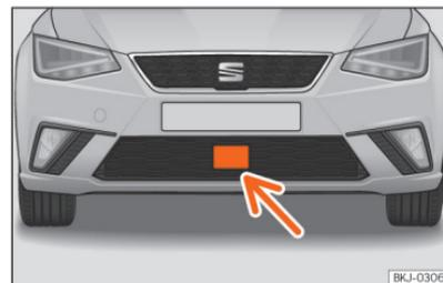
**Fig. 96** No para-choques dianteiro: sensor de radar.
