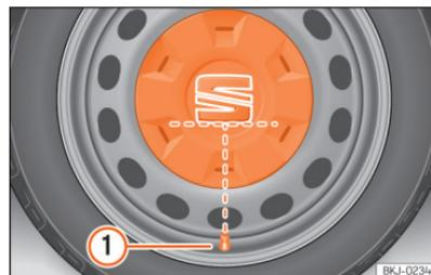
**Fig. 183** Colocação correta do tampão central da roda para jantes de aço.
