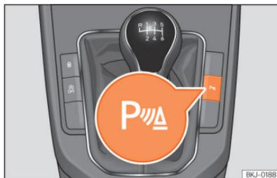
**Fig. 120** Consola central: botão do auxílio de estacionamento (consoante as versões).
