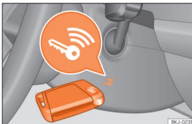
**Fig. 86** À direita da coluna de direção: arranque de emergência.
