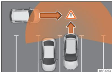
**Fig. 123** Representação esquemática do assistente de saída do estacionamento: zona vigiada ao redor do veículo que está a sair do estacionamento.
