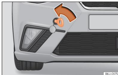
**Fig. 155** Parte direita do para-choques dianteiro: argola de reboque enroscada.
