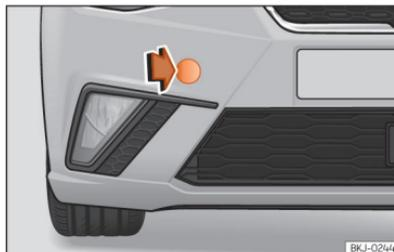
**Fig. 154** No lado direito do para-choques dianteiro: retirar a tampa.
