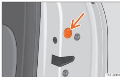
**Fig. 55** Trancagem de emergência da porta.
