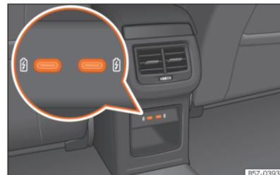
Fig. 157 Parte posterior consola central: conectores USB com função de tomada de corrente.
