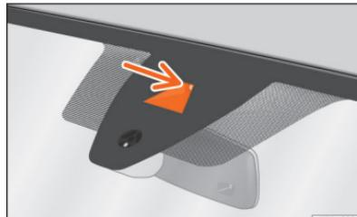
**Fig. 110** No para-brisa: área de campo visual do sistema de aviso de saída da faixa de rodagem.
