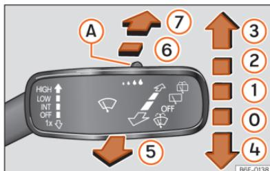
**Fig. 86** Utilização do limpador de vidro e do limpador traseiro.
