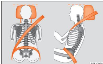
**Fig. 25** Faixa do cinto de segurança e o encosto de cabeça regulados corretamente, vistos de frente e de lado.
