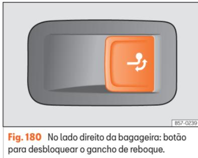
**Fig. 180** No lado direito da bagageira: botão para desbloquear o gancho de reboque.
