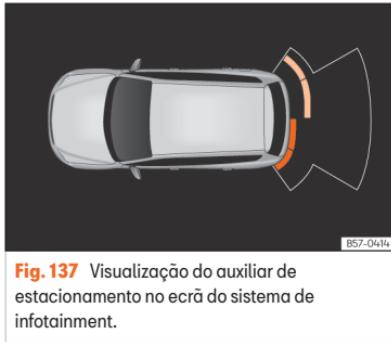
**Fig. 137** Visualização do auxiliar de estacionamento no ecrã do sistema de infotainment.
