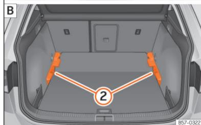
**Fig. 169** Piso variável da bagageira: **A** posição alta; **B** posição baixa.
