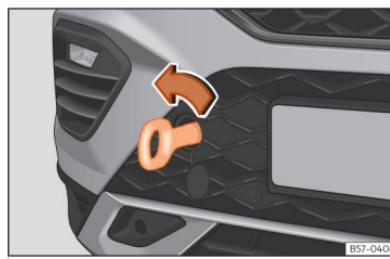
**Fig. 194** Parte direita do para-choques dianteiro: argola de reboque enroscada.
