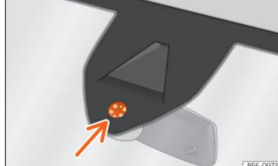
**Fig. 94** Sensor de humidade e temperatura do para-brisa.
