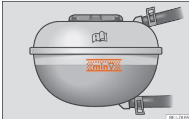
**Fig. 205** No compartimento dianteiro: marca no depósito de expansão do líquido de refrigeração.
