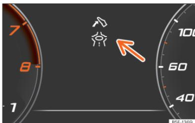
**Fig. 11** Indicação da assistência para uma condução ecoeficiente (representação esquemática).
