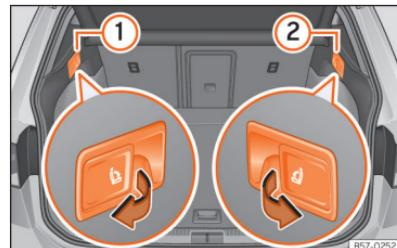
**Fig. 81** Na bagageira: alavancas para o desbloqueio do encosto traseiro.
