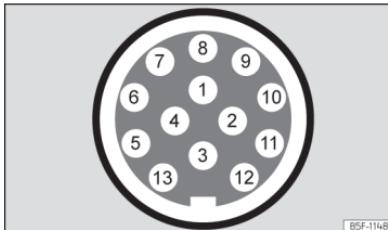
**Fig. 179** Representação esquemática: atribuição dos pinos da tomada de corrente para reboque.
