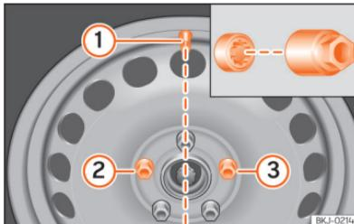
**Fig. 223** Troca de roda: válvula do pneu **1** e local de montagem do parafuso da roda antirroubo **2** ou **3**.
