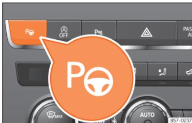
**Fig. 138** Na parte superior da consola central: botão para ligar o sistema de estacionamento assistido.
