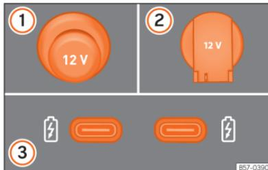
**Fig. 154** Tomadas de corrente de 12 Volts do veículo
