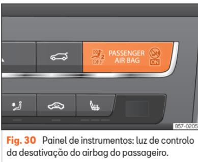
**Fig. 30** Painel de instrumentos: luz de controlo da desativação do airbag do passageiro.
