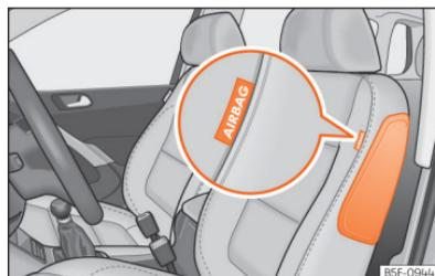
**Fig. 31** Airbag lateral no banco do condutor.
