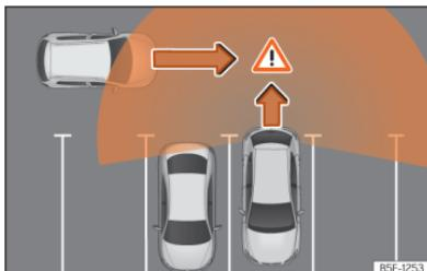
**Fig. 150** Representação esquemática do assistente de saída do estacionamento: zona vigiada ao redor do veículo que está a sair do estacionamento.
