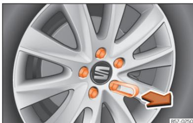
**Fig. 220** Roda: parafusos de roda com protetores.
