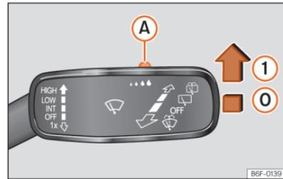
**Fig. 87** Manípulo do limpador traseiro: ajustar o sensor de chuva (A).
