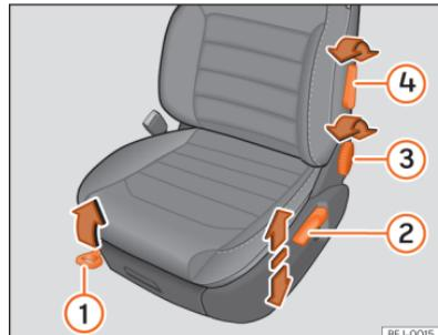
**Fig. 72** Bancos dianteiros: ajuste manual do banco.
