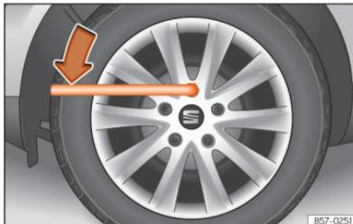
**Fig. 222** Troca de roda: desapertar os parafusos de roda.
