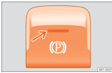
**Fig. 131** Na parte inferior da consola central: botão do travão de estacionamento eletrónico.
