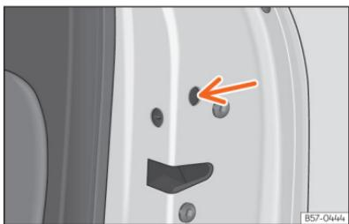
**Fig. 57** Trancagem de emergência da porta.
