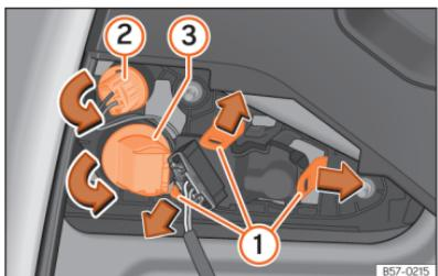
**Fig. 202** desmontar o porta-lâmpadas.
