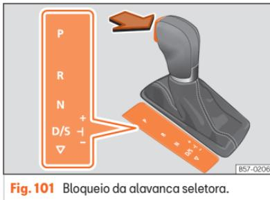
**Fig. 101** Bloqueio da alavanca seletora.
