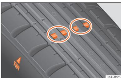
Fig. 215 Perfil do pneu: indicadores de desgaste.
