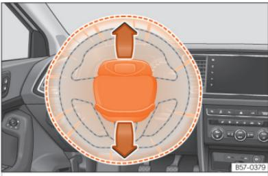
**Fig. 27** Airbag do condutor no volante.
