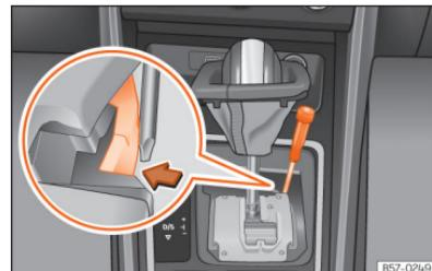
**Fig. 104** Alavanca seletora: desbloqueio de emergência na posição de estacionamento.
