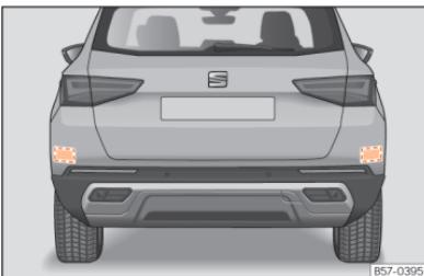
Fig. 111 Vista traseira do veículo: zonas dos sensores de radar.
