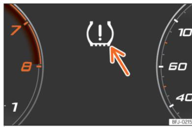
**Fig. 226** Painel de instrumentos: aviso de perda de pressão dos pneus.
