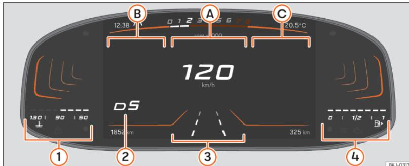
**Fig. 3** Painel de instrumentos digital versão Basic:
