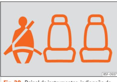
**Fig. 20** Painel de instrumentos: indicação do estado dos cintos de segurança dos lugares traseiros.
