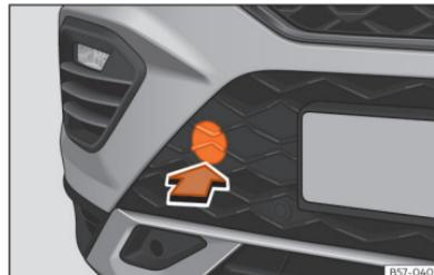
**Fig. 193** No lado direito do para-choques dianteiro: retirar a tampa.
