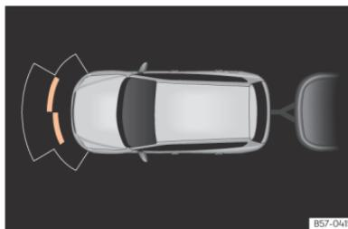
**Fig. 134** Visualização do Auxiliar de estacionamento no ecrã com reboque engatado.
