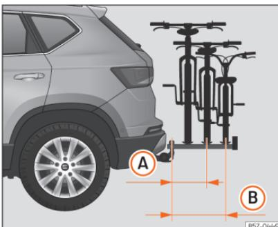
**Fig. 182** Representação esquemática da saliência máxima da carga num porta-bicicletas para duas ou três bicicletas.
