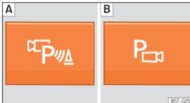
**Fig. 146** Consola central: botão para ativar/desativar manualmente o sistema de visão periférica quando está em combinação com o sistema de estacionamento assistido **[A]** ou com o sistema Park Pilot traseiro **[B]**.
