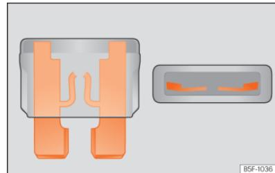
**Fig. 200** Representação de um fusível fundido.
