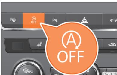
**Fig. 99** Consola central: botão do sistema Start-Stop.
