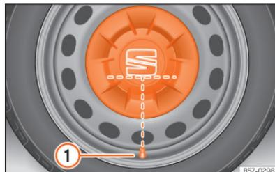
**Fig. 219** Colocação correta do tampão central da roda para jantes de aço.
