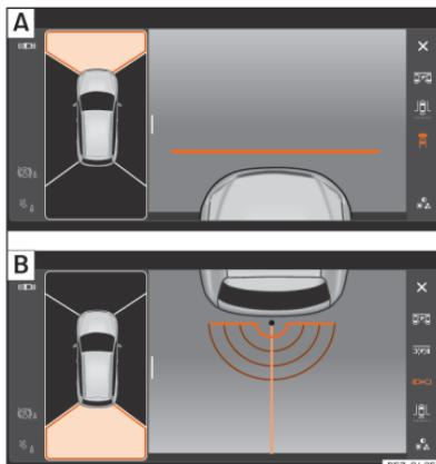
**Fig. 147** Visualização no ecrã do sistema de visão periférica: **A** Câmara dianteira; vista todo-o-terreno. **B** Câmara traseira; vista todo-o-terreno.
