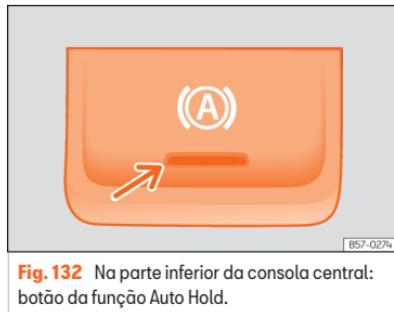
A função Auto Hold retém o veículo depois de parado e impede que se desloque sem necessidade de continuar a carregar no pedal do travão.
