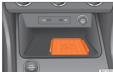
**Fig. 164** Na consola central: alojamento para a ligação do telemóvel.
