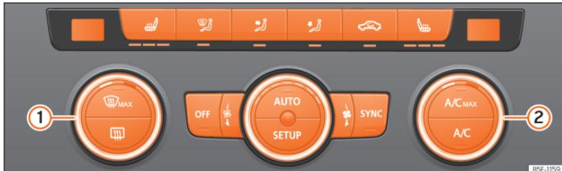
**Fig. 92** Na consola central: comandos do Climatronic.
