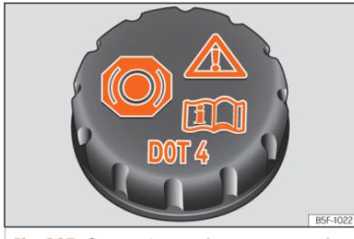
**Fig. 207** Compartimento do motor: tampa do depósito do líquido dos travões.
