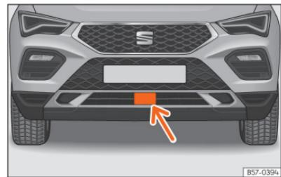
**Fig. 108** No para-choques dianteiro: sensor de radar.
