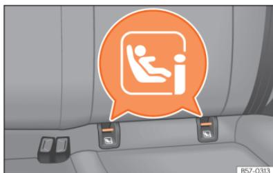
**Fig. 39** Banco traseiro: localização dos anéis de fixação ISOFIX ou i-Size.
