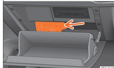
**Fig. 198** Veículos com volante à direita: tampa da caixa de fusíveis do painel de instrumentos, no lado do passageiro.
