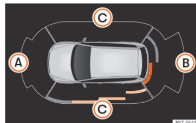
**Fig. 133** Visualização do auxiliar de estacionamento no ecrã do sistema de infotainment.
