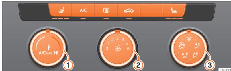
**Fig. 93** Na consola central: comandos do ar condicionado manual.
