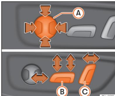
**Fig. 73** Banco do condutor: regular o banco eletricamente
