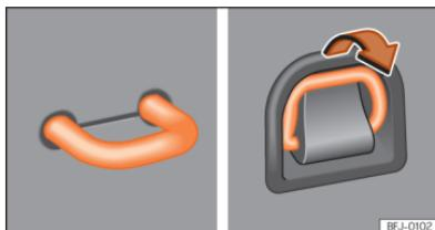
**Fig. 172** Na bagageira: argola de fixação.
