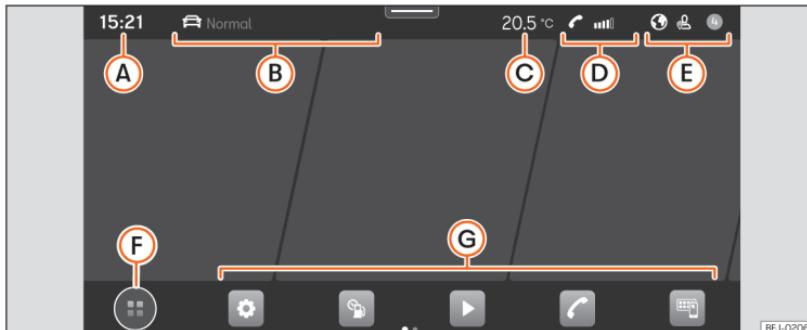
**Fig. 13** Esquema: Vista geral dos possíveis botões de função no ecrã.
