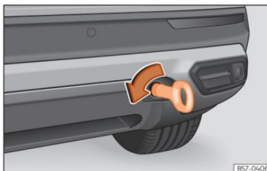
**Fig. 196** No lado direito do para-choques traseiro: argola de reboque enroscada.
