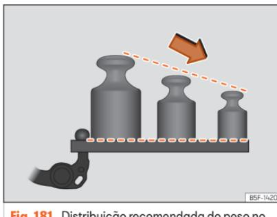
**Fig. 181** Distribuição recomendada do peso no sistema de carga traseiro.
