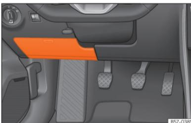
**Fig. 197** No painel de instrumentos do lado do condutor: tampa da caixa de fusíveis.
