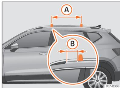
**Fig. 178** Pontos de fixação das barras longitudinais para o porta-bagagens de tejadilho.
