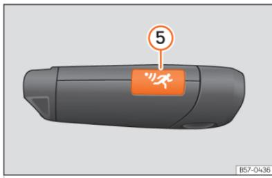
**Fig. 47** Chave do veículo com botão de alarme.
