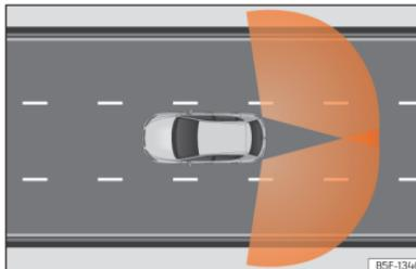
Fig. 112 Zonas de deteção dos sensores.
