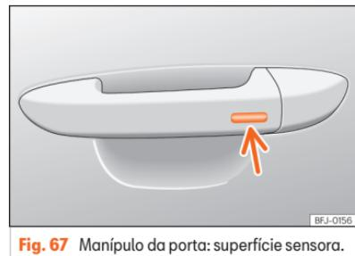
Fig. 67 Manípulo da porta: superfície sensora.
