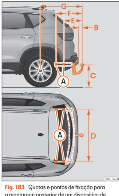
**Fig. 183** Quotas e pontos de fixação para a montagem posterior de um dispositivo de reboque.
