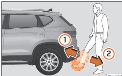
**Fig. 62** Porta da bagageira com abertura controlada por sensor (Easy Open)
