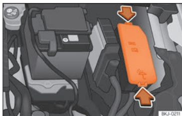
Fig. 51 No compartimento do motor: tampa da caixa de fusíveis.
