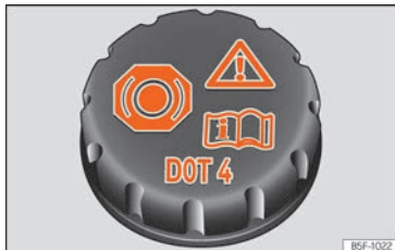
Fig. 286 Compartimento do motor: tampão do depósito do líquido dos travões.
