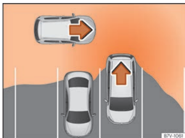
Fig. 244 Representação esquemática do assistente de saída de estacionamento: zona vigiada ao redor do veículo que está a sair do estacionamento.
