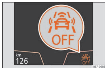
Fig. 229 No ecrã do painel de instrumentos: indicação de Front Assist desativado.
