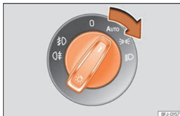
Fig. 104 Pannel de instrumentos: comando das luzes.
