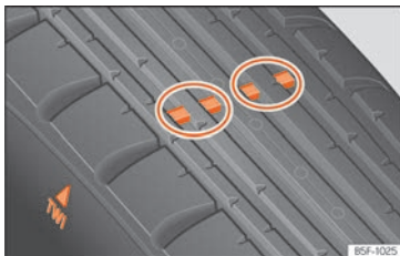
Fig. 289 Perfil do pneu: indicadores de desgaste.
