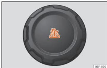
Fig. 285 Compartimento do motor: tampão do depósito de compensação do líquido de refrigeração.
