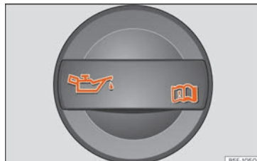
Fig. 283 Tampão do bocal de enchimento do óleo do motor no compartimento do motor.
