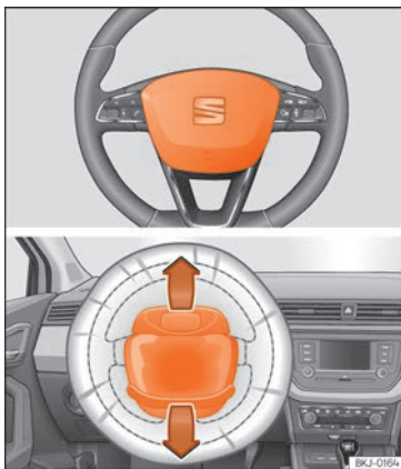
Fig. 15 Airbag do condutor no volante.
