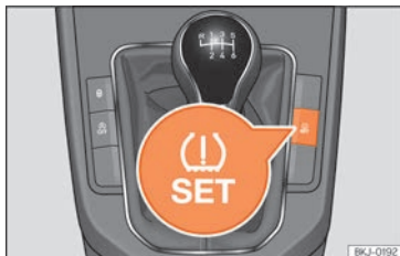
Fig. 291 Consola central: botão do sistema de controlo dos pneus.
