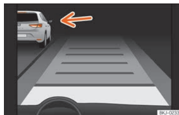
Fig. 237 No ecrã do painel de instrumentos: ACC ativo, veículo detetado pela esquerda
