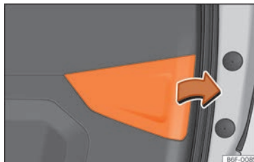
Fig. 61 Porta da bagageira aberta: retirar a tampa.
