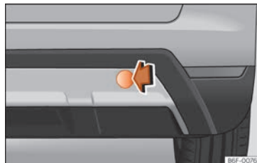
Fig. 48 No lado direito do para-choques traseiro: retirar a tampa.
