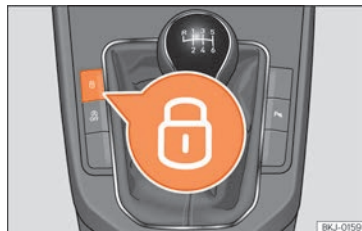
Fig. 91 Consola central: botão do fecho centralizado.
