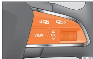
Fig. 79 Lado direito do volante multifunções: botões para utilizar os menus e as indicações informativas do painel de instrumentos.
