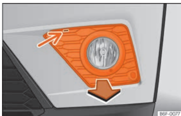
Fig. 57 Farol de nevoeiro: retirar a grelha
