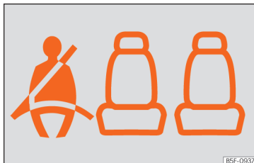
Fig. 6 Painel de instrumentos: indicação de lugar posterior esquerdo ocupado e cinto de segurança correspondente apertado.
