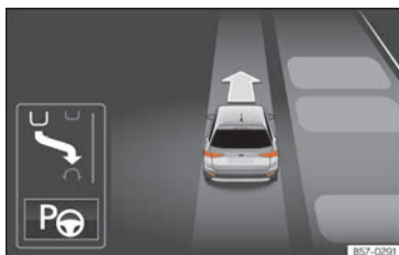
Fig. 248 No ecrã do painel de instrumentos: visualização do sistema de estacionamento assistido com visualização reduzida.
