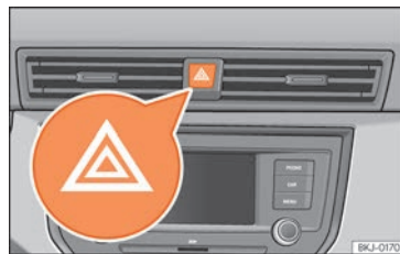
Fig. 108 Painel de instrumentos: interruptor das luzes de emergência
