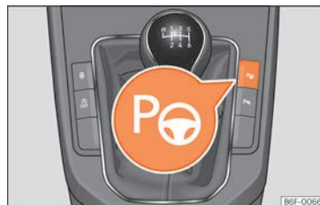
Fig. 247 Na consola central: botão para ligar o sistema de estacionamento assistido.
