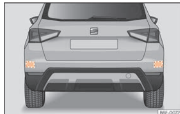
Fig. 241 Vista traseira do veículo: zonas dos sensores de radar.
