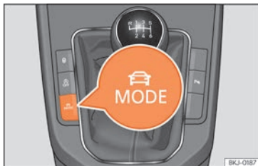
Fig. 219 Junto à alavanca da caixa de velocidades: tecla MODE.
