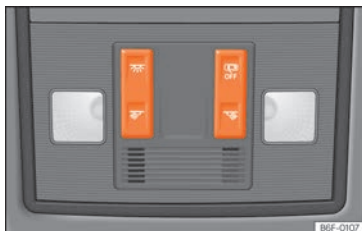
Fig. 111 Pormenor do forro do tejadilho: iluminação dianteira do habitáculo.
