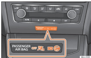
Fig. 18 Parte central do painel de instrumentos: luz de controlo da desativação do airbag do passageiro.
