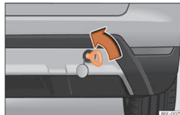
Fig. 49 No lado direito do para-choques traseiro: argola de reboque enroscada.
