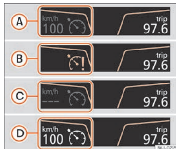
Fig. 221 Ecrã do painel de instrumentos: indicações do estado do GRA.
