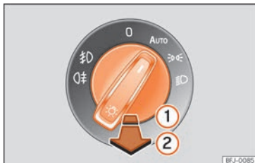
Fig. 105 Painel de instrumentos: comando das luzes.
