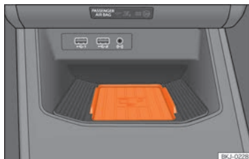
Fig. 207 Na consola central: alojamento para a ligação do telemóvel.
