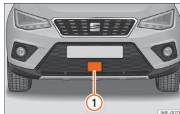
Fig. 228 No para-choques dianteiro: sensor de radar.
