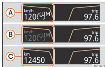
Fig. 224 No ecrã do painel de instrumentos: indicações do estado do limitador de velocidade.
