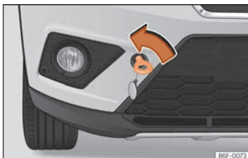
Fig. 47 Parte direita do para-choques dianteiro: argola de reboque enroscada.
