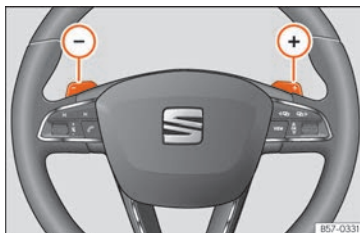
Fig. 216 Volante: alavancas de mudança automática de velocidade.
