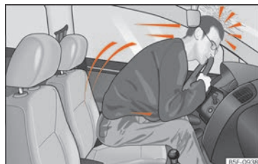
Fig. 8 O condutor que não tiver colocado o cinto de segurança será projetado para a frente.
