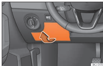
Fig. 50 No painel de instrumentos do lado do condutor: tampa da caixa de fusíveis.
