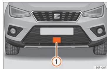
Fig. 234 No para-choques dianteiro: sensor de radar.
