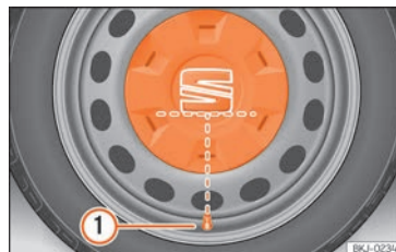
Fig. 34 Colocação correta do embelezador central da roda para jantes de aço.
