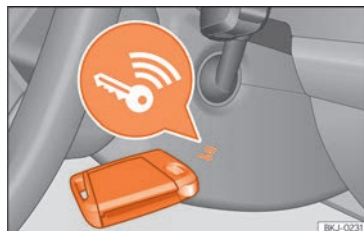
Fig. 210 À direita da coluna de direção: arranque de emergência.
