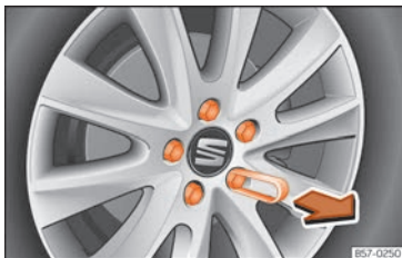
Fig. 35 Roda: parafusos da roda com protetores.
