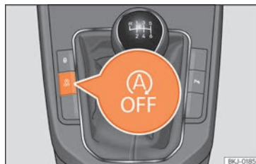
Fig. 212 Consola central: botão do sistema Start/Stop.
