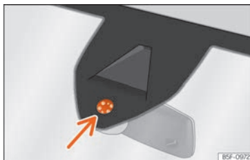
Fig. 103 Superfície sensível do sensor de chuva.
