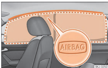
Fig. 20 Localização e raio de alcance do airbag da cabeça.
