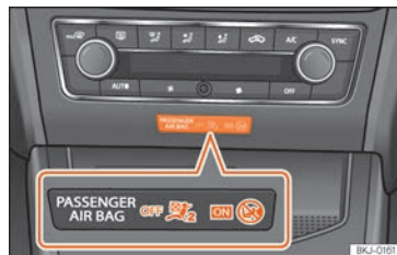
Fig. 17 Parte central do painel de instrumentos: luz de controlo da desativação do airbag do passageiro.
