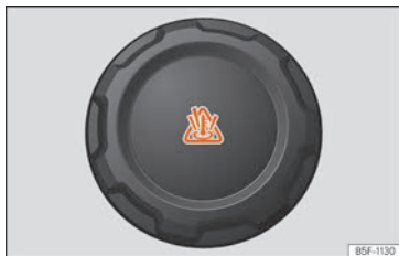
Fig. 193 Compartimento do motor: tampão do depósito de compensação do líquido de refrigeração.
