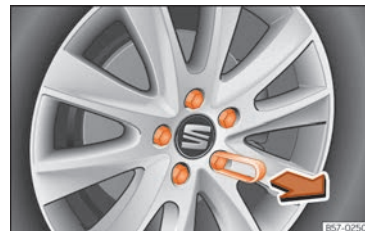
Fig. 34 Roda: parafusos da roda com protetores.
