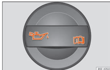
Fig. 191 Tampão do bocal de enchimento do óleo do motor no compartimento do motor.
