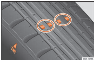
Fig. 198 Perfil do pneu: indicadores de desgaste.
