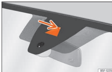
Fig. 144 No para-brisas: área de campo visual do sistema de aviso de saída da faixa de rodagem.
