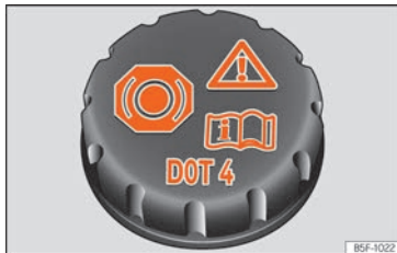
Fig. 194 Compartimento do motor: tampão do depósito do líquido dos travões.
