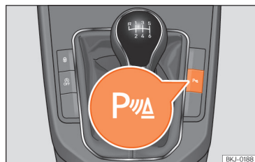
Fig. 121 Consola central: botão do auxílio de estacionamento (consoante as versões).
