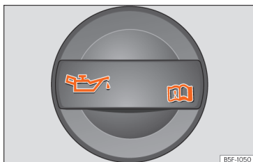
Fig. 178 Tampa do bocal de enchimento do óleo do motor no compartimento do motor.
