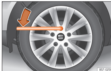
Fig. 188 Troca de roda: desapertar os parafusos de roda.
