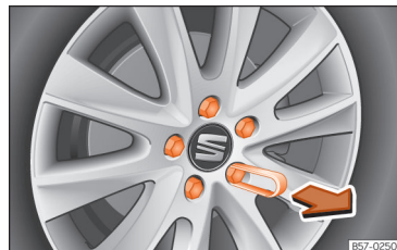
Fig. 186 Roda: parafusos de roda com protetores.
