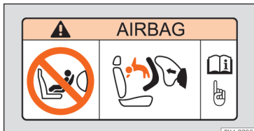
Fig. 33 Autocolante do airbag: na pala do sol do lado do passageiro.
