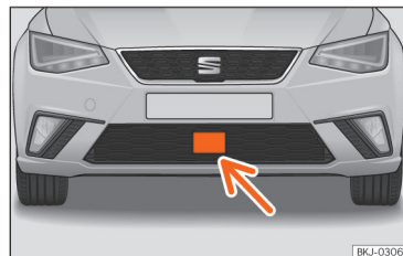
Fig. 94 No para-choques dianteiro: sensor de radar.
