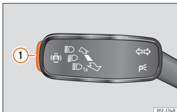
Fig. 92 Na alavanca das luzes indicadoras de mudança de direção e dos máximos: botão dos sistemas de assistência ao condutor (conforme versões).
