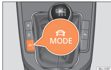
Fig. 91 Junto à alavanca da caixa de velocidades: tecla MODE.
