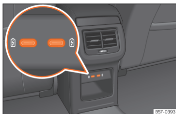
Fig. 148 Parte posterior consola central: Conectores USB com função de tomada de corrente.
