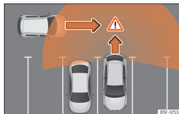
Fig. 182 Representação esquemática do assistente de saída do estacionamento: zona vigiada ao redor do veículo que está a sair do estacionamento.
