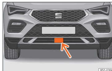
Fig. 158 No para-choques dianteiro: sensor de radar.
