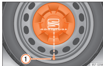
Fig. 33 Colocação correta do tampão central da roda para jantes de aço.
