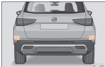
Fig. 161 Vista traseira do veículo: zonas dos sensores de radar.
