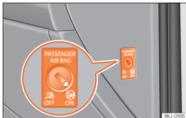
Fig. 27 Comutador com chave para ativar e desativar o airbag do passageiro.
