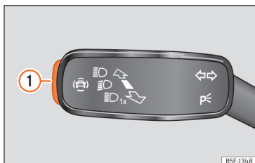
Fig. 90 Na alavanca das luzes indicadoras de mudança de direção e dos máximos: botão dos sistemas de assistência ao condutor (conforme versões).
