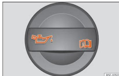
**Fig. 57** Tampão do bocal de enchimento do óleo do motor no compartimento do motor.
