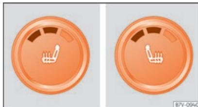
**Fig. 158** Pormenor da consola central: comandos para o aquecimento dos bancos dianteiros, aqui com o segundo nível de temperatura ajustado.
