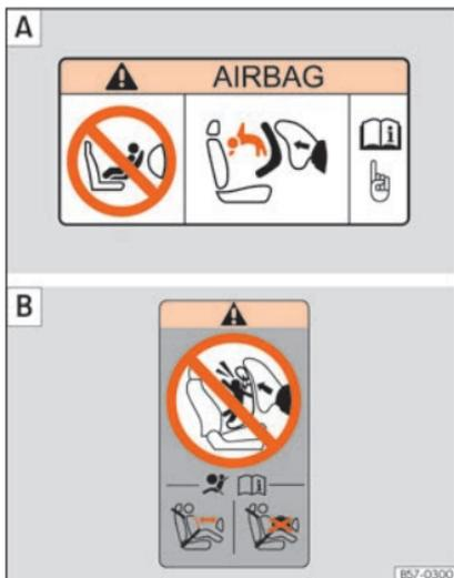
**Fig. 37** Autocolantes do airbag - versão 2: na pala do lado do passageiro [A] e na moldura posterior da porta do passageiro [B].
