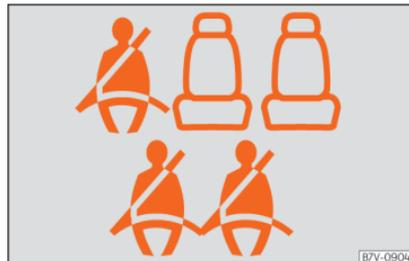
**Fig. 85** Exemplo de indicação do estado do cinto nos lugares traseiros (aqui, num veículo de 7 lugares) no painel de instrumentos: por cima, a segunda fila; por baixo, a terceira fila de bancos.
