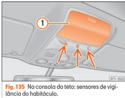
**Fig. 135** Na consola do teto: sensores de vigilância do habitáculo.
