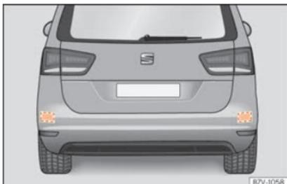
**Fig. 272** Vista traseira do veículo: zonas dos sensores de radar.
