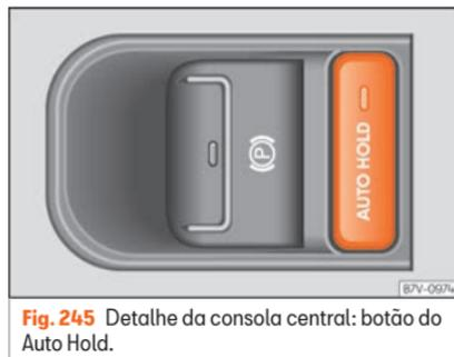
Fig. 245 Detalhe da consola central: botão do Auto Hold.
