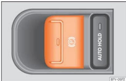
Fig. 239 Detalhe da consola central: interruptor do travão de estacionamento eletrónico.
