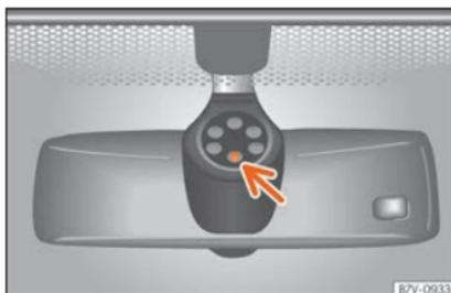
Fig. 149 Superfície sensível do sensor de chuva.
