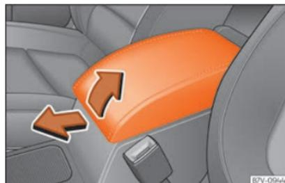
Fig. 165 Apoio de braços central dianteiro. »»
