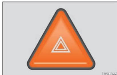
**Fig. 144** No centro do painel de instrumentos: botão das luzes emergência.
