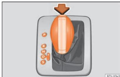
**Fig. 51** Caixa de velocidades automática: posições da alavanca seletora.
