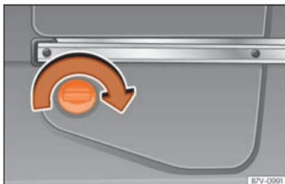
**Fig. 288** Na parte traseira esquerda da bagageira: depósito de AdBlue, atrás de uma cobertura.
