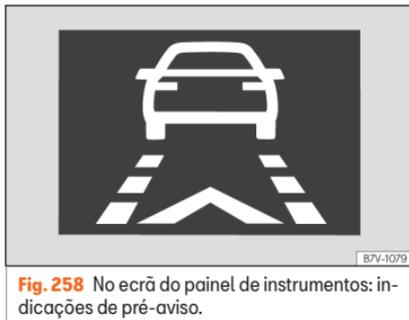
**Fig. 258** No ecrã do painel de instrumentos: indicações de pré-aviso.
