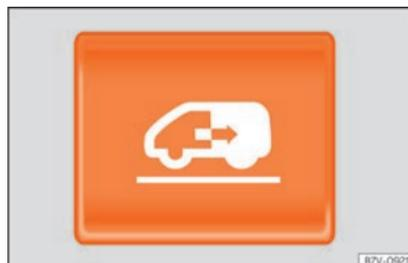
**Fig. 137** No painel de instrumentos, na chave do veículo e no revestimento interior da porta de correr: botão para abrir e fechar uma porta de correr elétrica.
