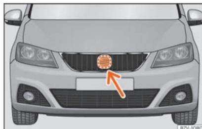
Fig. 259 Na parte frontal atrás do emblema da SEAT: sensor de radar.
