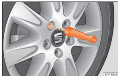
**Fig.73** Substituição da roda: desapertar os parafusos da roda com o punho da chave de parafusos.
