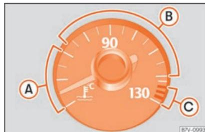
**Fig. 293** Indicador de temperatura do líquido de refrigeração no painel de instrumentos.
