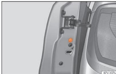
**Fig. 6** Na parte frontal da porta de correr: trancagem de emergência, oculta por uma junta de borracha.
