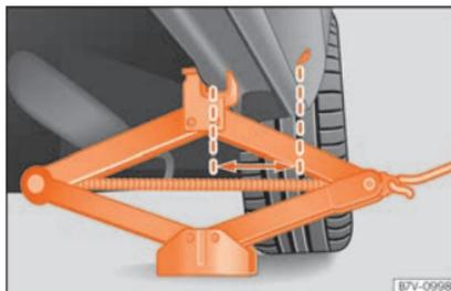
Fig. 72 Macaco colocado na parte traseira esquerda do veículo.
