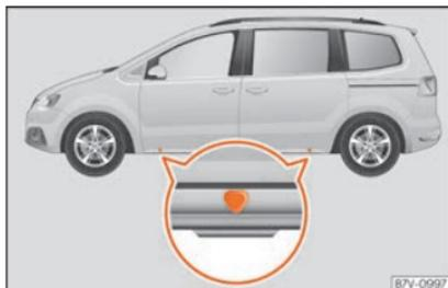
Fig. 71 Pontos de apoio do macaco.
