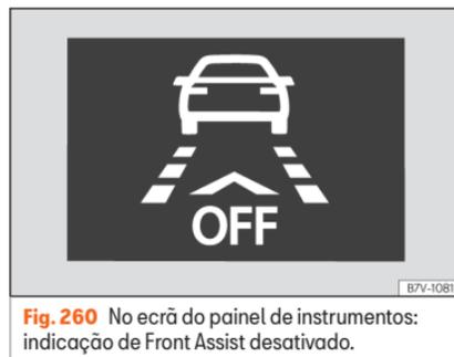
**Fig. 260** No ecrã do painel de instrumentos: indicação de Front Assist desativado.
