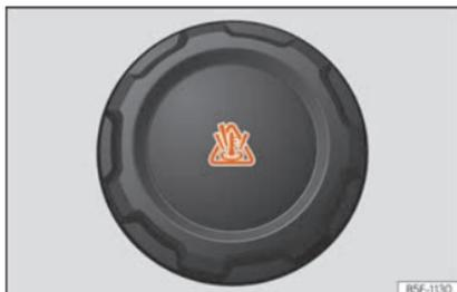
**Fig. 295** No compartimento do motor: Tampão do reservatório de expansão do líquido de refrigeração.
