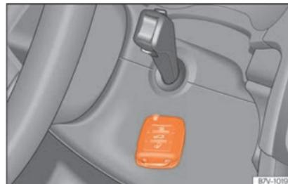
**Fig. 238** Arranque de emergência em veículos com Keyless Access.
