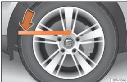
**Fig. 69** Substituição de uma roda: despertar os parafusos das rodas
