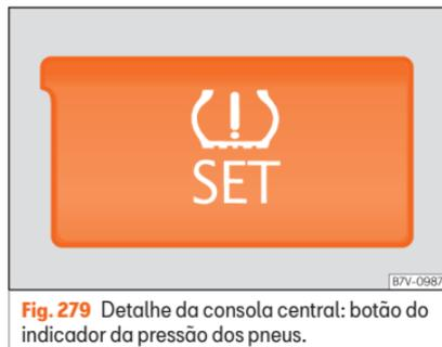
**Fig. 279** Detalhe da consola central: botão do indicador da pressão dos pneus.
