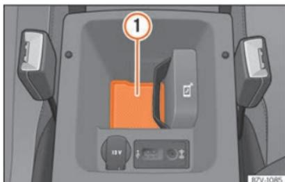
**Fig. 231** Alojamento para a ligação do telemóvel à antena exterior do veículo situado dentro do apoio dos braços central dianteiro.
