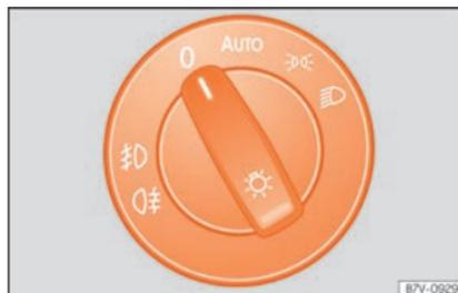
Fig. 42 Painel de instrumentos: comando das luzes.
