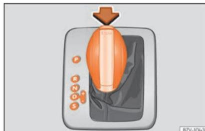
Fig. 241 Alavanca seletora da caixa automática com botão de bloqueio (seta).
