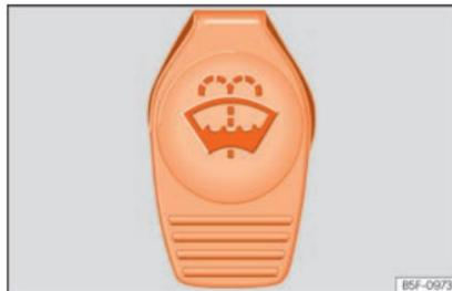
**Fig. 297** No compartimento do motor: tampa do depósito do lava-vidros.
