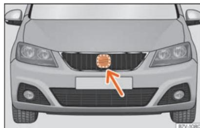
**Fig. 263** Na parte frontal atrás do emblema da SEAT: sensor de radar.
