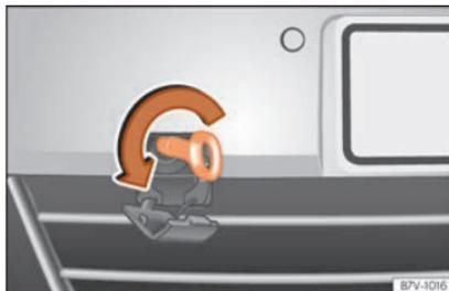
**Fig. 74** Na parte direita do para-choques dianteiro: enroscar a argola de reboque.
