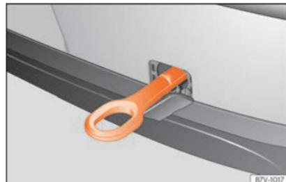
**Fig. 75** No para-choques traseiro, no lado direito: argola de reboque enroscada.
