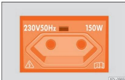
**Fig. 198** Pormenor da consola central traseira: tomada de corrente europeia de 230 Volts.
