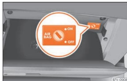
**Fig. 29** No porta-luvas, no lado do passageiro: interruptor de chave para ativar e desativar o airbag dianteiro do passageiro.
