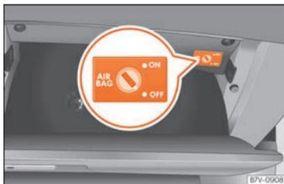
**Fig. 94** No porta-luvas, no lado do passageiro: interruptor de chave para ativar e desativar o airbag dianteiro do passageiro.
