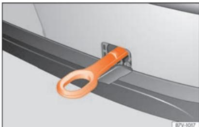
**Fig. 106** No para-choques traseiro, no lado direito: argola de reboque enroscada.
