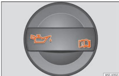
**Fig. 292** No compartimento do motor: tampão do bocal de enchimento do óleo do motor
