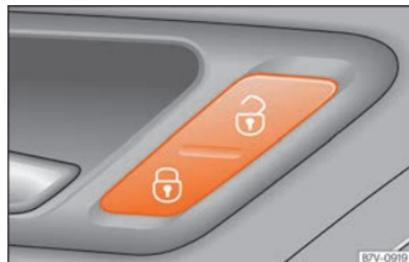
**Fig. 132** Na porta do condutor: botão do fecho centralizado.
