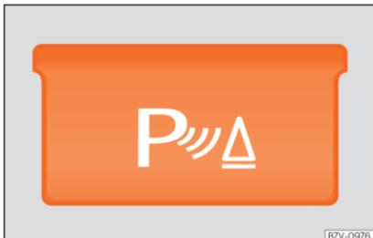
**Fig. 246** Detalhe da consola central: botão para ativar ou desativar o controlo da distância de estacionamento.
