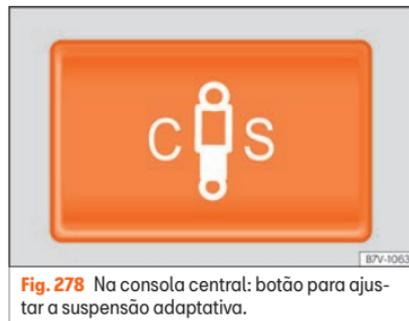
A suspensão adaptativa adapta continuamente o amortecimento do trem de rodagem durante o andamento às características da estrada e à situação de andamento correspondente conforme um programa pré-ajustado.
