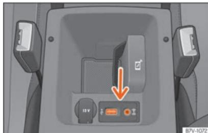
**Fig. 218** Apoio de braços central dianteiro: entrada USB/AUX-IN.
