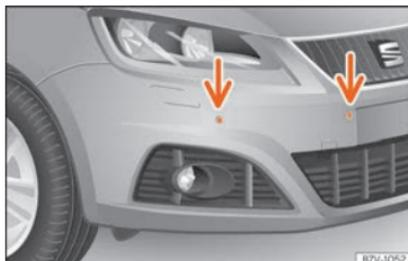
**Fig. 247** Sensores do controlo de estacionamento no para-choques dianteiro.
