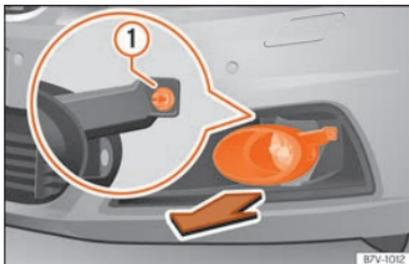
**Fig. 111** Na parte direita do para-choques dianteiro: desmontar os faróis.
