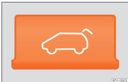
**Fig. 8** Detalhe da consola central: botão de destrancagem da porta da bagageira.
