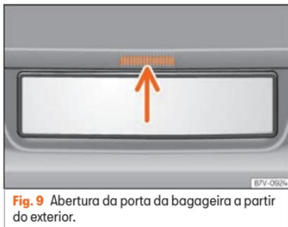
**Fig. 9** Abertura da porta da bagageira a partir do exterior.
