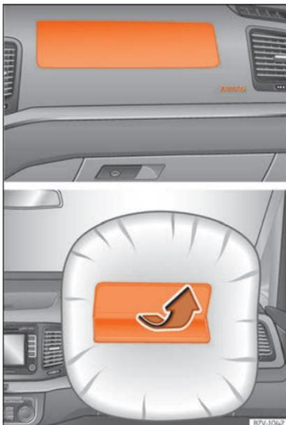
**Fig. 28** Localização e campo de ação do airbag dianteiro do passageiro.
