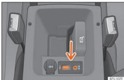
**Fig. 123** Apoio de braços central dianteiro: entrada USB/AUX-IN.
