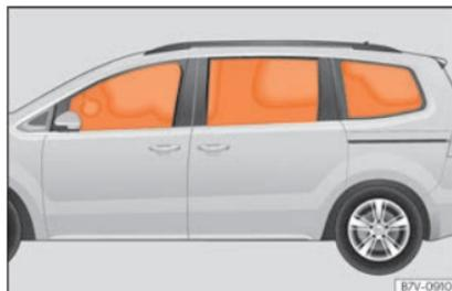
Fig. 35 Airbags da cabeça insuflados.
