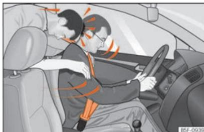
**Fig. 88** O ocupante do banco traseiro que não tiver o cinto de segurança colocado será projetado para a frente, para cima do condutor que tem o cinto colocado.
