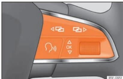
**Fig. 47** Volante multifunções: botões para utilizar os menus do painel de instrumentos.
