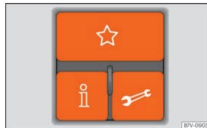
**Fig. 125** Módulo de três botões do teto: comandos do sistema de gestão do telefone.
