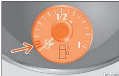
**Fig. 285** No painel de instrumentos: indicador do nível de combustível para gasolina e diesel.
