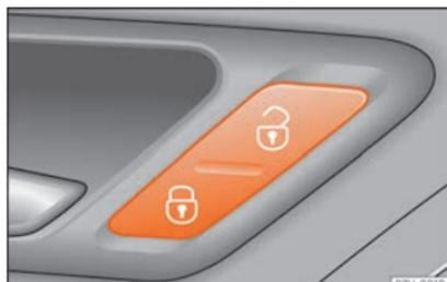
**Fig. 4** Na porta do condutor: botão do fecho centralizado.
