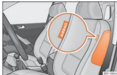
**Fig. 32** No painel lateral do banco dianteiro: localização do airbag lateral.
