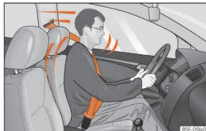
**Fig. 86** Os condutores que tenham o cinto de segurança corretamente colocado não serão projetados em caso de travagens repentinas.
