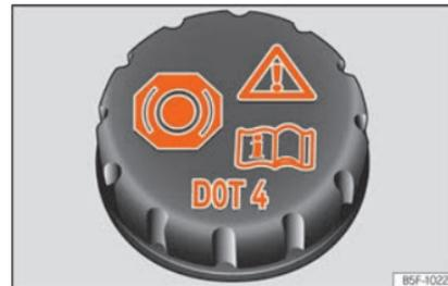
**Fig. 296** No compartimento do motor: tampa do depósito do líquido dos travões.
