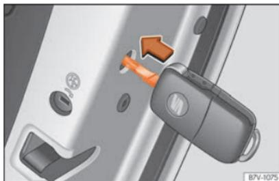
**Fig. 7** Trancagem de emergência do veículo com a chave do veículo.
