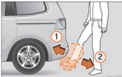
**Fig. 142** Porta da bagageira com abertura controlada por sensor (Easy Open)
