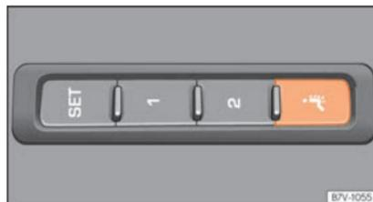
**Fig. 160** Na lateral do banco dianteiro: botão para a função de massagem lombar.
