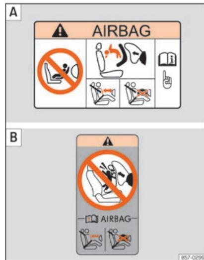
Fig. 36 Autocolantes do airbag - versão 1: na pala do sol do lado do passageiro [A] e na moldura posterior da porta do passageiro [B].
