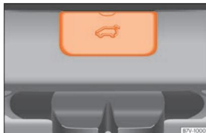
**Fig. 10** A partir da bagageira: desmontagem da tampa da porta da bagageira.
