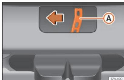
**Fig. 11** A partir da bagageira: destrancagem de emergência da porta da bagageira.
