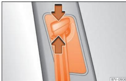
Fig. 92 Junto aos bancos dianteiros: regulador da altura do cinto.
