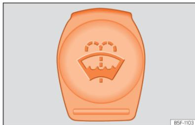
**Fig. 184** No compartimento do motor: tampa de cor azul do depósito do limpa-vidros.
