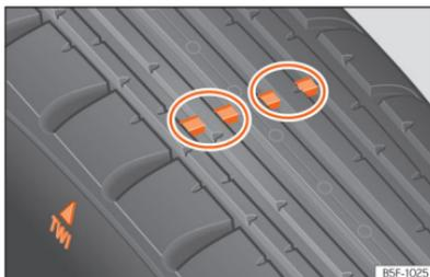
**Fig. 191** Perfil do pneu: indicadores de desgaste.
