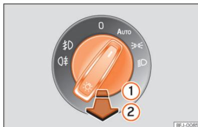
**Fig. 70** Painel de instrumentos: comando das luzes.
