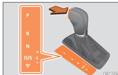
**Fig. 87** Bloqueio da alavanca seletora.
