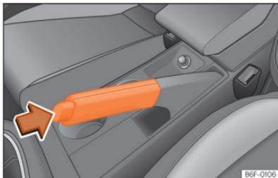
**Fig. 119** Travão de estacionamento entre os bancos dianteiros.
