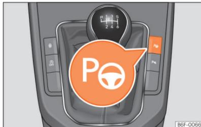
**Fig. 125** Na consola central: botão para ligar o sistema de estacionamento assistido.
