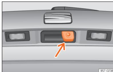
**Fig. 99** No manípulo da porta da bagageira: localização da câmara do assistente para marcha-atrás.
