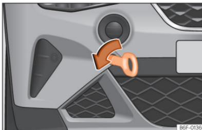
**Fig. 166** Parte direita do para-choques dianteiro: argola de reboque enroscada.
