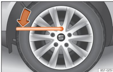
**Fig. 197** Troca de roda: desapertar os parafusos da roda.
