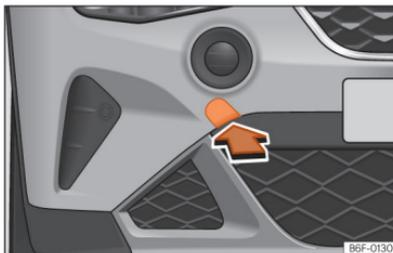
**Fig. 165** No lado direito do para-choques dianteiro: retirar a tampa.
