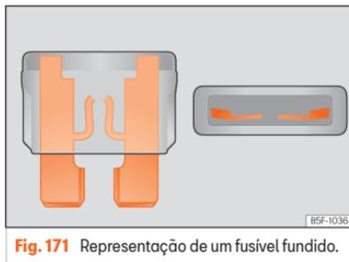
**Fig. 171** Representação de um fusível fundido.
