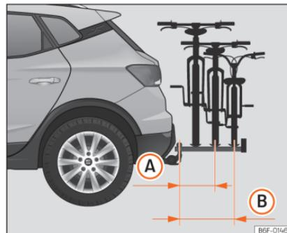
**Fig. 153** Representação esquemática da saliência máxima da carga num porta-bicicletas para duas ou três bicicletas.
