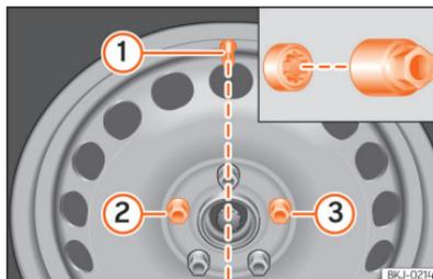
**Fig. 198** Troca de roda: válvula do pneu (1) e local de montagem do parafuso da roda antirroubo (2) ou (3).
