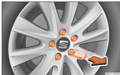
**Fig. 195** Roda: parafusos de roda com protetores.
