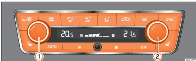
**Fig. 80** Na consola central: comandos do Climatronic.
