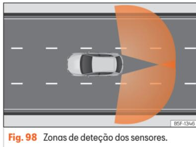
**Fig. 98** Zonas de deteção dos sensores.
