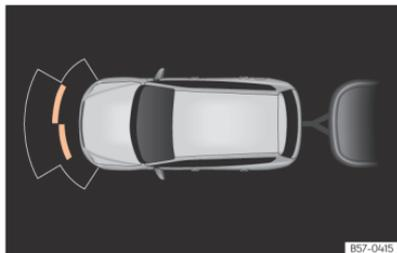
**Fig. 121** Visualização do Auxiliar de estacionamento no ecrã com reboque engatado.
