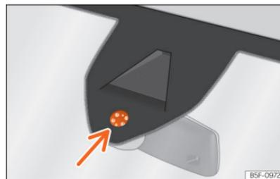
**Fig. 76** Superfície sensível do sensor de chuva.
