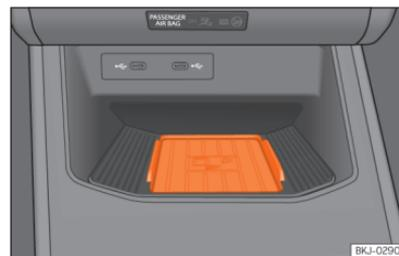
**Fig. 144** Na consola central: alojamento para a ligação do telemóvel.
