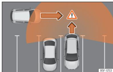
**Fig. 132** Representação esquemática do assistente de saída do estacionamento: zona vigiada ao redor do veículo que está a sair do estacionamento.
