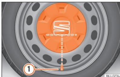
**Fig. 194** Colocação correta do tampão central da roda para jantes de aço.
