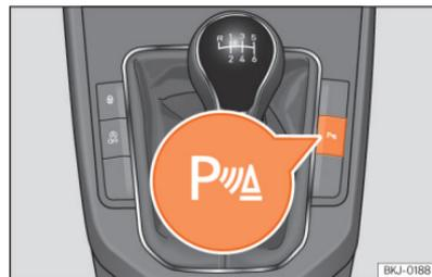
**Fig. 122** Consola central: botão do auxílio de estacionamento (consoante as versões).
