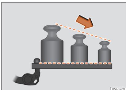
**Fig. 152** Distribuição recomendada do peso no sistema de carga traseiro.
