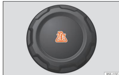
**Fig. 182** Compartimento dianteiro: tampão do depósito de expansão do líquido de refrigeração.
