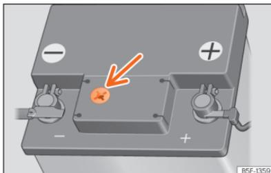
**Fig. 189** Janela de inspeção na parte superior da bateria de 12 volts (representação esquemática).
