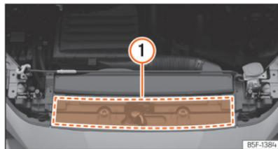
**Fig. 186** No compartimento do motor: zona de localização da etiqueta de óleo do motor
