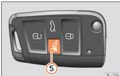
**Fig. 46** Chave do veículo com botão de alarme.
