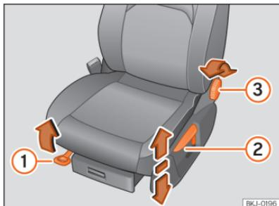
**Fig. 63** Bancos dianteiros: ajuste manual do banco.
