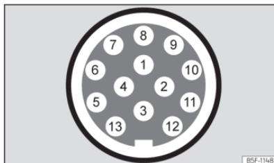
**Fig. 151** Representação esquemática: atribuição dos pinos da tomada de corrente para reboque.
