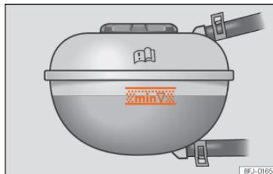
**Fig. 181** No compartimento dianteiro: marca no depósito de expansão do líquido de refrigeração.
