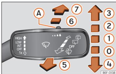
**Fig. 74** Utilização do limpa-vidros e do limpa-vidros traseiro.
