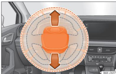
Fig. 27 Airbag do condutor no volante.
