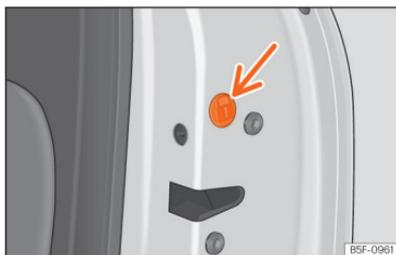
**Fig. 55** Trancagem de emergência da porta.
