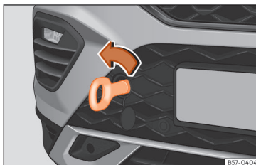
Fig. 196 Parte direita do para-choques dianteiro: argola de reboque enroscada.
