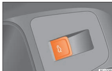
Fig. 85 Na porta do condutor: tecla para abrir e fechar a porta da mala.
