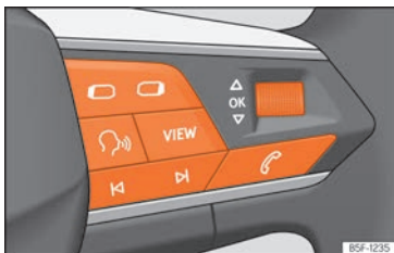
Fig. 62 Lado direito do volante multifunções: botões para utilizar os menus e as indicações informativas do painel de instrumentos.
