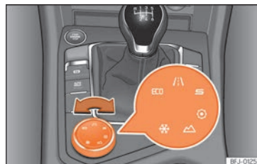
Fig. 170 Consola central: Comando rotativo (Driving Experience button).
