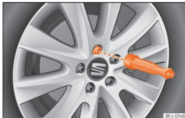
Fig. 39 Substituição da roda: desenroscar os parafusos de roda com o cabo da chave de parafusos.
