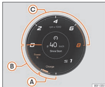
Fig. 58 Painel de instrumentos digital: Power-meter
