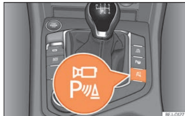
Fig. 215 Consola central: botão para ativar/desativar manualmente o sistema de visão periférica quando está em combinação com o sistema de estacionamento assistido.
