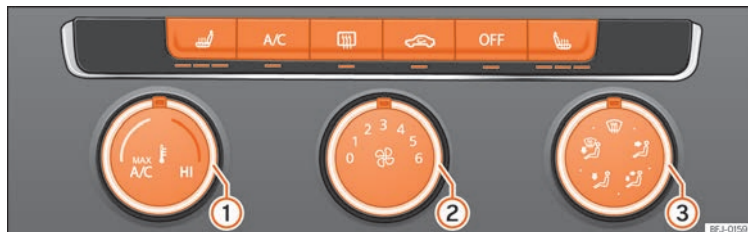
Fig. 147 Na consola central: comandos do ar condicionado manual.
