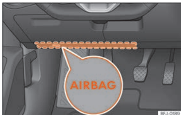
Fig. 19 No lado do condutor: localização do airbag de joelhos.
