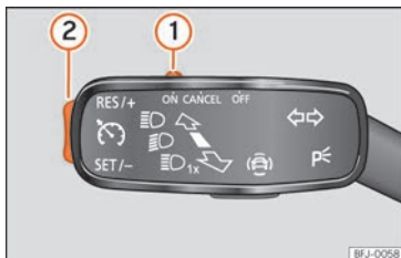
Fig. 179 No manípulo dos indicadores de mudança de direção: comandos para a utilização do GRA.
