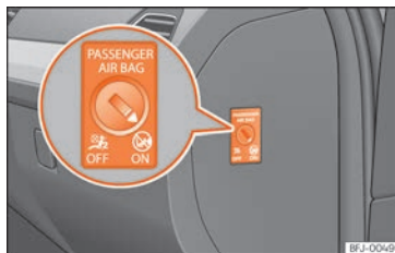
Fig. 17 Comutador com chave para ativar e desativar o airbag do passageiro.
