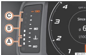
Fig. 61 Painel de instrumentos digital: indicador da temperatura do líquido de refrigeração do motor
