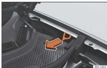
Fig. 230 Entre a lateral esquerda e a dobradiça do capô do motor: Puxador para o desbloqueio manual de emergência do conector de carregamento.
