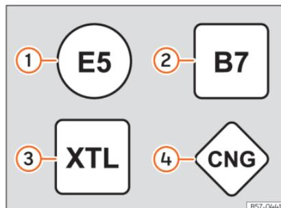
**Fig. 225** Identificação dos combustíveis em conformidade com a Diretiva 2014/94/UE do Parlamento Europeu e do Conselho
