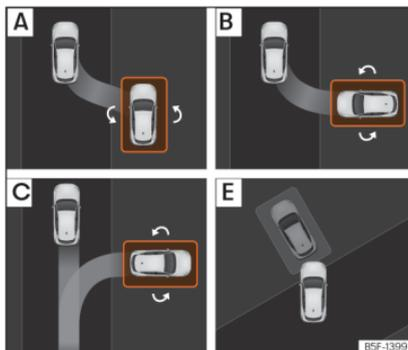
**Fig. 201** No ecrã do sistema de infotainment: indicação dos modos de estacionamento.
