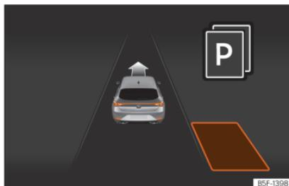
**Fig. 200** No ecrã do painel de instrumentos: visualização do sistema de estacionamento assistido com visualização reduzida.
