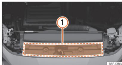
**Fig. 231** No compartimento do motor: zona de localização da etiqueta de óleo do motor
