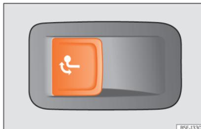
**Fig. 209** No lado esquerdo da bagageira: botão para desbloquear o gancho de reboque.
