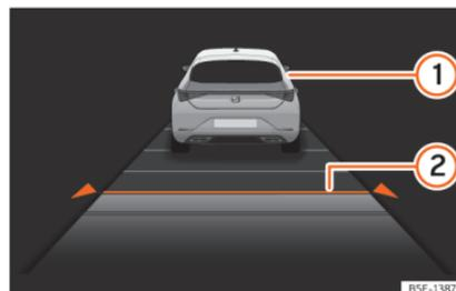
**Fig. 183** No ecrã do painel de instrumentos: ACC ativo.
