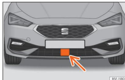
**Fig. 171** No para-choques dianteiro: sensor de radar.
