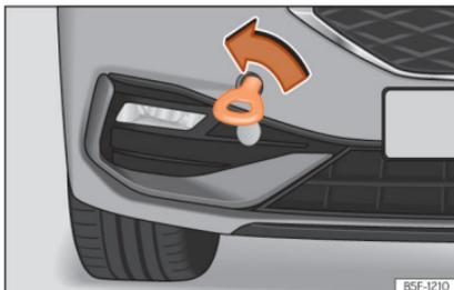
**Fig. 53** Parte direita do para-choques dianteiro: argola de reboque enroscada.
