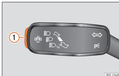
**Fig. 73** No manípulo dos indicadores de mudança de direção e dos máximos: botão para os sistemas de assistência à condução (conforme versão).
