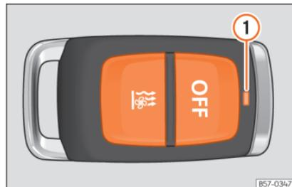
**Fig. 155** Aquecimento estacionário: comando à distância por radiofrequência.
