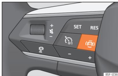
**Fig. 74** Lado esquerdo do volante multifunções: botão para os sistemas de assistência à condução (conforme versão).
