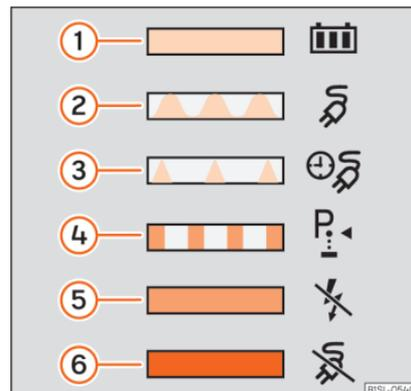
**Fig. 217** Na parte interior da tampa da tomada de carregamento da bateria: autocolante com informação sobre o indicador do processo de carregamento.
