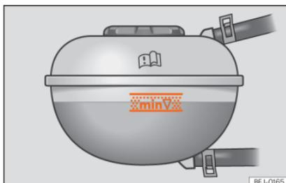
**Fig. 235** No compartimento do motor: marca no depósito de expansão do líquido de refrigeração.
