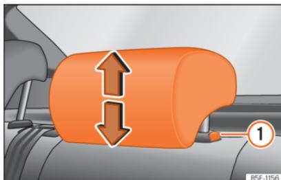
**Fig. 116** Encostos de cabeça traseiros: ajuste do encosto de cabeça.
