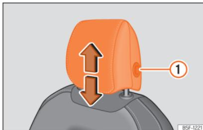
**Fig. 115** Banco dianteiro: ajuste do encosto de cabeça.
