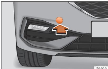
**Fig. 52** No lado direito do para-choques dianteiro: retirar a tampa.
