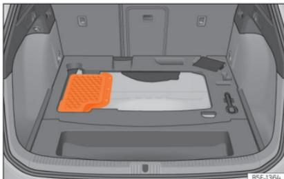
**Fig. 239** Veículos híbridos (PHEV): localização da bateria na bagageira
