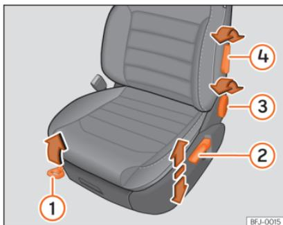
**Fig. 113** Bancos dianteiros: ajuste manual do banco.
