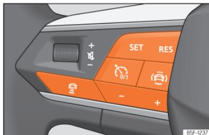
**Fig. 182** No volante multifunções: botões para utilizar o ACC
