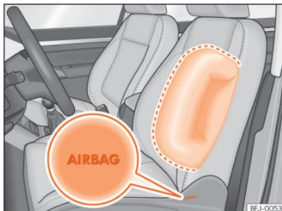
Fig. 26 Airbag lateral no banco do condutor.
