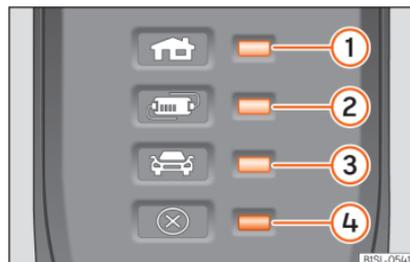
**Fig. 221** No cabo de carregamento para tomadas de corrente: Luzes de controle do dispositivo de proteção.
