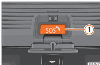
**Fig. 38** Botão para chamada de emergência
