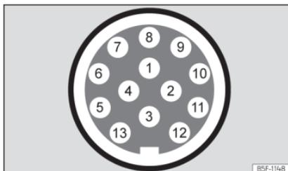
**Fig. 208** Esquema: atribuição dos pinos da tomada de corrente para reboque.
