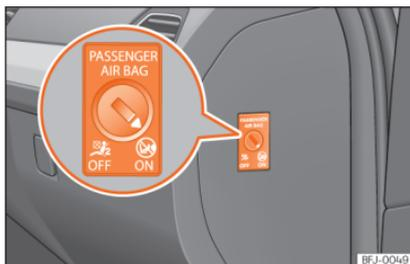
**Fig. 20** Computador com chave para ativar e desativar o airbag do passageiro.
