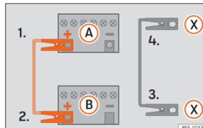
**Fig. 51** Esquema de ligação para veículos com sistema Start-Stop.
