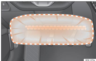
**Fig. 23** No lado do condutor: raio de ação do airbag de joelhos.
