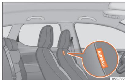
**Fig. 24** No estofamento interno do encosto do banco do condutor: airbag central.
