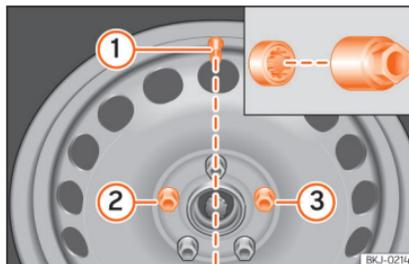
**Fig. 45** Substituição da roda: válvula do pneu (1) e local de montagem do parafuso de roda antirroubo (2) ou (3).
