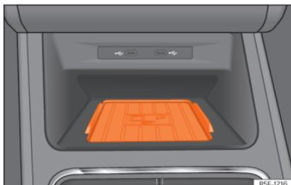
**Fig. 162** Na consola central: alojamento para a ligação do telemóvel.
