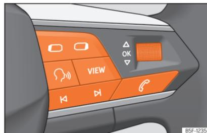
**Fig. 72** Lado direito do volante multifunções: botões para utilizar os menus e as indicações informativas do painel de instrumentos.
