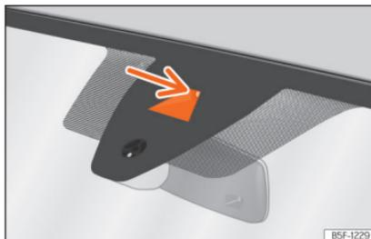
**Fig. 173** No para-brisas: área de campo visual do sistema de aviso de saída da faixa de rodagem.
