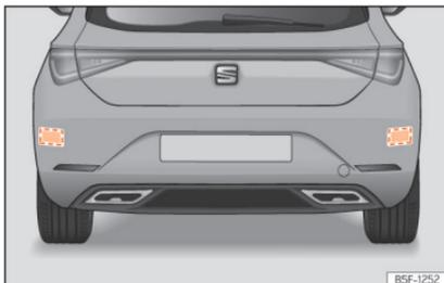
**Fig. 174** Vista traseira do veículo: zonas dos sensores de radar.
