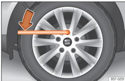
**Fig. 44** Substituição da roda: desapertar os parafusos da roda.
