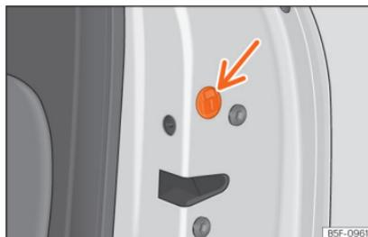
**Fig. 92** Trancagem de emergência da porta.
