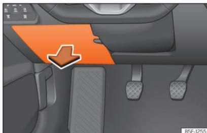
**Fig. 56** No painel de instrumentos do lado do condutor: tampa da caixa de fusíveis.
