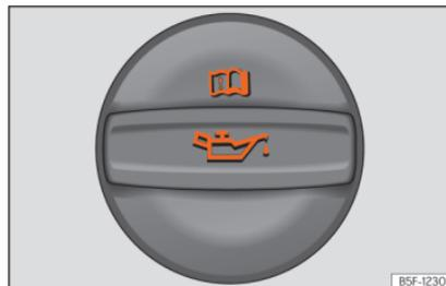
Fig. 233 Tampão do bocal de enchimento do óleo do motor no compartimento do motor.
