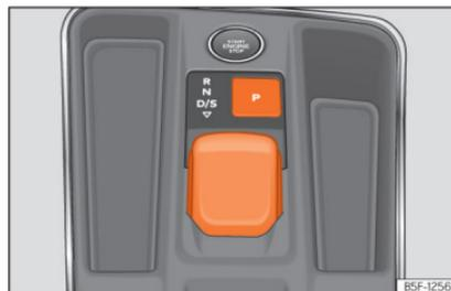
Fig. 169 Na consola central: comando seletor.
