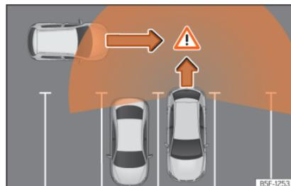
**Fig. 195** Representação esquemática do assistente de saída do estacionamento: zona vigiada ao redor do veículo que está a sair do estacionamento.
