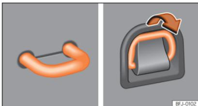
**Fig. 134** Na bagageira: argolas de fixação fixas e desdobráveis.
