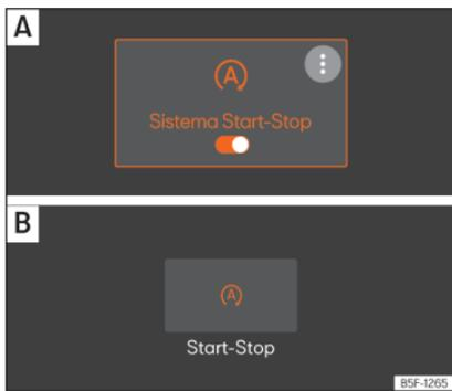
**Fig. 167** No ecrã do sistema de infotainment: sistema Start-Stop ligado. **[A]** Vista no menu principal. **[B]** Vista com o sistema de infotainment desligado.
