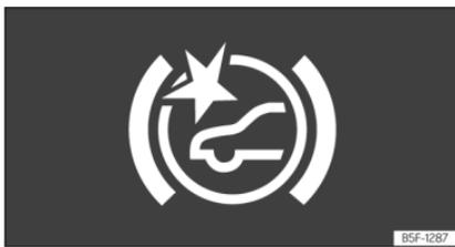
**Fig. 179** No ecrã do painel de instrumentos: indicações de pré-aviso.
