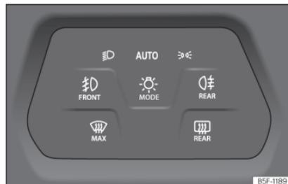
Fig. 103 Painel de instrumentos: comando das luzes.
