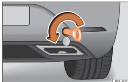
**Fig. 55** No lado direito do para-choques traseiro: argola de reboque enroscada.
