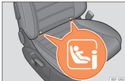
**Fig. 33** Banco passageiro dianteiro: anéis de fixação ISOFIX/i-Size.
