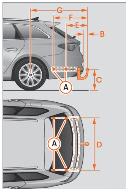
**Fig. 210** Quotas e pontos de fixação para a montagem posterior de um dispositivo de reboque.
