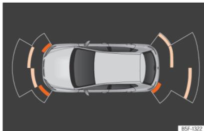
**Fig. 206** Visualização do auxiliar de estacionamento no ecrã do sistema de infotainment.
