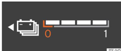
**Fig. 67** Painel de instrumentos digital: indicador do nível de bateria.
