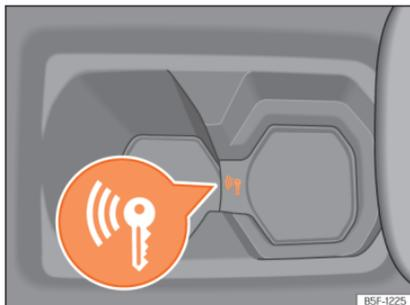
**Fig. 166** Na consola central: arranque de emergência.
