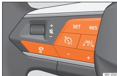
**Fig. 190** Lado esquerdo do volante multifunções: botões para a utilização do Travel Assist.
