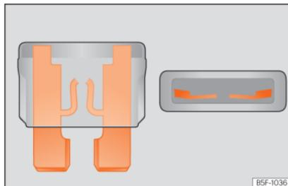
**Fig. 58** Representação de um fusível fundido.
