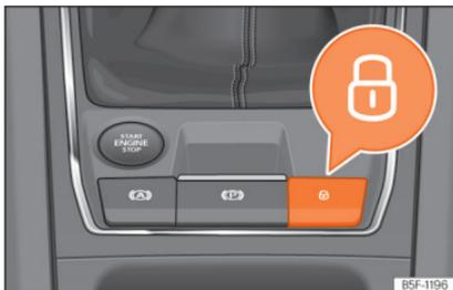
**Fig. 88** Na consola central: interruptor do fecho centralizado
