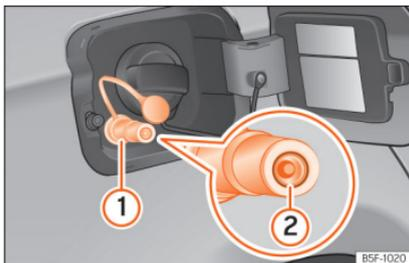
**Fig. 224** Tampa do depósito aberta: bocal de enchimento de gás ①, retentor do bocal de enchimento ②.
