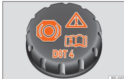
**Fig. 237** Compartimento do motor: tampão do depósito do líquido dos travões.
