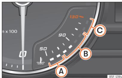
Fig. 71 Painel de instrumentos analógico: indicador da temperatura do líquido de refrigeração do motor
