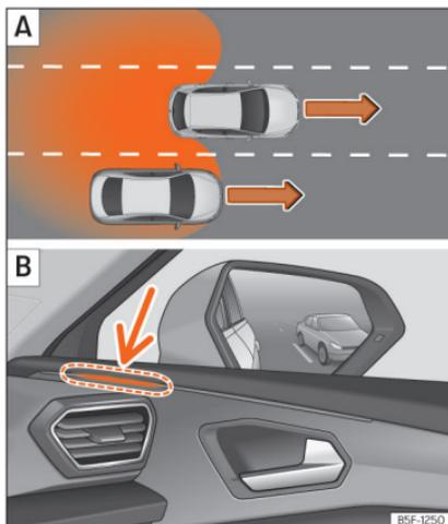
**Fig. 194** Esquema: **A**) Situação numa ultrapassagem na faixa de rodagem central e incorporação posterior na faixa de rodagem direita. **B**) Indicação do assistente de mudança de faixa na luz de controlo do lado direito.
