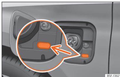
**Fig. 216** Por trás da tampa da tomada de carregamento da bateria: indicador do processo de carregamento.
