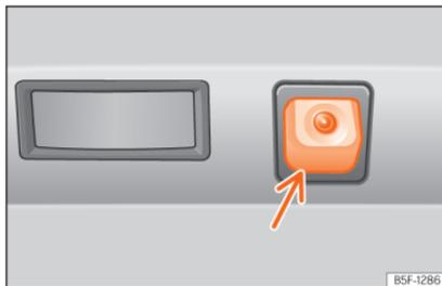
**Fig. 176** No para-choques traseiro: localização da câmara do assistente de marcha-atrás.
