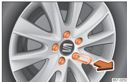
**Fig. 42** Roda: parafusos da roda com protetores.
