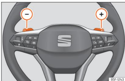
**Fig. 170** Volante: alavancas de mudança automática de velocidade.
