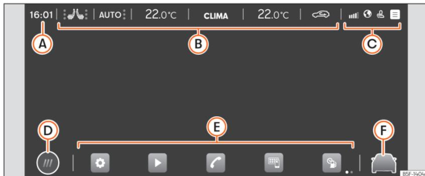
**Fig.75** Esquema: Vista geral dos possíveis botões de função no ecrã.
