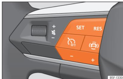
**Fig. 178** No volante multifunções: botões para utilizar o limitador de velocidade
