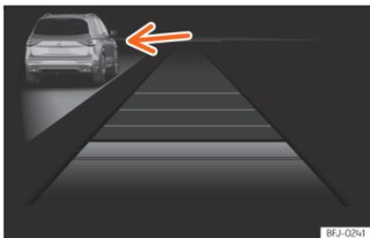
**Fig. 184** No ecrã do painel de instrumentos: ACC ativo, veículo detetado pela esquerda
