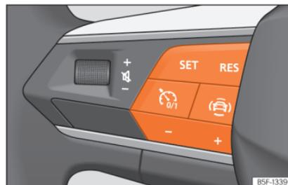
Fig. 177 No volante multifunções: botões para utilizar o regulador de velocidade
