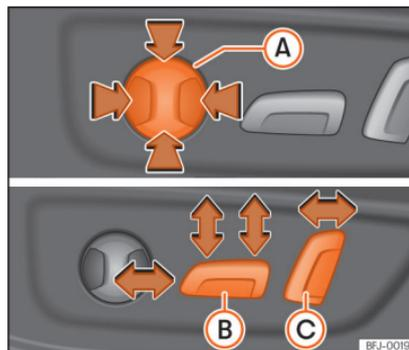
**Fig. 114** Banco do condutor: ajuste elétrico do banco.
