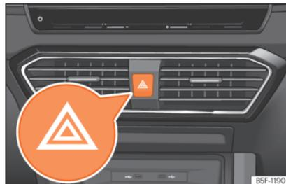
**Fig. 105** Painel de instrumentos: interruptor das luzes de emergência
