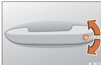
**Fig. 91** Manípulo da porta do condutor: canhão da fechadura.
