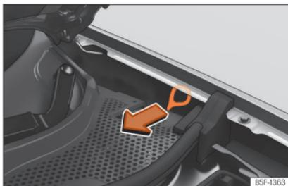
**Fig. 218** Entre a lateral esquerda e a dobradiça do capô do motor: Puxador para o desbloqueio manual de emergência do conector de carregamento.
