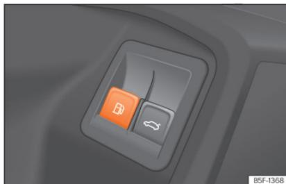
**Fig. 222** Porta do condutor: desbloqueio da tampa do depósito
