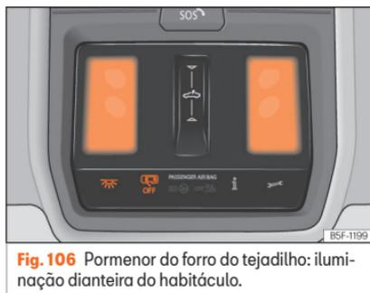
**Fig. 106** Pormenor do forro do tejadilho: iluminação dianteira do habitáculo.
