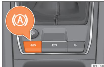
Fig. 199 Na parte inferior da consola central: tecla da função Auto Hold.
