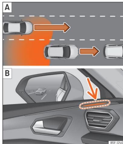
**Fig. 193** Esquema: **A** Situação numa ultrapassagem com trânsito na parte traseira. **B** Indicação do assistente de mudança de faixa na luz de controlo do lado esquerdo.
