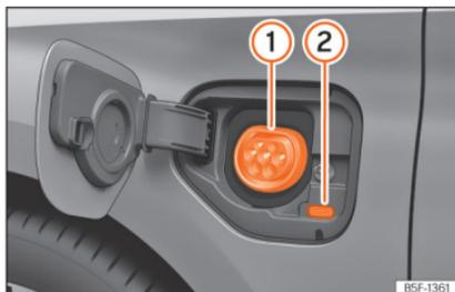
**Fig. 215** Por trás da tampa de carregamento da bateria na parte dianteira esquerda: Tomada de carregamento
