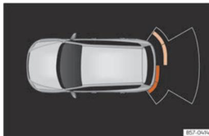
**Fig. 205** Visualização do auxiliar de estacionamento no ecrã do sistema Infotainment.
