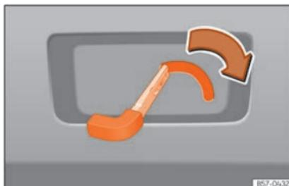
**Fig. 102** Pormenor da bagageira: destrancagem de emergência.
