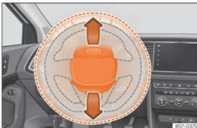
Fig. 14 Airbag do condutor no volante.
