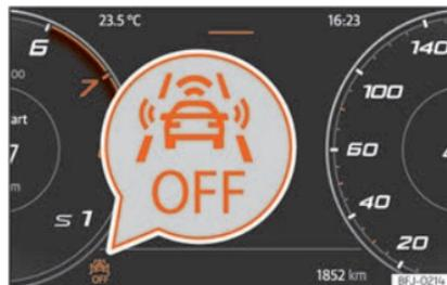
**Fig. 177** No ecrã do painel de instrumentos: indicação de Front Assist desativado.
