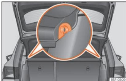
**Fig. 127** Na bagageira: desmontar e montar a chapeleira.
