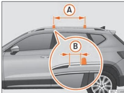
**Fig. 139** Pontos de fixação das barras longitudinais para a bagageira do tejadilho.
