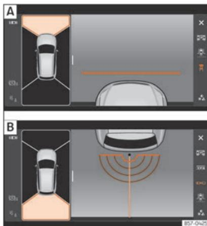
**Fig. 210** Visualização no ecrã do sistema de visão periférica: **[A]** Câmara dianteira: vista todo-o-terreno. **[B]** Câmara traseira: vista todo-o-terreno.
