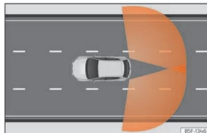
**Fig. 170** Zonas de deteção dos sensores
