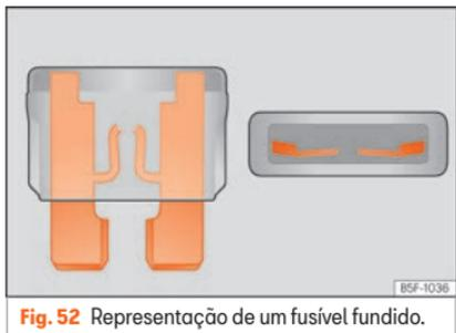
**Fig. 52** Representação de um fusível fundido.
