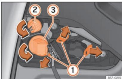
**Fig. 62** desmontar o porta-lâmpadas.
