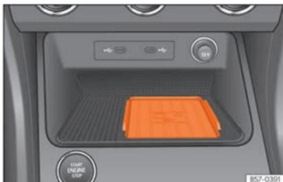
**Fig. 154** Na consola central: alojamento para a ligação do telemóvel.
