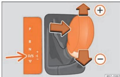
**Fig.162** Alavanca seletora na posição Tiptronic
