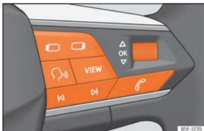
**Fig. 75** Lado direito do volante multifunções: botões para utilizar os menus e as indicações informativas do painel de instrumentos.
