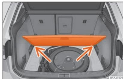
**Fig. 131** Piso variável da bagageira: posição inclinada.
