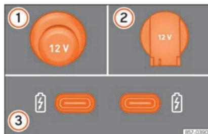
**Fig. 143** Tomada de corrente de 12 Volts: (1) na consola central, (2) na bagageira. Tomada de corrente USB na parte posterior da consola central (3).
