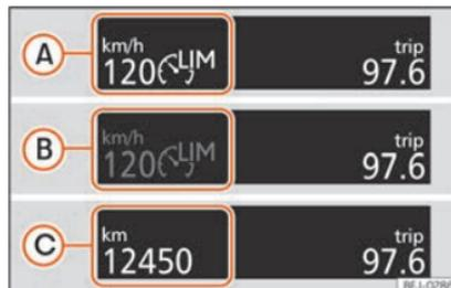
**Fig. 174** No ecrã do painel de instrumentos: indicações do estado do limitador de velocidade.
