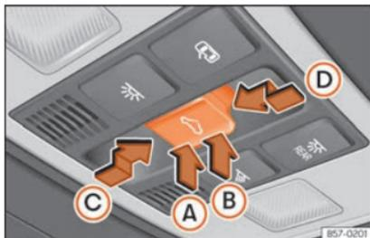
**Fig. 104** No revestimento interior do teto: botão do teto de vidro.
