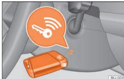
**Fig. 158** À direita da coluna de direção: arranque de emergência.
