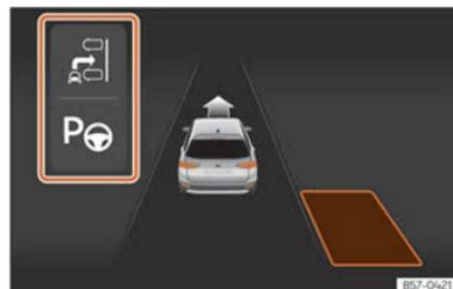
**Fig. 196** No ecrã do painel de instrumentos: visualização do sistema de estacionamento assistido com visualização reduzida.
