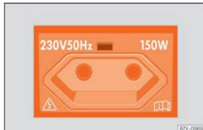
**Fig. 144** No lado esquerdo da bagageira: tomada de corrente de 230 Volts.
