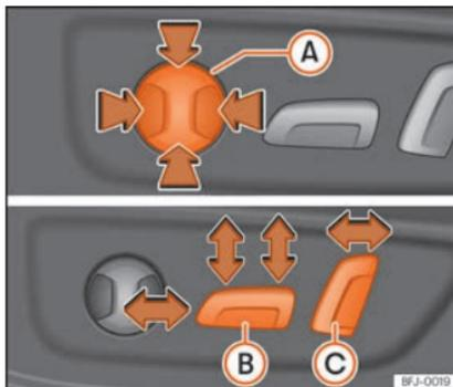
**Fig. 118** Banco do condutor: ajuste elétrico do banco.
