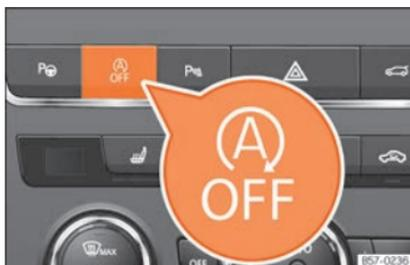
**Fig. 159** Consola central: botão do sistema Start/Stop.
