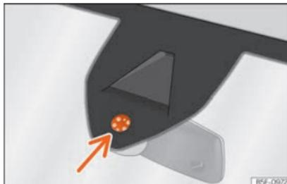
**Fig. 147** Sensor de humidade e temperatura do para-brisas.
