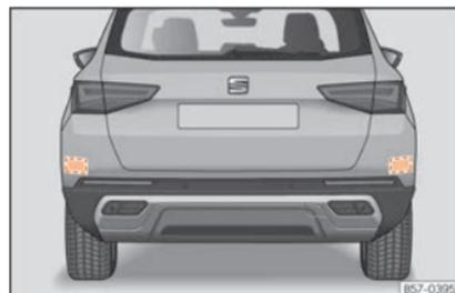
**Fig. 169** Vista traseira do veículo: zonas dos sensores de radar.
