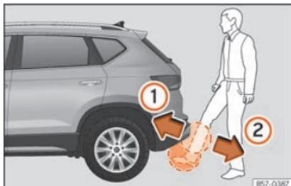
**Fig. 100** Porta da bagageira com abertura controlada por sensor (Easy Open)
