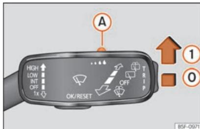
**Fig. 113** Manípulo do limpa-vidros: ajustar o sensor de chuva (A).
