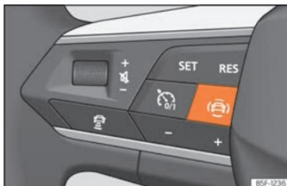
**Fig. 78** Lado esquerdo do volante multifunções: botão para os sistemas de assistência à condução (conforme versão).
