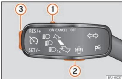
**Fig. 175** No manipulador dos indicadores de mudança de direção: botões para utilizar o limitador de velocidade.
