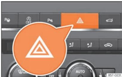
**Fig. 110** Painel de instrumentos: interruptor das luzes de emergência
