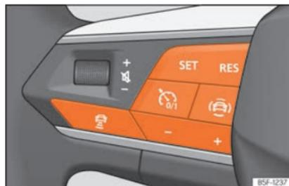
**Fig. 179** No volante multifunções: botões para utilizar o ACC
