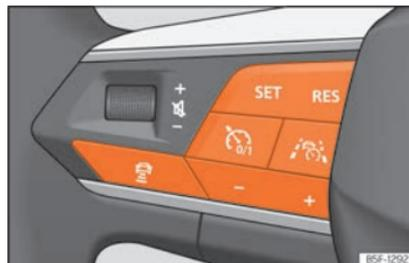
**Fig. 187** Lado esquerdo do volante multifunções: botões para a utilização do Travel Assist.
