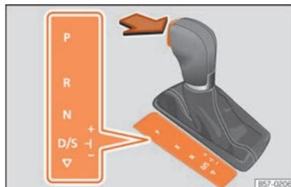
Fig. 161 Bloqueio da alavanca seletora.
