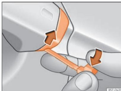
**Fig. 94** Manípulo da porta do condutor: soltar a tampa fazendo alavanca.
