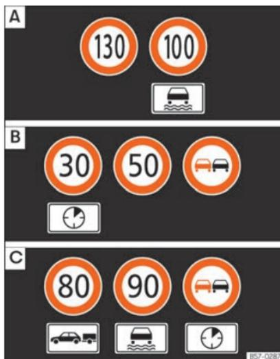
**Fig. 70** No ecrã do painel de instrumentos: exemplos de limites de velocidade ou proibições de ultrapassagem reconhecidos com os respetivos painéis complementares.
