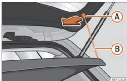
**Fig. 126** Na bagageira: desmontar e montar a chapeleira.
