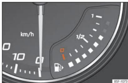
**Fig. 71** Painel de instrumentos analógico: indicador do nível de combustível
