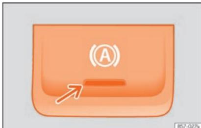
**Fig. 194** Na parte inferior da consola central: tecla da função Auto Hold.
