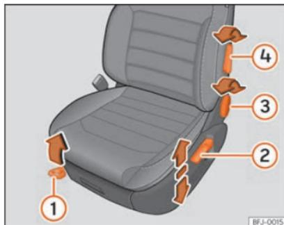
**Fig. 117** Bancos dianteiros: ajuste manual do banco.
