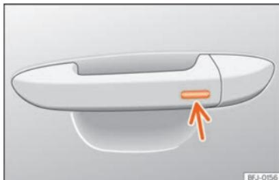
Fig. 106 Manípulo da porta: superfície sensora.
