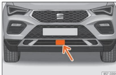
**Fig. 166** No para-choques dianteiro: sensor de radar.
