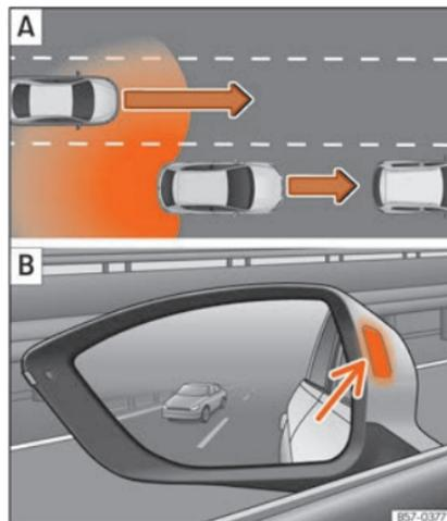
**Fig. 190** Esquema: [A] Situação numa ultrapassagem com trânsito na parte traseira. [B] Indicação do assistente de mudança de faixa no retrovisor exterior esquerdo. »
