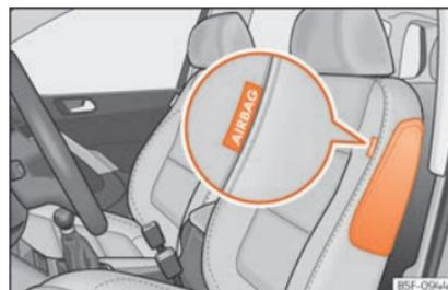
**Fig. 20** Airbag lateral no banco do condutor.
