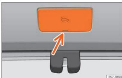
**Fig. 101** Pormenor da bagageira: acesso à destrancagem de emergência.
