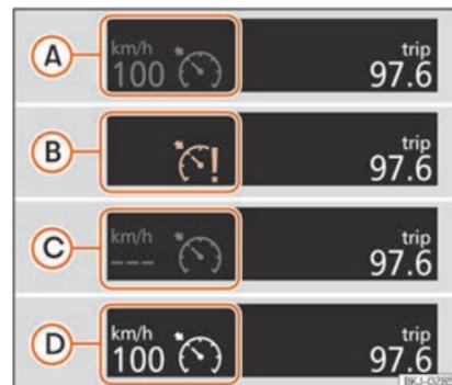
**Fig. 172** Ecrã do painel de instrumentos: indicações do estado do GRA.
