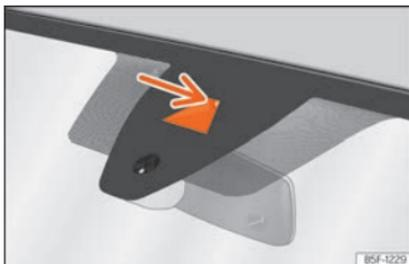
**Fig. 168** No para-brisas: área de campo visual do sistema de aviso de saída da faixa de rodagem.
