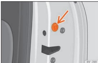
**Fig. 95** Trancagem de emergência da porta.
