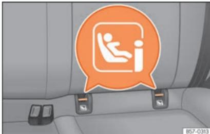
**Fig. 26** Bancos traseiros: anéis de fixação ISO-FIX/i-Size.
