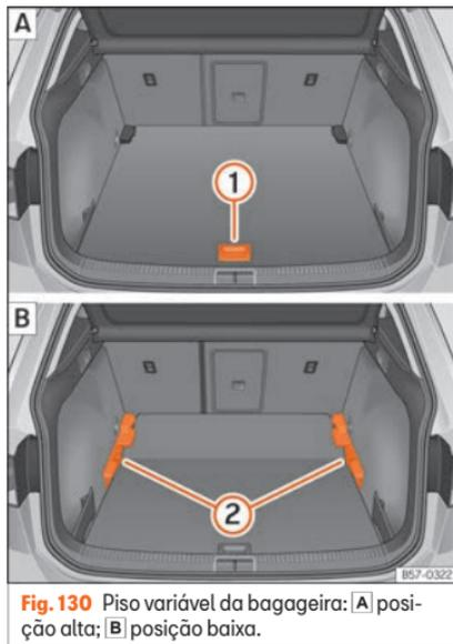
**Fig. 130** Piso variável da bagageira: **A**) posição alta; **B**) posição baixa.
