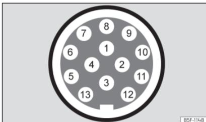
**Fig. 212** Esquema: atribuição dos pinos da tomada de corrente para reboque.
