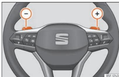
**Fig.163** Volante: alavancas de mudança automática de velocidade.
