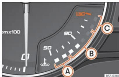
Fig. 73 Painel de instrumentos analógico: indicador da temperatura do líquido de refrigeração do motor
