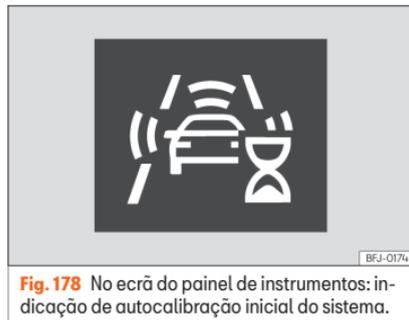
**Fig. 178** No ecrã do painel de instrumentos: indicação de autocalibração inicial do sistema.
