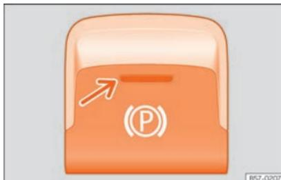
**Fig. 193** Na parte inferior da consola central: tecla do travão de estacionamento eletrónico.
