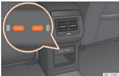
**Fig. 156** Parte posterior consola central: Conectores USB com função de tomada de corrente.
