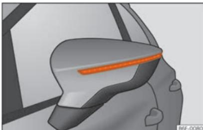
**Fig. 65** Indicador de mudança de direção integrado no espelho retrovisor
