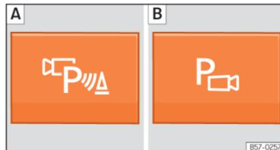
**Fig. 209** Consola central: botão para ativar/desativar manualmente o sistema de visão periférica quando está em combinação com o sistema de estacionamento assistido (A) ou com o sistema Park Pilot traseiro (B).
