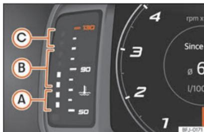
Fig. 74 Painel de instrumentos digital: indicador da temperatura do líquido de refrigeração do motor
