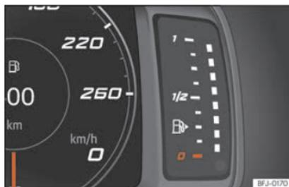
**Fig. 72** Painel de instrumentos digital: indicador do nível de combustível
