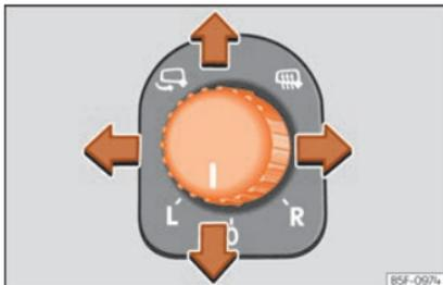
**Fig. 115** Pormenor da porta do condutor: comando do retrovisor exterior.
