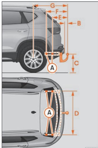
**Fig. 214** Quotas e pontos de fixação para a montagem posterior de um dispositivo de reboque.
