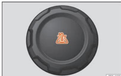
**Fig. 224** Compartimento do motor: tampão do depósito de compensação do líquido de refrigeração.
