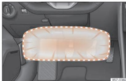
**Fig. 19** No lado do condutor: raio de ação do airbag de joelhos.
