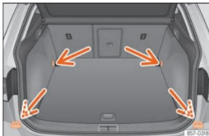
Fig. 132 Na bagageira: argolas de fixação.
