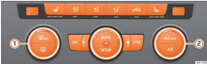
**Fig. 145** Na consola central: comandos do Climatronic.
