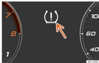
**Fig. 230** Painel de instrumentos: aviso de perda de pressão dos pneus.
