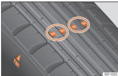
**Fig. 228** Perfil do pneu: indicadores de desgaste.
