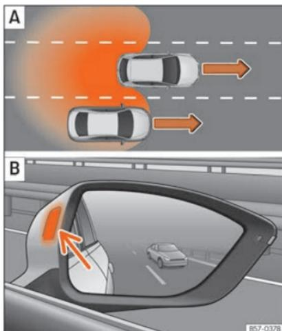
**Fig. 191** Esquema: **A**) Situação numa ultrapassagem e incorporação posterior na via de circulação direita. **B**) Indicação do assistente de mudança de faixa no retrovisor exterior direito.
