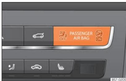
**Fig. 17** Painel de instrumentos: luz de controlo da desativação do airbag do passageiro.
