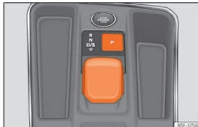
Fig. 167 Na consola central: comando seletor.
