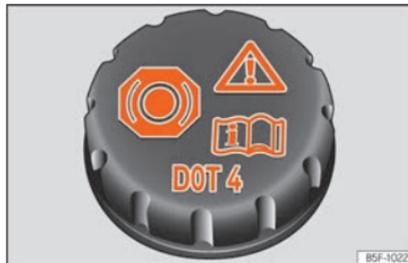
**Fig. 235** Compartimento do motor: tampão do depósito do líquido dos travões.
