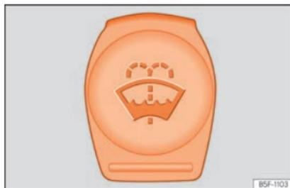
**Fig. 236** No compartimento do motor: tampão do reservatório do limpa-vidros.
