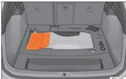
**Fig. 237** Veículos híbridos (PHEV): localização da bateria na bagageira
