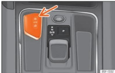
Fig. 82 Consola central: alojamento para a chave do veículo.
