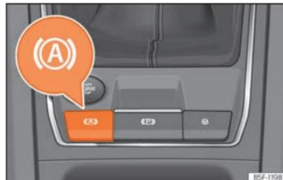
Fig. 197 Na parte inferior da consola central: tecla da função Auto Hold.
