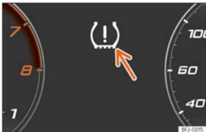
**Fig. 243** Painel de instrumentos: aviso de perda de pressão dos pneus.
