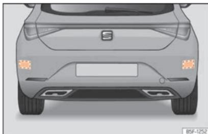
Fig. 172 Vista traseira do veículo: zonas dos sensores de radar.
