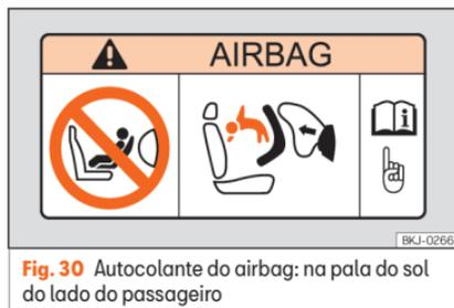
**Fig. 30** Autocolante do airbag: na pala do lado do passageiro
