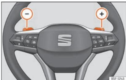
**Fig. 168** Volante: alavancas de mudança automática de velocidade.
