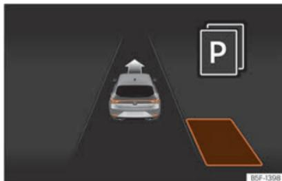
**Fig. 198** No ecrã do painel de instrumentos: visualização do sistema de estacionamento assistido com visualização reduzida.
