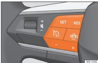
**Fig. 175** No volante multifunções: botões para utilizar o regulador de velocidade
