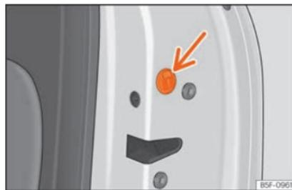
**Fig. 91** Trancagem de emergência da porta.
