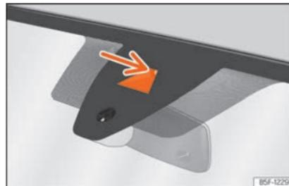
**Fig. 171** No para-brisas: área de campo visual do sistema de aviso de saída da faixa de rodagem.
