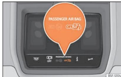
Fig. 21 Na consola do tejadilho: luz de controlo da desativação do airbag do passageiro.
