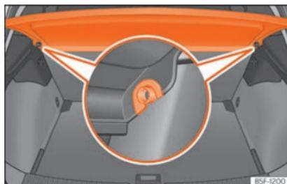
**Fig. 123** Na bagageira: desmontar e montar a chapeleira.
