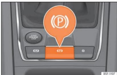
**Fig. 196** Na parte inferior da consola central: tecla do travão de estacionamento eletrónico.
