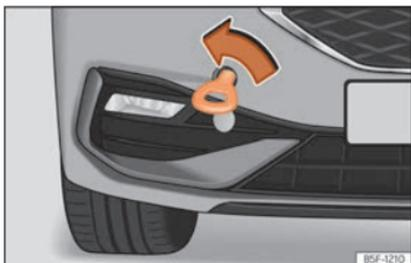
**Fig. 52** Parte direita do para-choques dianteiro: argola de reboque enroscada.
