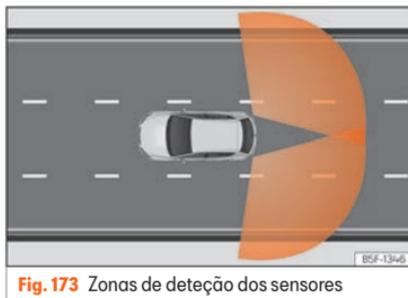
Fig. 173 Zonas de deteção dos sensores
