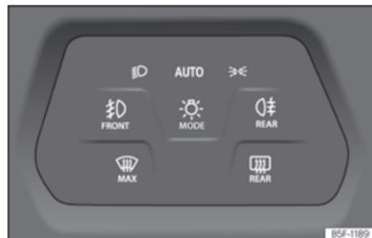
**Fig. 102** Painel de instrumentos: comando das luzes.
