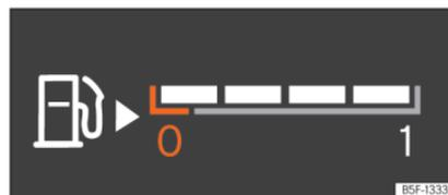
**Fig. 68** Painel de instrumentos digital: indicador do nível de combustível localizado em diferentes posições em função da vista.
