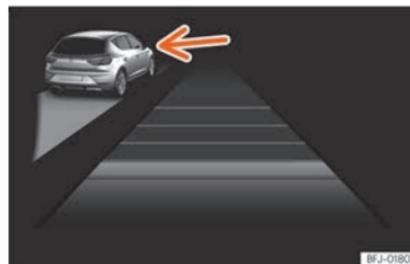
**Fig. 182** No ecrã do painel de instrumentos: ACC ativo, veículo detetado pela esquerda
