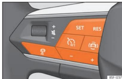
**Fig. 180** No volante multifunções: botões para utilizar o ACC
