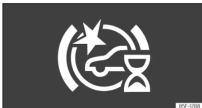
**Fig. 178** No ecrã do painel de instrumentos: indicação de autocalibração inicial do sistema.
