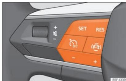
**Fig. 176** No volante multifunções: botões para utilizar o limitador de velocidade
