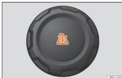
**Fig. 234** Compartimento do motor: tampão do depósito de compensação do líquido de refrigeração.
