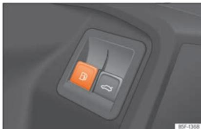
**Fig. 220** Porta do condutor: desbloqueio da tampa do depósito
