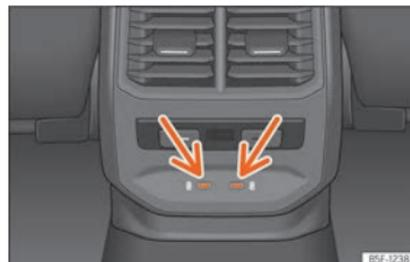
Fig. 162 Parte posterior consola central: Conectores USB com função de tomada de corrente.
