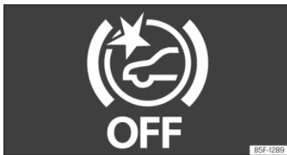
**Fig. 179** No ecrã do painel de instrumentos: indicação de Front Assist desativado.
