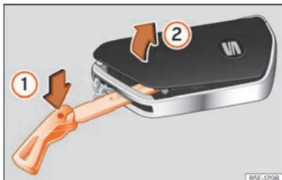
**Fig. 84** Chave do veículo: abrir a tampa do compartimento da pilha.
