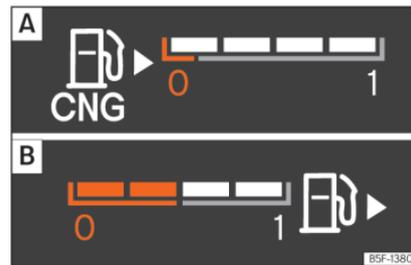
**Fig. 69** Painel de instrumentos digital: **A**: Indicador do nível de gás natural. **B**: Indicador do nível de gasolina
