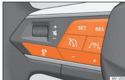
**Fig. 188** Lado esquerdo do volante multifunções: botões para a utilização do Travel Assist.
