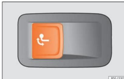
**Fig. 207** No lado esquerdo da bagageira: botão para desbloquear o gancho de reboque.
