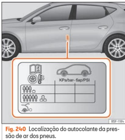
**Fig. 240** Localização do autocolante da pressão de ar dos pneus.
