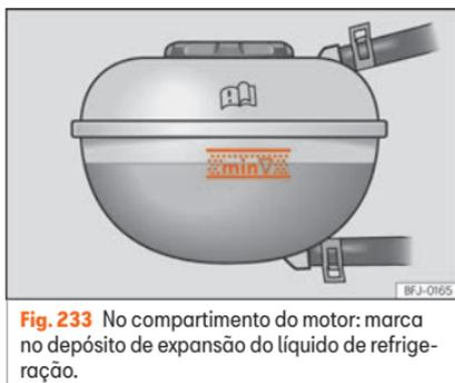
**Fig. 233** No compartimento do motor: marca no depósito de expansão do líquido de refrigeração.
