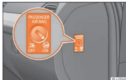
Fig. 20 Comutador com chave para ativar e desativar o airbag do passageiro.
