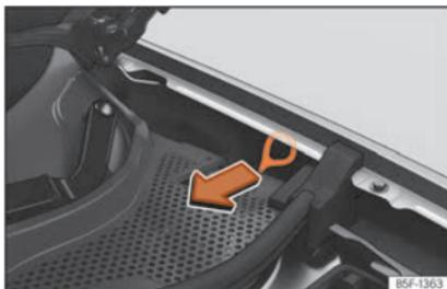
**Fig. 216** Entre a lateral esquerda e a dobradiça do capô do motor: Puxador para o desbloqueio manual de emergência do conector de carregamento.
