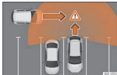
**Fig. 193** Representação esquemática do assistente de saída do estacionamento: zona vigiada ao redor do veículo que está a sair do estacionamento.
