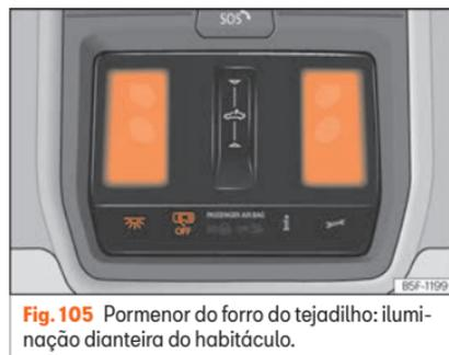
Fig. 105 Pormenor do forro do tejadilho: iluminação dianteira do habitáculo.
