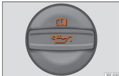
**Fig. 231** Tampão do bocal de enchimento do óleo do motor no compartimento do motor.
