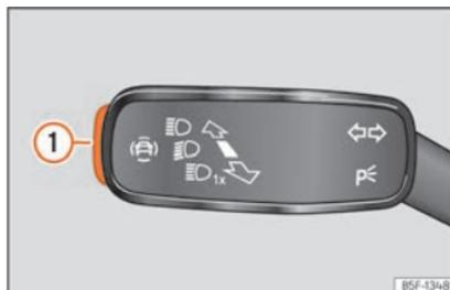
**Fig. 72** No manípulo dos indicadores de mudança de direção e dos máximos: botão para os sistemas de assistência à condução (conforme versão).
