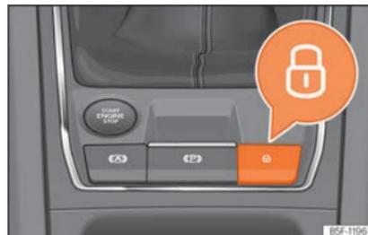
**Fig. 87** Na consola central: interruptor do fecho centralizado
