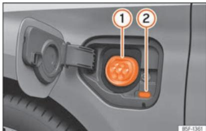
**Fig. 213** Por trás da tampa de carregamento da bateria na parte dianteira esquerda: Tomada de carregamento
