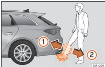
**Fig. 96** Porta da bagageira com abertura controlada por sensor (Easy Open)
