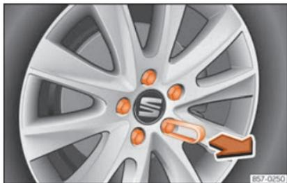
**Fig. 41** Roda: parafusos da roda com protetores.
