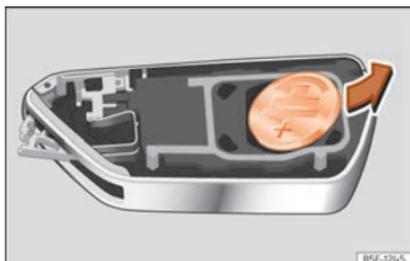
**Fig. 85** Chave do veículo: extração da pilha.
