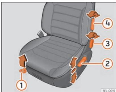
**Fig. 112** Bancos dianteiros: ajuste manual do banco.
