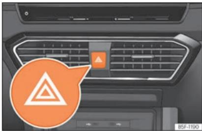
**Fig. 104** Painel de instrumentos: interruptor das luzes de emergência
