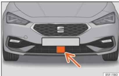
**Fig. 169** No para-choques dianteiro: sensor de radar.
