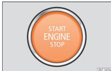
Fig. 239 Na parte inferior da consola central: botão de arranque.
