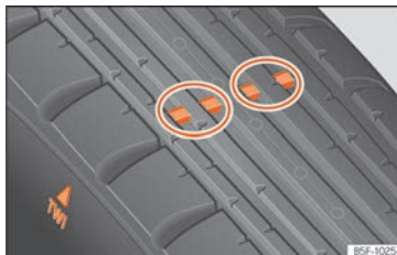
Fig. 318 Perfil do pneu: indicadores de desgaste.
