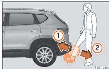
Fig. 103 Porta da bagageira com abertura controlada por sensor (Easy Open)
