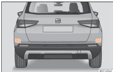
Fig. 275 Vista traseira do veículo: zonas dos sensores de radar.
