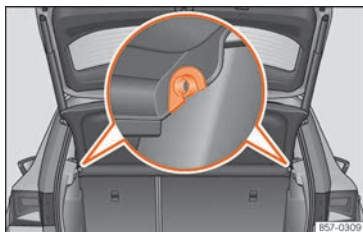
Fig. 133 Na bagageira: desmontar e montar a bandeja.
