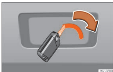
Fig. 105 Pormenor da bagageira: destrancagem de emergência.
