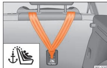
Fig. 31 Parte posterior dos bancos traseiros: argolas de fixação para o cinto Top Tether.
