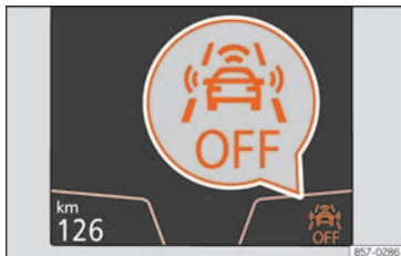
Fig. 258 No ecrã do painel de instrumentos: indicação de Front Assist desativado.
