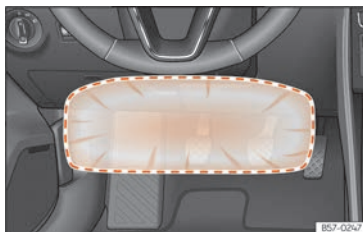
Fig. 20 No lado do condutor: raio de ação do airbag de joelhos.
