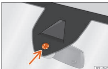
Fig. 120 Superfície sensível do sensor de chuva.
