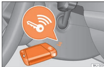
Fig. 240 À direita da coluna de direção: arranque de emergência.
