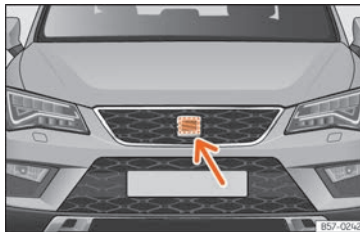
Fig. 257 Na parte frontal após o emblema da SEAT: sensor de radar.
