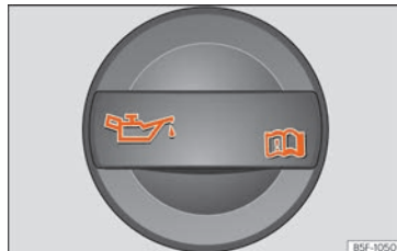
Fig. 312 Tampão do bocal de enchimento do óleo do motor no compartimento do motor.
