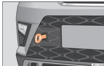
Fig. 48 No lado direito do para-choques dianteiro: argola de reboque enroscada.
