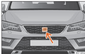
Fig. 263 Na parte frontal após o emblema da SEAT: sensor de radar.
