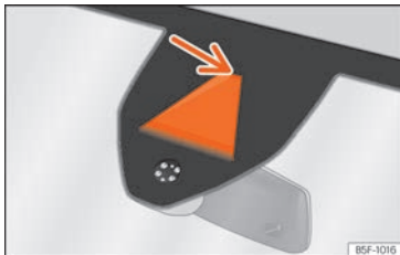
Fig. 269 No para-brisas: área de campo visual do sistema de aviso de saída da faixa de rodagem.
