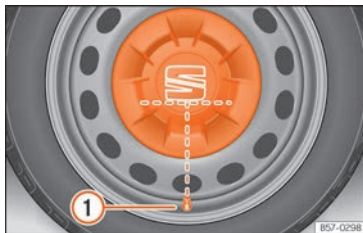
Fig. 35 Colocação correta do embelezador central da roda para jantes de aço.
