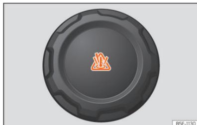
**Fig. 179** Compartimento dianteiro: tampão do depósito de expansão do líquido de refrigeração.
