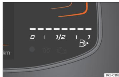
**Fig. 5** Painel de instrumentos Basic: indicador do nível de combustível.
