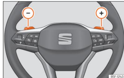
**Fig. 89** Volante: alavancas para mudança automática de velocidades.
