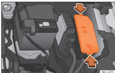
**Fig. 167** No compartimento do motor: tampa da caixa de fusíveis.
