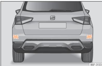
**Fig. 97** Vista traseira do veículo: zonas dos sensores de radar.
