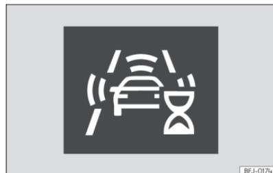
**Fig. 108** No ecrã do painel de instrumentos: indicação de autocalibração inicial do sistema.
