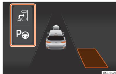
**Fig. 123** No ecrã do painel de instrumentos: visualização do sistema de estacionamento assistido com visualização reduzida.
