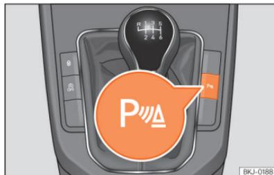
**Fig. 119** Consola central: botão do auxílio de estacionamento [consoante as versões].
