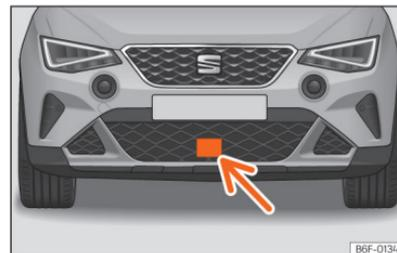
**Fig. 94** No para-choques dianteiro: sensor de radar.
