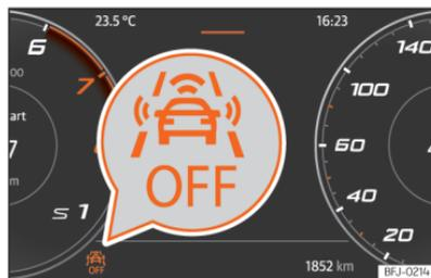
**Fig. 109** No ecrã do painel de instrumentos: indicação de Front Assist desativado.
