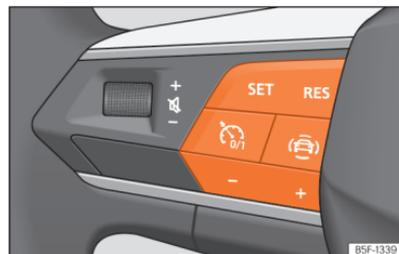
**Fig. 100** No volante multifunções: botões para utilizar o regulador de velocidade.
