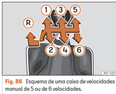
**Fig. 86** Esquema de uma caixa de velocidades manual de 5 ou 6 velocidades.
