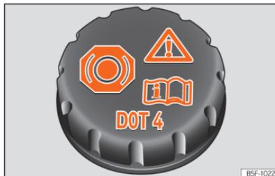
**Fig. 180** Compartimento do motor: tampa do depósito do líquido dos travões.
