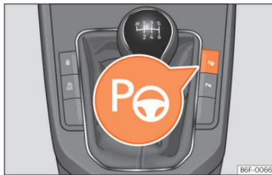
**Fig. 122** Na consola central: botão para ligar o sistema de estacionamento assistido.
