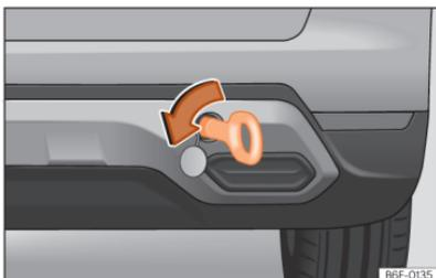
**Fig. 165** No lado direito do para-choques traseiro: argola de reboque enroscada.
