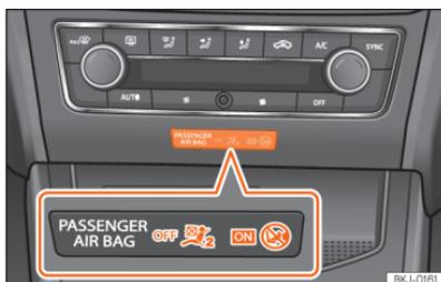
**Fig. 30** Parte central do painel de instrumentos: luz de controlo da desativação do airbag do passageiro.
