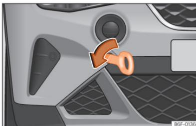
**Fig. 163** Parte direita do para-choques dianteiro: argola de reboque enroscada.
