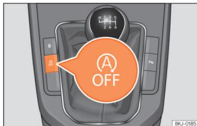
**Fig. 85** Consola central: botão do sistema Start-Stop.
