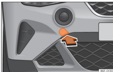
**Fig. 162** No lado direito do para-choques dianteiro: retirar a tampa.
