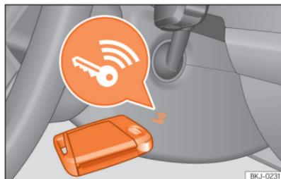
**Fig. 84** À direita da coluna de direção: arranque de emergência.
