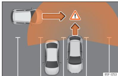
**Fig. 129** Representação esquemática do assistente de saída do estacionamento: zona vigiada ao redor do veículo que está a sair do estacionamento.
