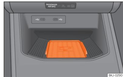
**Fig. 141** Na consola central: alojamento para a ligação do telemóvel.
