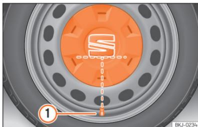
**Fig. 191** Colocação correta do tampão central da roda para jantes de aço.
