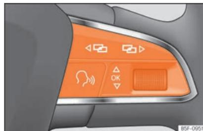
**Fig. 81** Volante multifunções: botões para utilizar os menus do painel de instrumentos.
