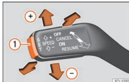
Fig. 251 À esquerda da coluna de direção: terceira alavanca para utilizar o GRA.
