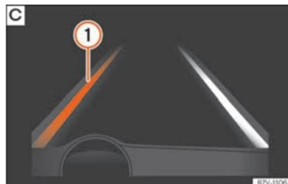
**Fig. 261** No ecrã do painel de instrumentos: Indicação no ecrã do sistema de aviso de saída da faixa de rodagem (exemplo 2).
