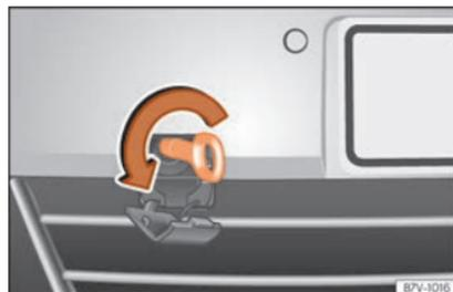
**Fig. 56** Na parte direita do para-choques dianteiro: enroskar a argola de reboque.
