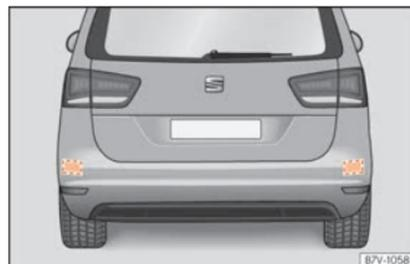
**Fig. 247** Vista traseira do veículo: zonas dos sensores de radar.
