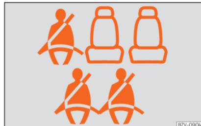
**Fig. 6** Exemplo de indicação do estado do cinto nos lugares traseiros (aqui, num veículo de 7 lugares) no painel de instrumentos: por cima, a segunda fila; por baixo, a terceira fila de bancos.
