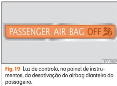
**Fig. 19** Luz de controlo, no painel de instrumentos, da desativação do airbag dianteiro do passageiro.
