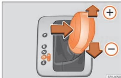
**Fig. 239** Alavanca seletora na posição Tiptronic (veículos com volante à esquerda). Os veículos com o volante à direita estão dispostos de forma simétrica.
