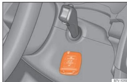
**Fig. 235** Arranque de emergência em veículos com Keyless Access.
