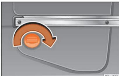
**Fig. 283** Na parte traseira esquerda da bagageira: depósito de AdBlue, atrás de uma cobertura.
