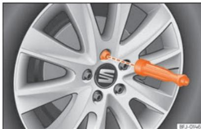
**Fig. 49** Substituição da roda: desenroskar os parafusos de roda com o cabo da chave de parafusos.
