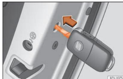
**Fig. 97** Trancagem de emergência do veículo com a chave do veículo.
