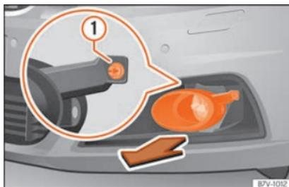
**Fig. 66** Na parte direita do para-choques dianteiro: desmontagem dos faróis.
