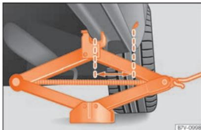
Fig. 48 Macaco colocado na parte traseira esquerda do veículo.
