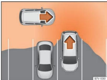
**Fig. 265** Representação esquemática do assistente de saída de estacionamento: zona vigiada ao redor do veículo que está a sair do estacionamento.
