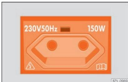
**Fig. 172** Pormenor da consola central traseira: tomada de corrente europeia de 230 Volts.
