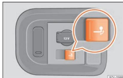
Fig. 279 No lado direito da bagageira: botão para desbloquear o gancho de reboque.
