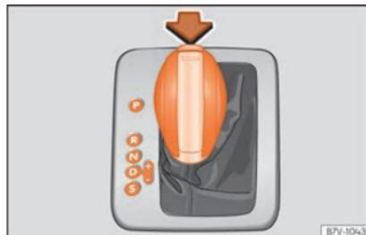
**Fig. 238** Alavanca seletora da caixa automática com botão de bloqueio (seta).
