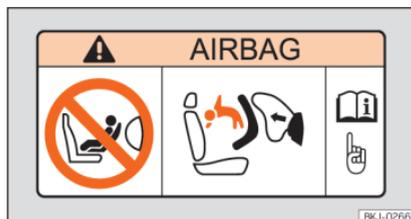
**Fig. 27** Autocolante do airbag: na pala do sol do lado do passageiro
