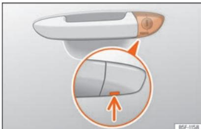
**Fig. 94** Manipulo da porta do condutor: canhão da fechadura oculto.
