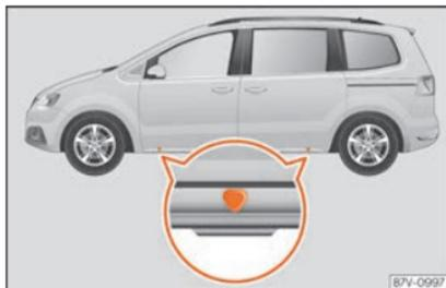
Fig. 47 Pontos de apoio do macaco.
