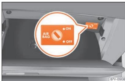
**Fig. 18** No porta-luvas, no lado do passageiro: interruptor de chave para ativar e desativar o airbag dianteiro do passageiro.
