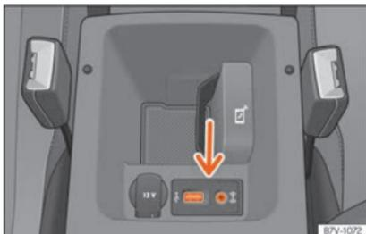
**Fig. 185** Apoio de braços central dianteiro: entrada USB/AUX-IN.
