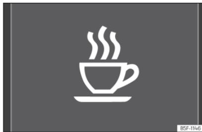
**Fig. 76** No ecrã do painel de instrumentos: símbolo de deteção de fadiga.
