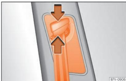
**Fig. 15** Junto aos bancos dianteiros: regular a altura do cinto.
