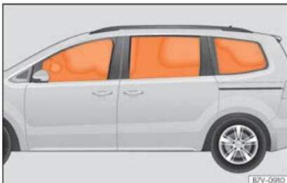
**Fig. 25** Airbags da cabeça insuflados.
