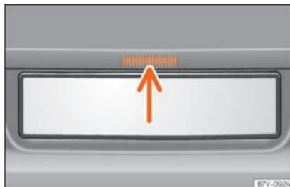
**Fig. 105** Abertura da porta da bagageira a partir do exterior.
