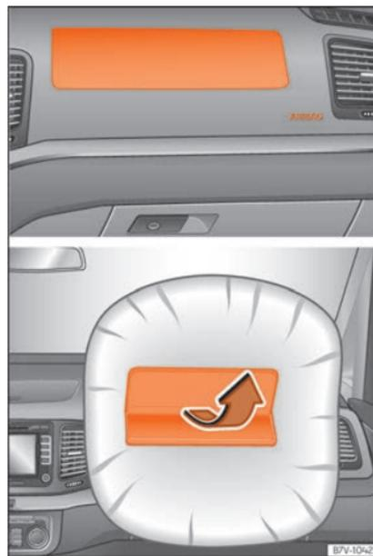
**Fig. 17** Airbag do passageiro no painel de instrumentos.
