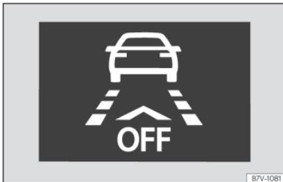
**Fig. 253** No ecrã do painel de instrumentos: indicação de Front Assist desativado.
