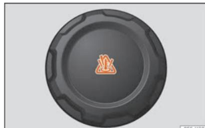
**Fig. 293** Compartimento do motor: tampão do depósito de compensação do líquido de refrigeração.
