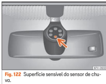
**Fig. 122** Superfície sensível do sensor de chuva.
