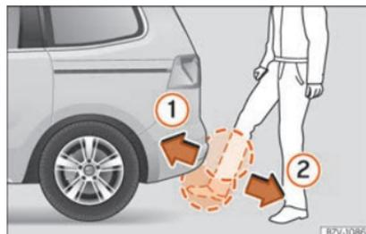
Fig. 106 Porta da bagageira com abertura controlada por sensor (Easy Open)
