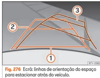
**Fig. 276** Ecrã: linhas de orientação do espaço para estacionar atrás do veículo.
