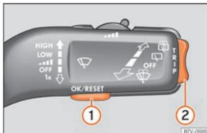
**Fig. 82** Manipulô do limpador para-brisas: botões para utilizar os menus do painel de instrumentos.
