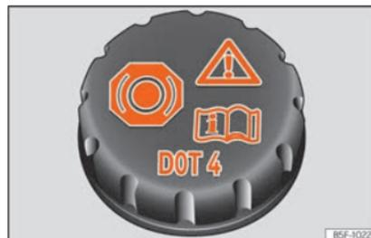
Fig. 294 Compartimento do motor: tampão do depósito do líquido dos travões.
