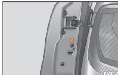
**Fig. 96** Na parte frontal da porta de correr: trancagem de emergência, oculta por uma junta de borracha.
