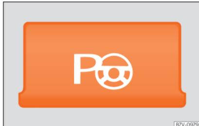
**Fig. 269** Pormenor da consola central: botão para ativar manualmente o sistema de assistência ao volante para estacionar.
