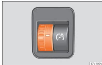
**Fig. 119** Ao lado do volante: regulador da iluminação dos instrumentos e dos comandos
