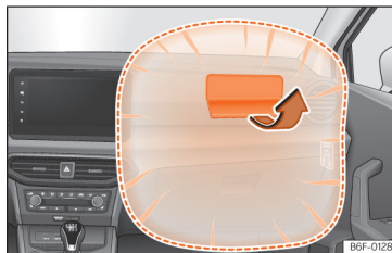
Fig. 28 Airbag do passageiro no painel de instrumentos.
