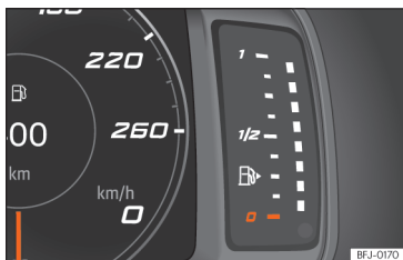
Fig. 6 Painel de instrumentos SEAT Digital Cockpit: indicador do nível de combustível.
