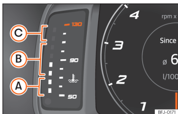
Fig. 8 Painel de instrumentos SEAT Digital Cockpit: indicador da temperatura do líquido de refrigeração do motor.
