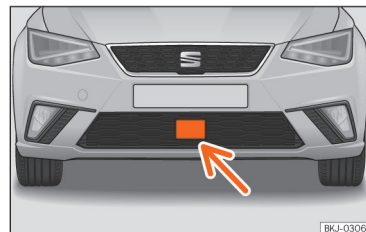
Fig. 96 No para-choques dianteiro: sensor de radar.
