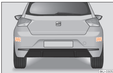
Fig. 99 Vista traseira do veículo: zonas dos sensores de radar.
