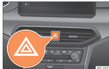
Fig. 43 Painel de instrumentos: interruptor das luzes de emergência.
