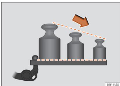
**Fig. 211** Distribuição recomendada do peso no sistema de carga traseiro.
