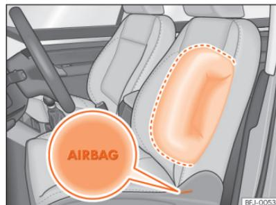
Fig. 34 Airbag lateral no banco do condutor.
