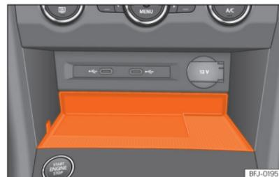
**Fig. 192** Na consola central: alojamento para a ligação do telemóvel.
