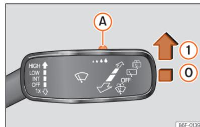
**Fig. 108** Manipulo do limpa para-brisas: ajustar o sensor de chuva (A).
