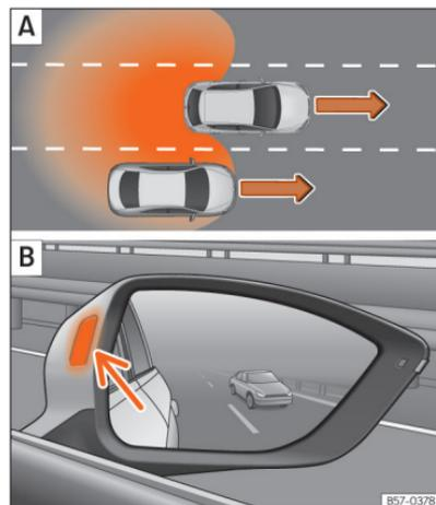
**Fig. 153** Esquema: **A** Ultrapassagem na faixa de rodagem central e incorporação posterior na faixa de rodagem direita. **B** Indicação do assistente de mudança de faixa no lado direito.
