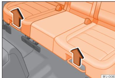
**Fig. 91** Por baixo do assento do banco traseiro: alavancas de ajuste.
