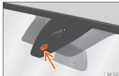
**Fig. 109** Superfície sensível do sensor de chuva.
