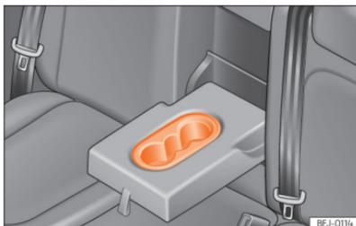
**Fig. 179** No apoio de braços central traseiro: suporte de bebidas.
