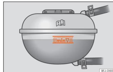
**Fig. 235** No compartimento dianteiro: marca no depósito de expansão do líquido de refrigeração.
