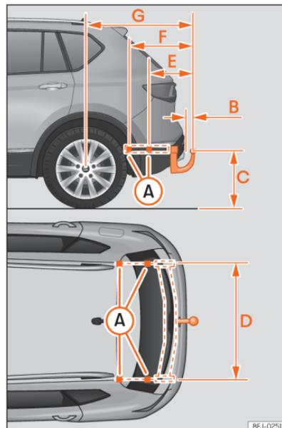
**Fig. 213** Quotas e pontos de fixação para a montagem posterior de um dispositivo de reboque.
