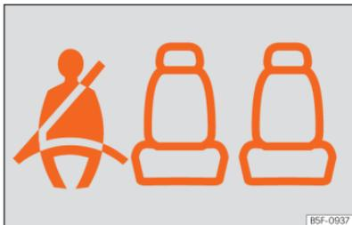
**Fig. 22** Painel de instrumentos: indicação do estado dos cintos de segurança dos lugares traseiros.
