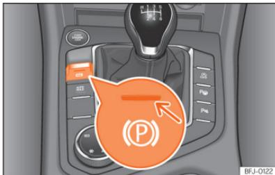
**Fig. 154** Na parte inferior da consola central: botão do travão de estacionamento eletrônico.
