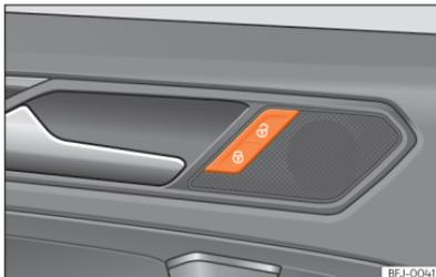
**Fig. 70** Na porta do condutor: interruptor do fecho centralizado.
