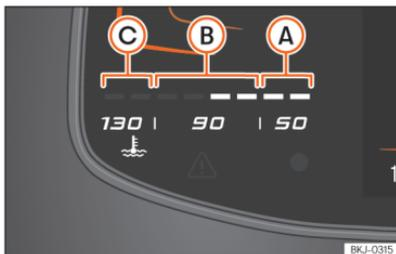
**Fig. 9** Painel de instrumentos Basic: indicador da temperatura do líquido de refrigeração do motor.
