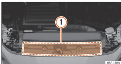
**Fig. 240** No compartimento do motor: zona de localização da etiqueta de óleo do motor
