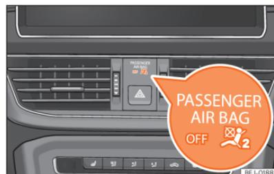
**Fig. 33** Painel de instrumentos: luz de controlo da desativação do airbag do passageiro.
