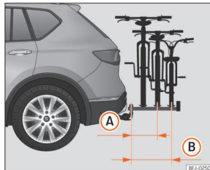
**Fig. 212** Representação esquemática da saliência máxima da carga num porta-bicicletas para duas ou três bicicletas.
