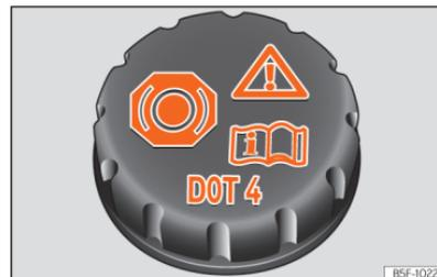
Fig. 237 Compartimento do motor: tampa do depósito do líquido dos travões.
