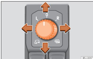
**Fig. 110** Pormenor da porta do condutor: comando do espelho retrovisor exterior.
