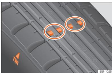
**Fig. 246** Perfil do pneu: indicadores de desgaste.
