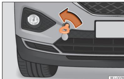
**Fig. 225** Parte direita do para-choques dianteiro: argola de reboque enroscada.
