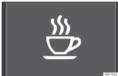
**Fig. 12** No ecrã do painel de instrumentos: símbolo de deteção de fadiga.
