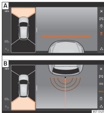
**Fig. 171** Visualização no ecrã do sistema de visão periférica: **A** Câmara dianteira: vista todo-o-terreno. **B** Câmara traseira: vista todo-o-terreno.
