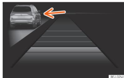
**Fig. 141** No ecrã do painel de instrumentos: ACC ativo, veículo detetado pela esquerda.
