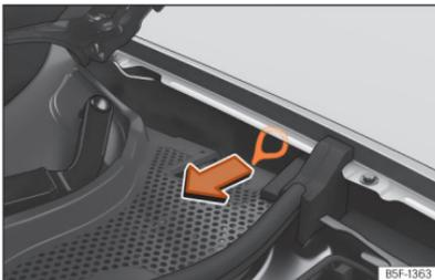
**Fig. 58** Entre a lateral esquerda e a dobradiça do capô do motor Puxador para o desbloqueio manual de emergência do conector de carregamento.
