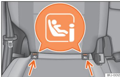
**Fig. 41** Banco traseiro: localização dos anéis de fixação ISOFIX ou i-Size.
