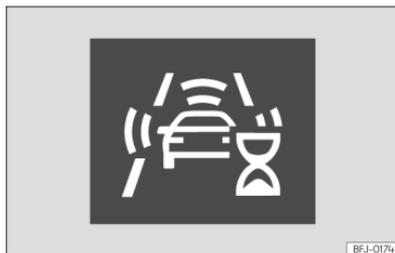
**Fig. 145** No ecrã do painel de instrumentos: indicação de autocalibração inicial do sistema.
