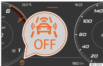
**Fig. 146** No ecrã do painel de instrumentos: indicação de Front Assist desativado.
