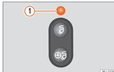
**Fig. 56** Por trás da tampa da tomada de carregamento da bateria: indicador do processo de carregamento.
