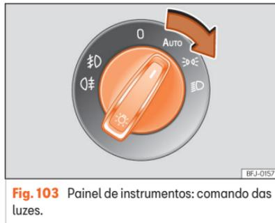
**Fig. 103** Painel de instrumentos: comando das luzes.
