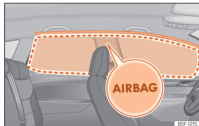
**Fig. 35** Localização e raio de alcance do airbag da cabeça.
