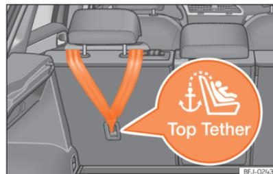
**Fig. 46** Parte posterior dos bancos traseiros da segunda fila: argolas de fixação para o cinto Top Tether.
