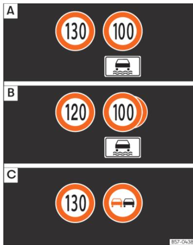
**Fig. 13** No ecrã do painel de instrumentos: exemplos de limites de velocidade ou proibições de ultrapassagem reconhecidos com os respetivos painéis complementares.
