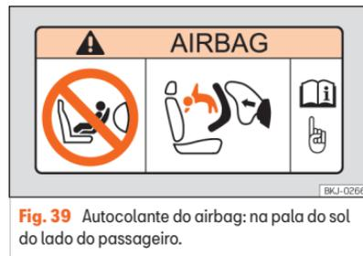
**Fig. 39** Autocolante do airbag: na pala do sol do lado do passageiro.
