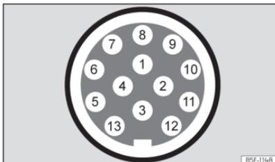
**Fig. 209** Representação esquemática: atribuição dos pinos da tomada de corrente para reboque.
