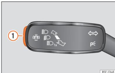
**Fig. 129** Na alavanca das luzes indicadoras de mudança de direção e dos máximos: botão dos sistemas de assistência ao condutor (conforme versões).
