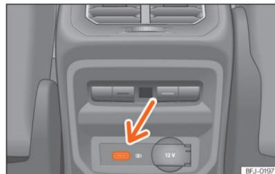
Fig. 185 Parte posterior consola central: conectores USB com função de tomada de corrente.
