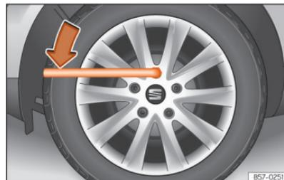
**Fig. 252** Troca de roda: desapertar os parafusos de roda.
