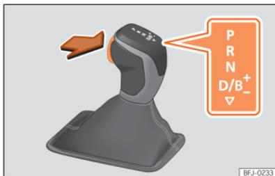
**Fig. 124** Bloqueio da alavanca seletora (veículos híbridos).
