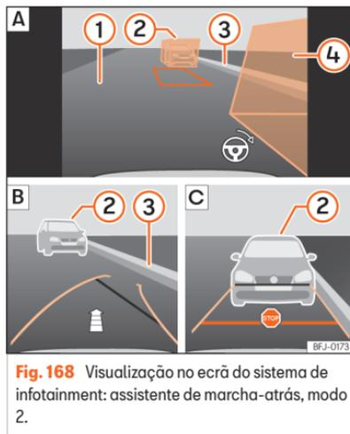
**Fig. 168** Visualização no ecrã do sistema de infotainment: assistente de marcha-atrás, modo 2.
