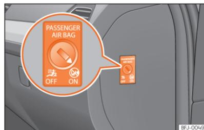
**Fig. 32** Comutador com chave para ativar e desativar o airbag do passageiro.
