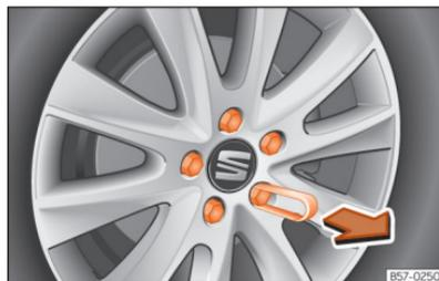
Fig. 250 Roda: parafusos de roda com protetores.
