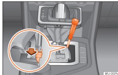
**Fig. 126** Alavanca seletora: desbloqueio de emergência na posição de estacionamento.
