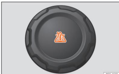
**Fig. 236** Compartimento dianteiro: tampão do depósito de expansão do líquido de refrigeração.
