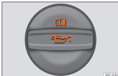
**Fig. 242** Tampa do bocal de enchimento do óleo do motor no compartimento do motor.
