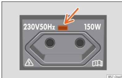
**Fig. 183** No lado esquerdo da bagageira: tomada de corrente de 230 volts.
