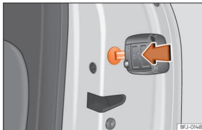
**Fig. 73** Trancagem de emergência da porta.
