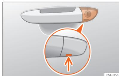
**Fig. 71** Manípulo da porta do condutor: canhão da fechadura oculto.
