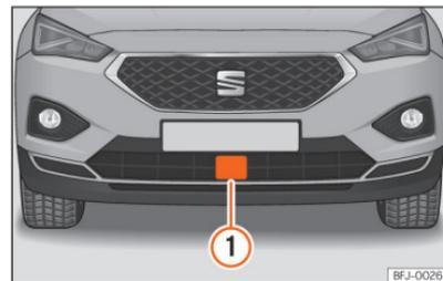
**Fig. 131** No para-choques dianteiro: sensor de radar.
