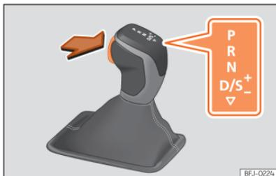
**Fig. 123** Bloqueio da alavanca seletora.
