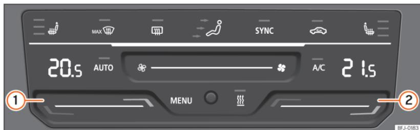
**Fig. 112** Na consola central: comandos do Climatronic.
