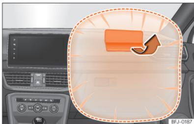
**Fig. 31** Airbag do passageiro no painel de instrumentos.
