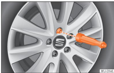
**Fig. 256** Substituição da roda: desapertar os parafusos da roda com o punho da chave de parafusos.
