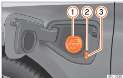
**Fig. 55** Por trás da tampa de carregamento da bateria na parte dianteira esquerda: Tomada de carregamento.
