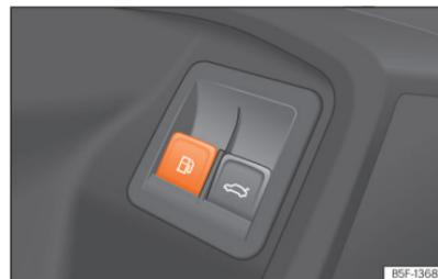
**Fig. 215** Porta do condutor: desbloqueio da tampa do depósito.
