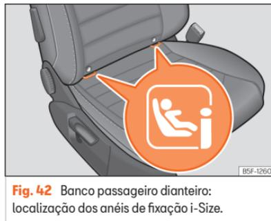
**Fig. 42** Banco passageiro dianteiro: localização dos anéis de fixação i-Size.
