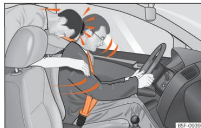
**Fig. 24** O passageiro do banco traseiro que não tiver colocado o cinto de segurança é projetado para a frente, para cima do condutor que tem o cinto colocado.
