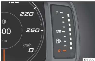
**Fig. 7** Painel de instrumentos SEAT Digital Cockpit: indicador do nível de combustível.
