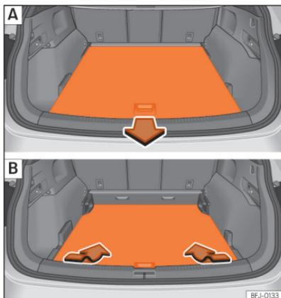
**Fig. 199** Na bagageira: ajustar em altura o piso variável da bagageira.
