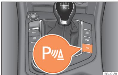
**Fig. 158** Consola central: botão do auxílio de estacionamento [consoante as versões].
