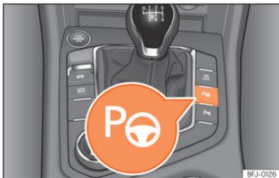
**Fig. 161** Na consola central: botão para ligar o sistema de estacionamento assistido.
