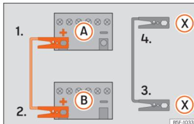
**Fig. 223** Esquema de ligação para veículos com sistema Start/Stop.
