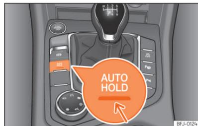
**Fig. 155** Na parte inferior da consola central: botão da função Auto Hold.
