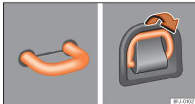
Fig. 204 Na bagageira: argola de fixação.
