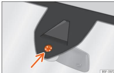
**Fig. 115** Sensor de humidade e temperatura do para-brisas.
