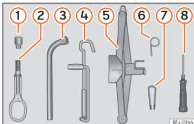
**Fig. 218** Na bagageira, debaixo da cobertura da superfície de carga: ferramentas de bordo.
