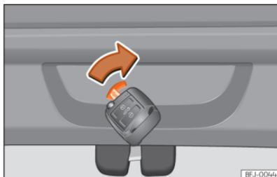
**Fig. 79** Pormenor da bagageira: destrancagem de emergência.
