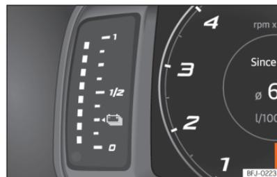
**Fig. 8** Painel de instrumentos: indicador do nível de bateria.
