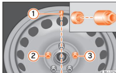
**Fig. 253** Troca de roda: válvula do pneu ① e local de montagem do parafuso da roda antirroubo ② ou ③.
