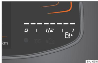
**Fig. 6** Painel de instrumentos Basic: indicador do nível de combustível.
