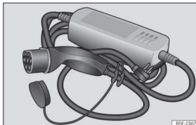
**Fig. 61** Cabo de carregamento para tomadas de corrente.
