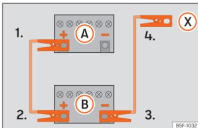
**Fig. 222** Esquema de ligação para veículos sem sistema Start/Stop.
