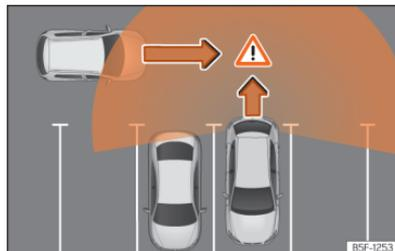
**Fig. 174** Representação esquemática do assistente de saída do estacionamento: zona vigiada ao redor do veículo que está a sair do estacionamento.
