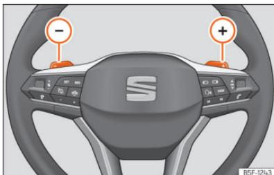
**Fig. 125** Volante: alavancas para mudança automática de velocidades.
