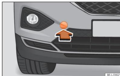
**Fig. 224** No lado direito do para-choques dianteiro: retirar a tampa.
