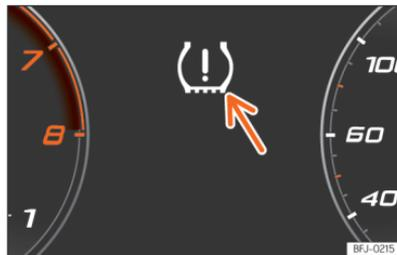
**Fig. 257** Painel de instrumentos: aviso de perda de pressão dos pneus.
