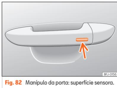
**Fig. 82** Manípulo da porta: superfície sensora.
