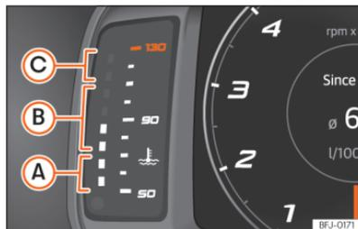
**Fig. 10** Painel de instrumentos SEAT Digital Cockpit: indicador da temperatura do líquido de refrigeração do motor.
