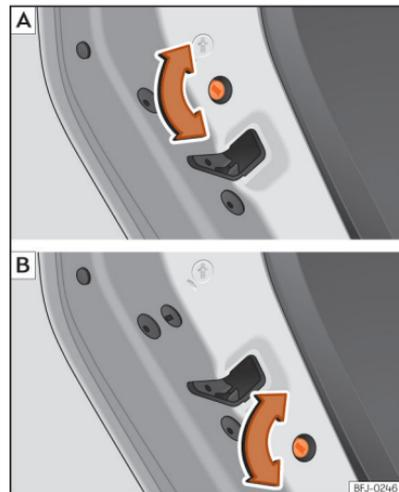
**Fig. 74** Sistema de segurança para crianças da porta esquerda (simétrico na porta direita). Em função da versão ou do país, o veículo está equipado com a variante **A** ou a variante **B**.
