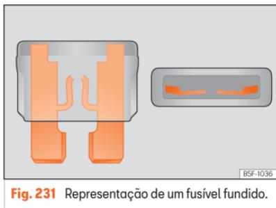
**Fig. 231** Representação de um fusível fundido.
