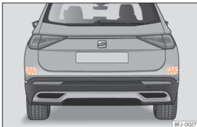
**Fig. 134** Vista traseira do veículo: zonas dos sensores de radar.
