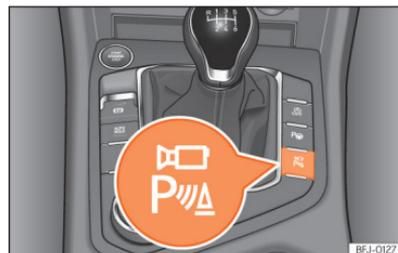
**Fig. 170** Consola central: botão para ativar/desativar manualmente o sistema de visão periférica quando está em combinação com o sistema de estacionamento assistido.
