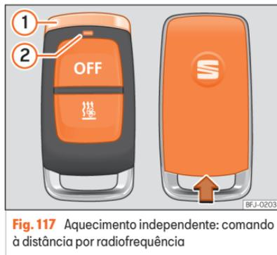
**Fig. 117** Aquecimento independente: comando à distância por radiofrequência
