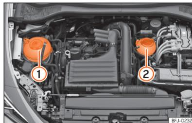
**Fig. 234** Compartimento do motor: Depósitos do líquido de refrigeração
